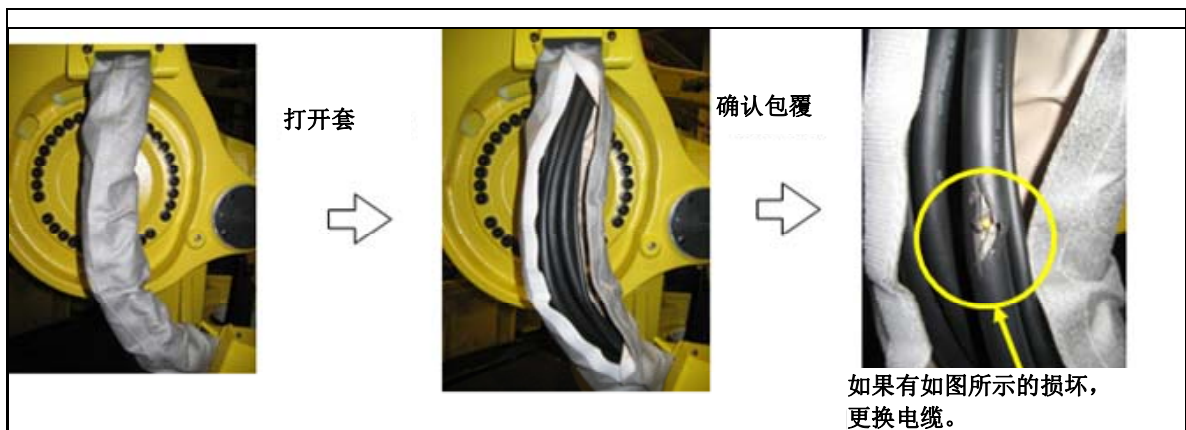
图 7.2.3 (c) 电缆的确认方法
