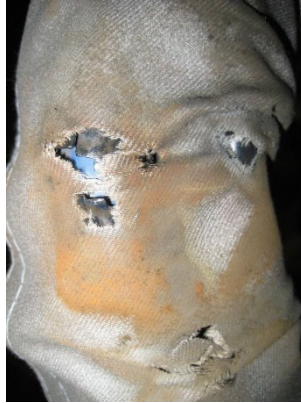
图 7.2.3 (b) 电缆保护套的损坏
