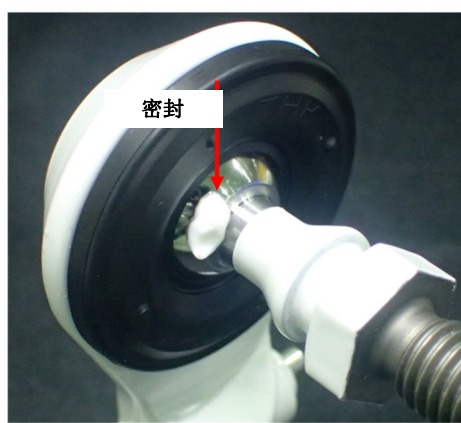
图 6.3.3 (b) 涂上润滑脂之后的状态
