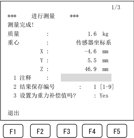
图 6.3.1 工具质量和重心的计算结果
