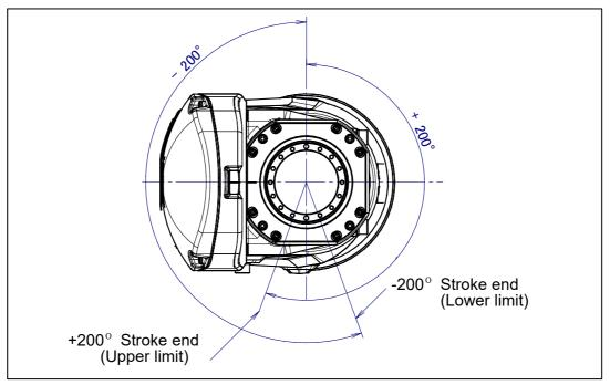
Fig. 3.3 (d) J4-axis motion limit
