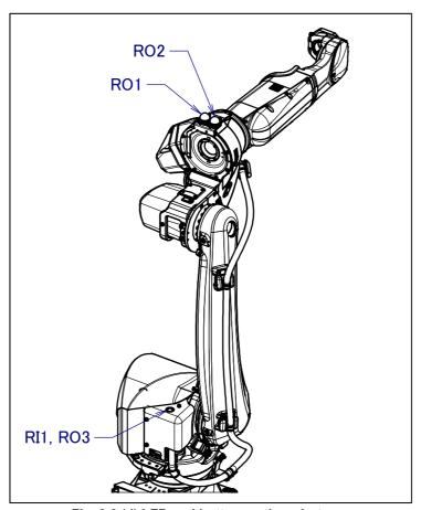
Fig. 3.6 (d) LED and button on the robot arm
