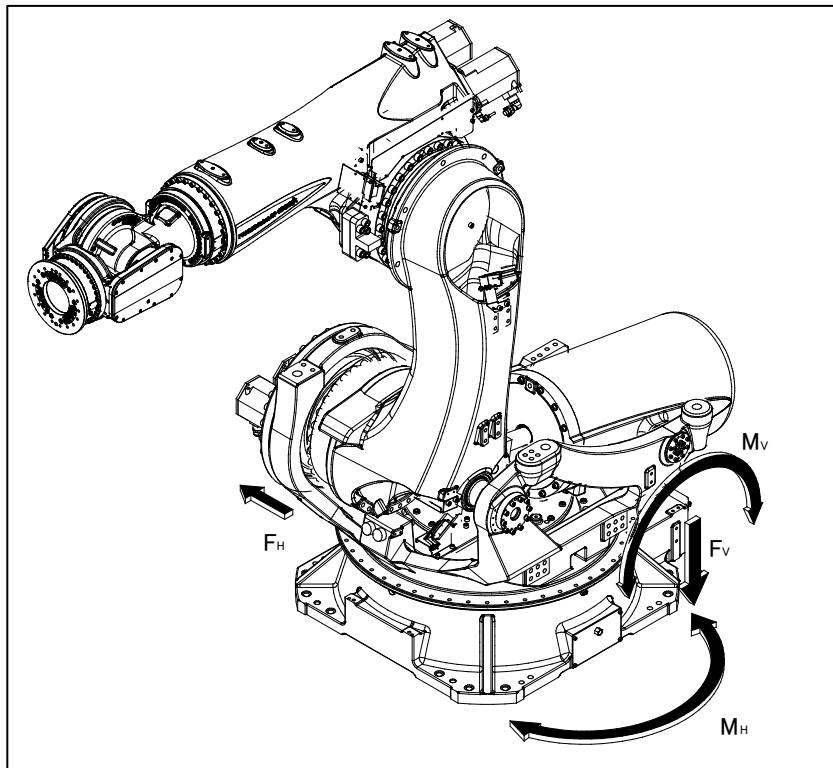
图 1.2 (b) 断电停止时作用的力以及力矩
