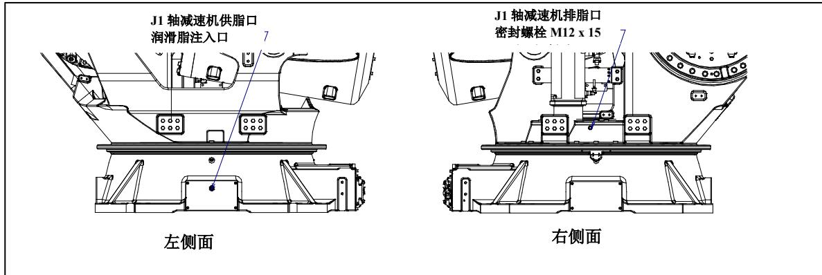
图 7.3.3 (a) J1 轴减速机的润滑脂的更换
