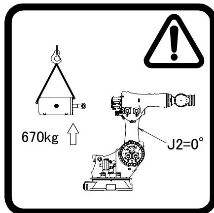
图 4 (i) 平衡缸更换标签
