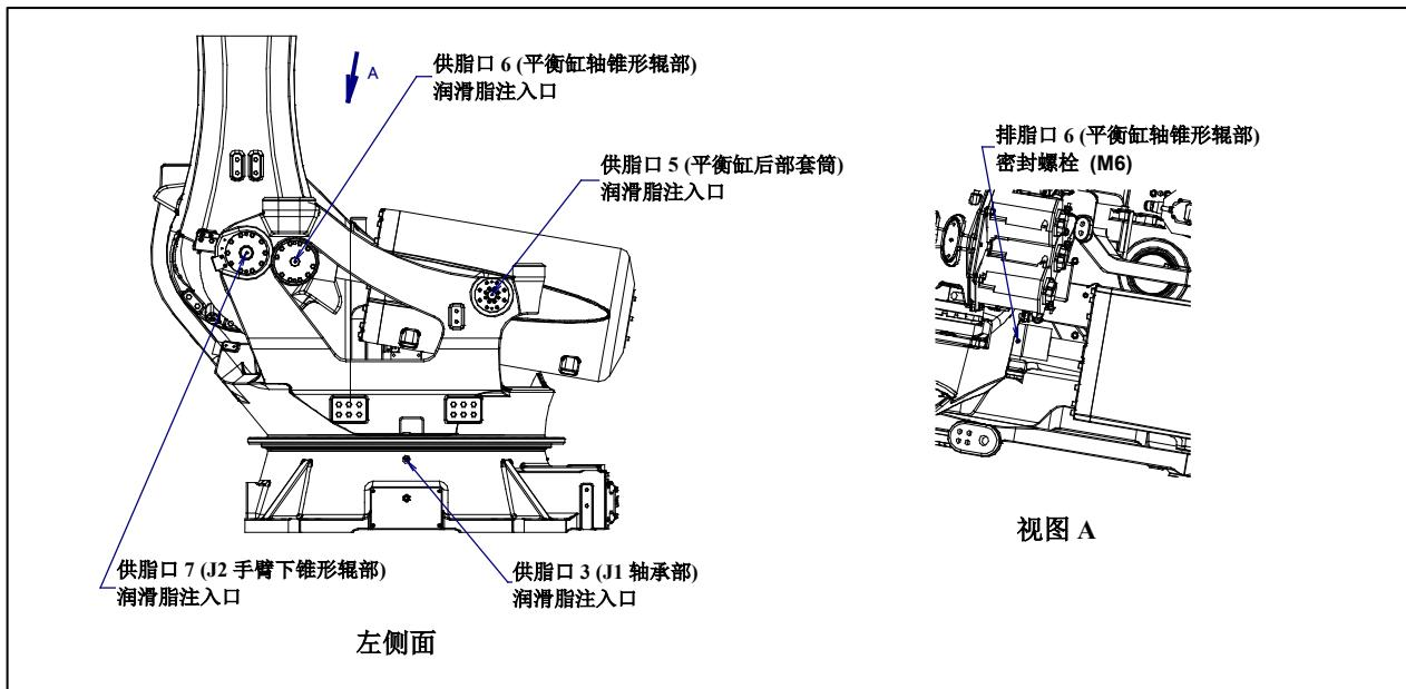
图 7.3.1 (b) 向平衡缸后面套筒和其他的连接部供脂
