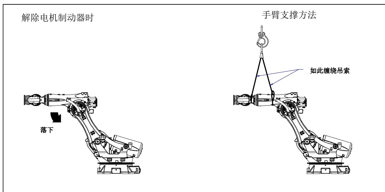
图 3 (b) 解除 J3 轴的电机制动器造成的手臂动作和事先采取的措施例
