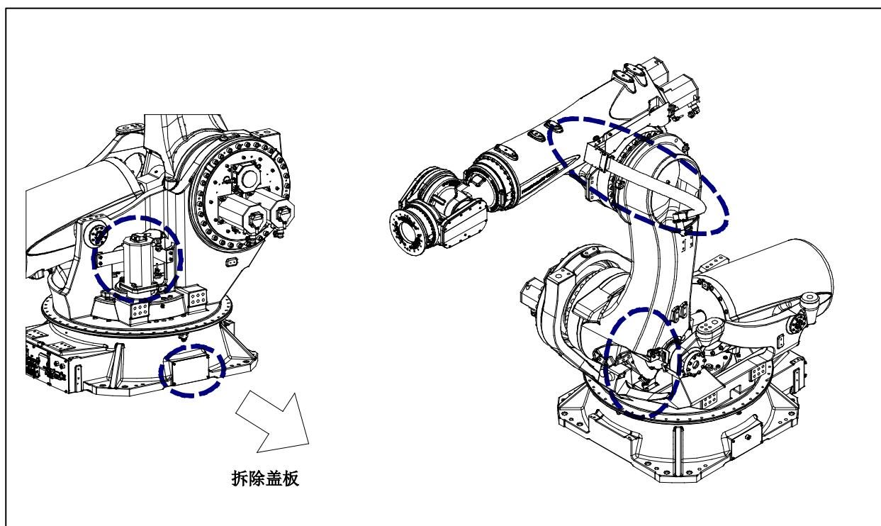
图 7.2.3 (a) 机构部内电缆的检修部位
