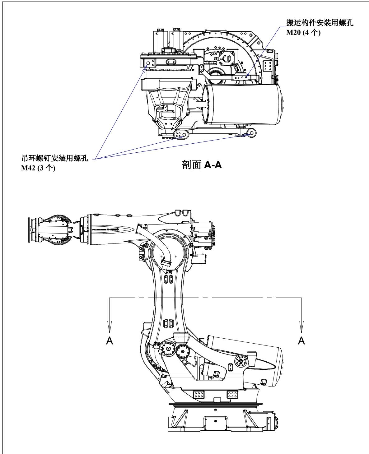
图 1.1 (a) 搬运用部件, 吊环螺钉安装位置
