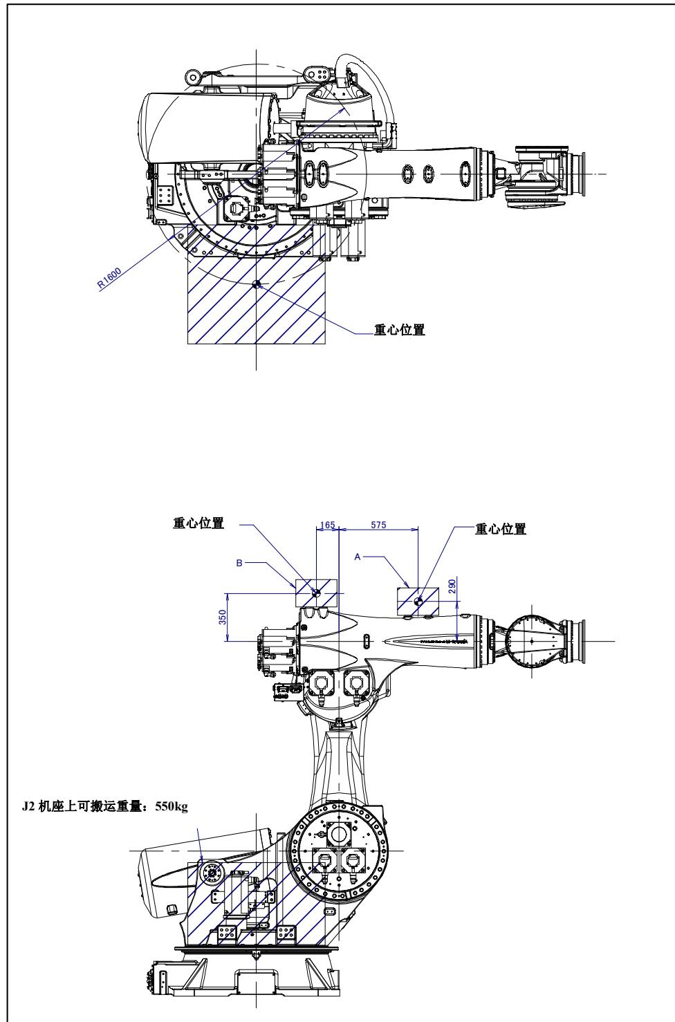
图 3.5 (a) J2 机座上/J3 手臂部的负载条件
