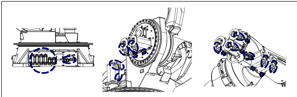
图 7.2.3 (d) 连接器的检修部位
