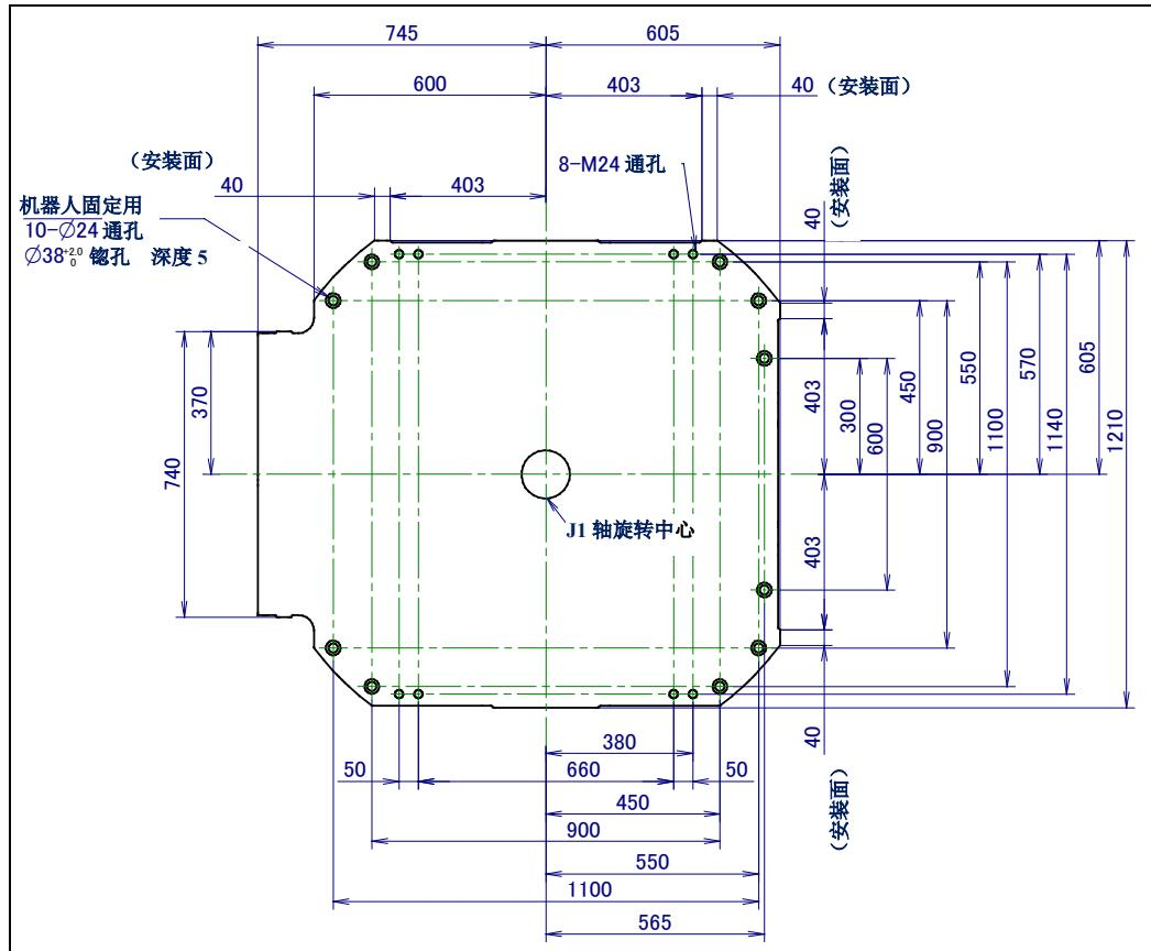
图 1.2 (a) 机器人机座尺寸
