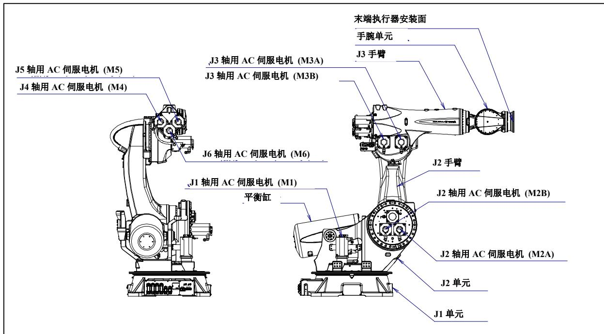
图 3.1 (a) 机构部的构成
