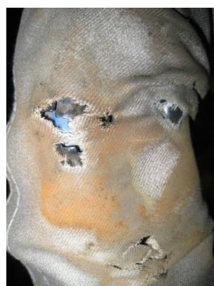
图 7.2.3 (b) 电缆保护套的损坏
