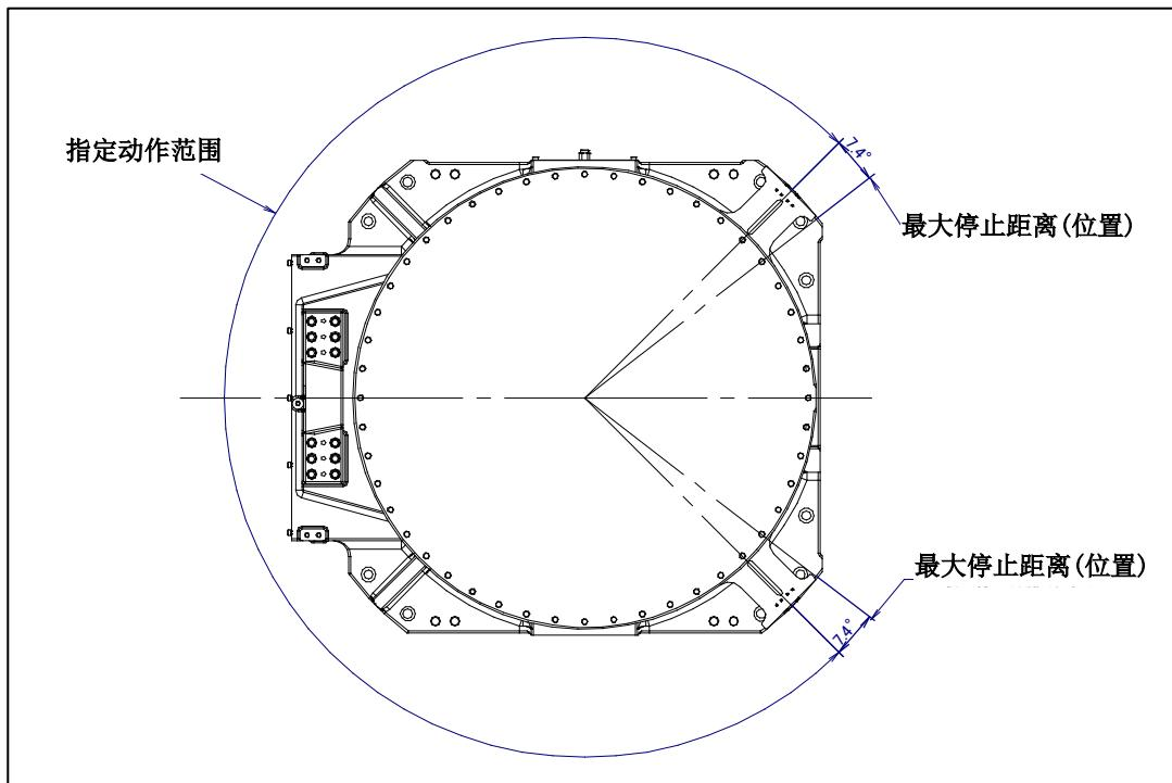
图 6.2.3 (a) J1 轴机械式可变制动器的最大停止距离(位置)
