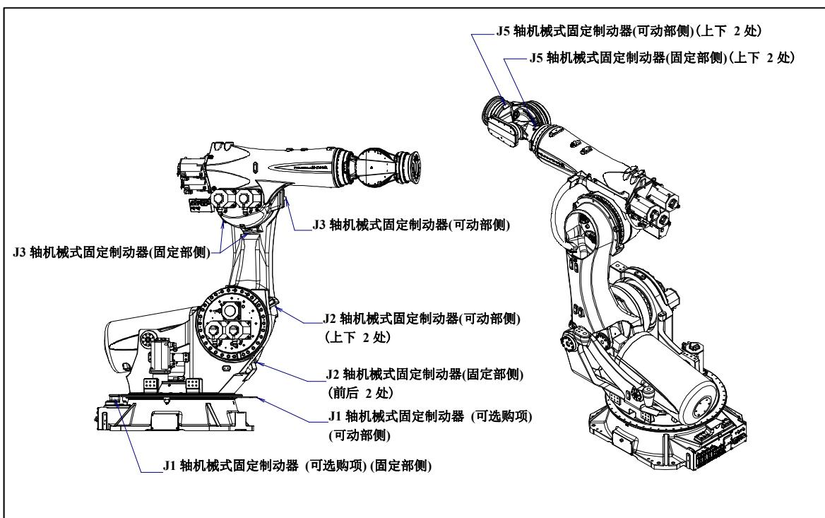
图 3.3 (a) 机械式制动器的位置
