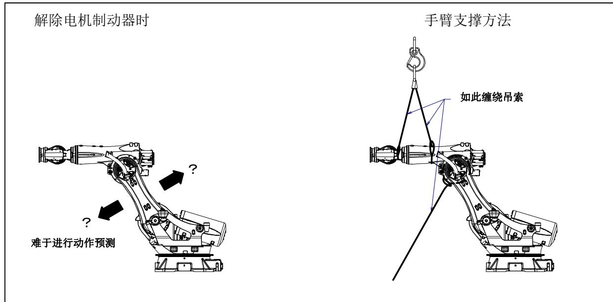
图 3 (a) 解除 J2 轴的电机制动器造成的手臂动作和事先采取的措施例
