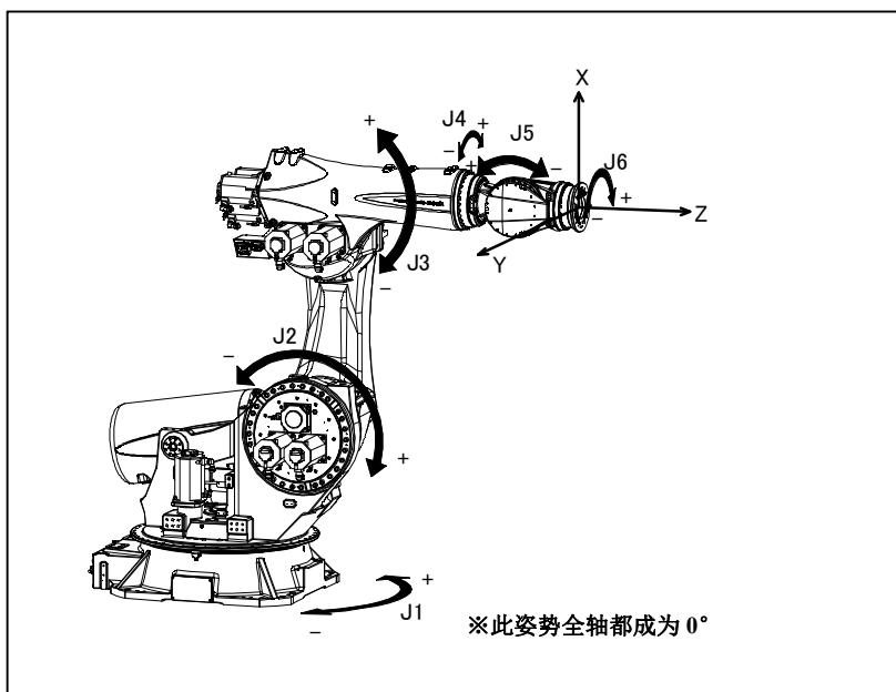
图 3.1 (b) 各轴坐标和机械接口坐标
