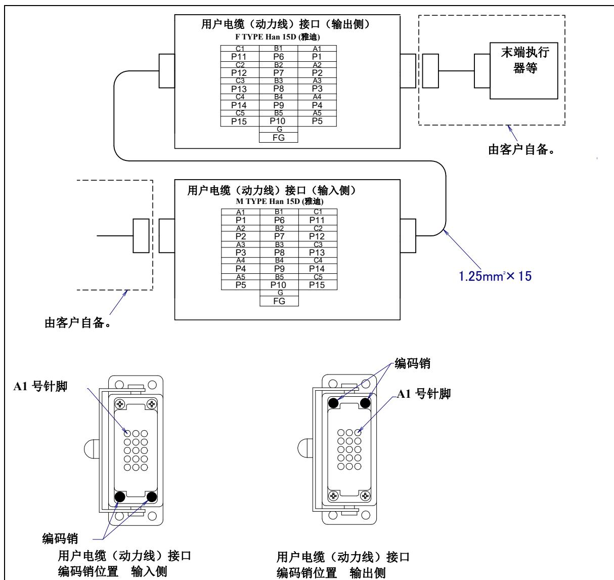
图 5.3 (e) 用户电缆（动力线）(AP)接口的插针排列和编码销配置位置（可选购项）
