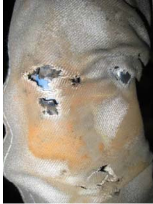
图 7.2.3 (b) 电缆保护套的损坏
