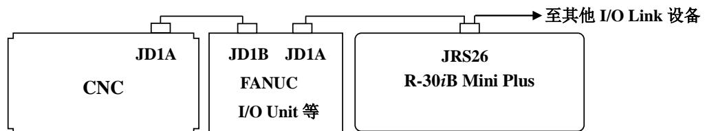
图 2.1.1 (a) 基于连接器 JRS26 的 I/O Link 的连接
