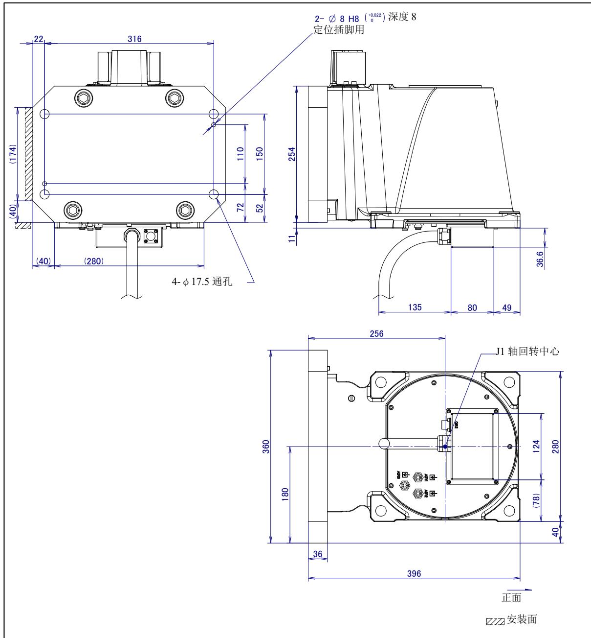
图 1.2 (c) 机器人机座尺寸 (壁挂规格)
