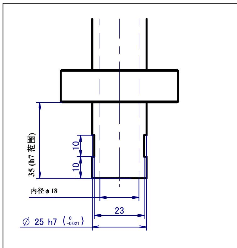
图 4.1 (a) 末端执行器安装面
