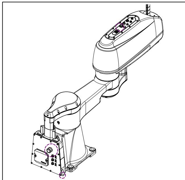
图 7.2.3 (a) 连接器的检修部位
