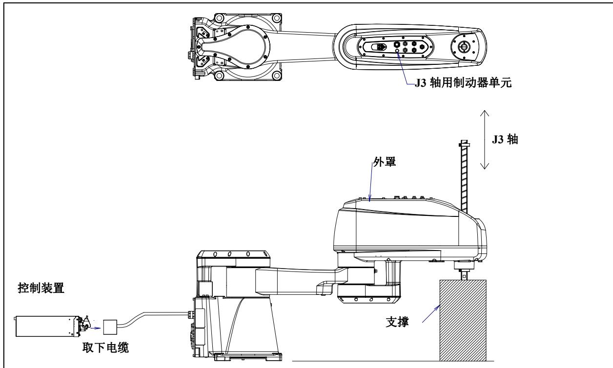
图 3 (a) J3 轴制动机解除按钮
