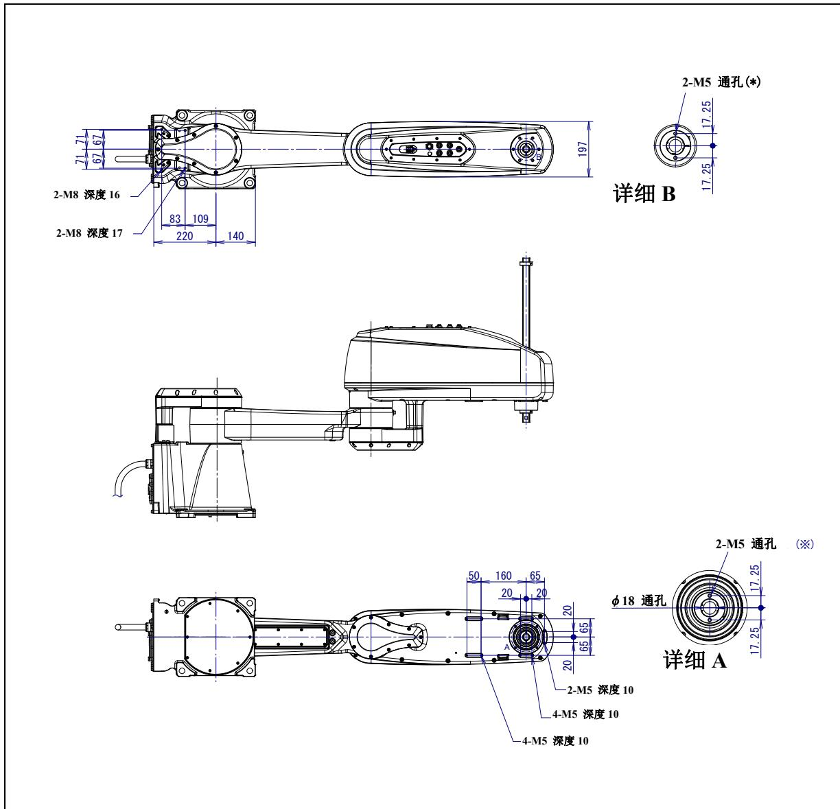
图 4.2 (c) 设备安装面尺寸 (SR-20iA)
