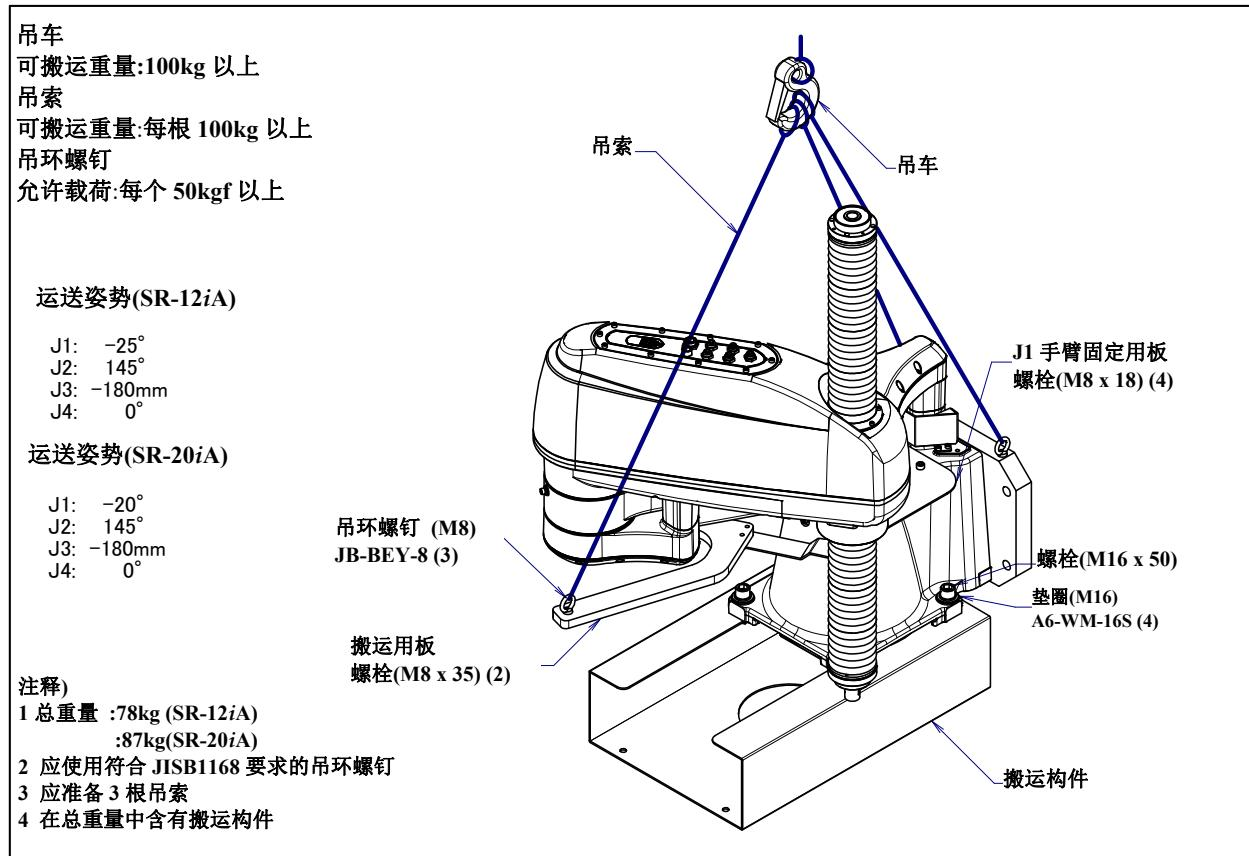
图 1.1 (b)采用吊车搬运 (壁挂规格)
