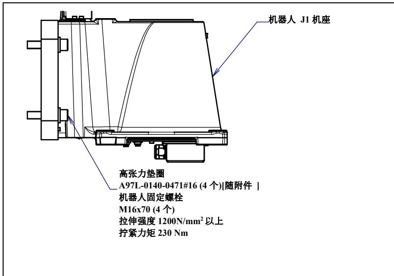
图 1.2.1 (b) 设置具体例 (壁挂规格)
