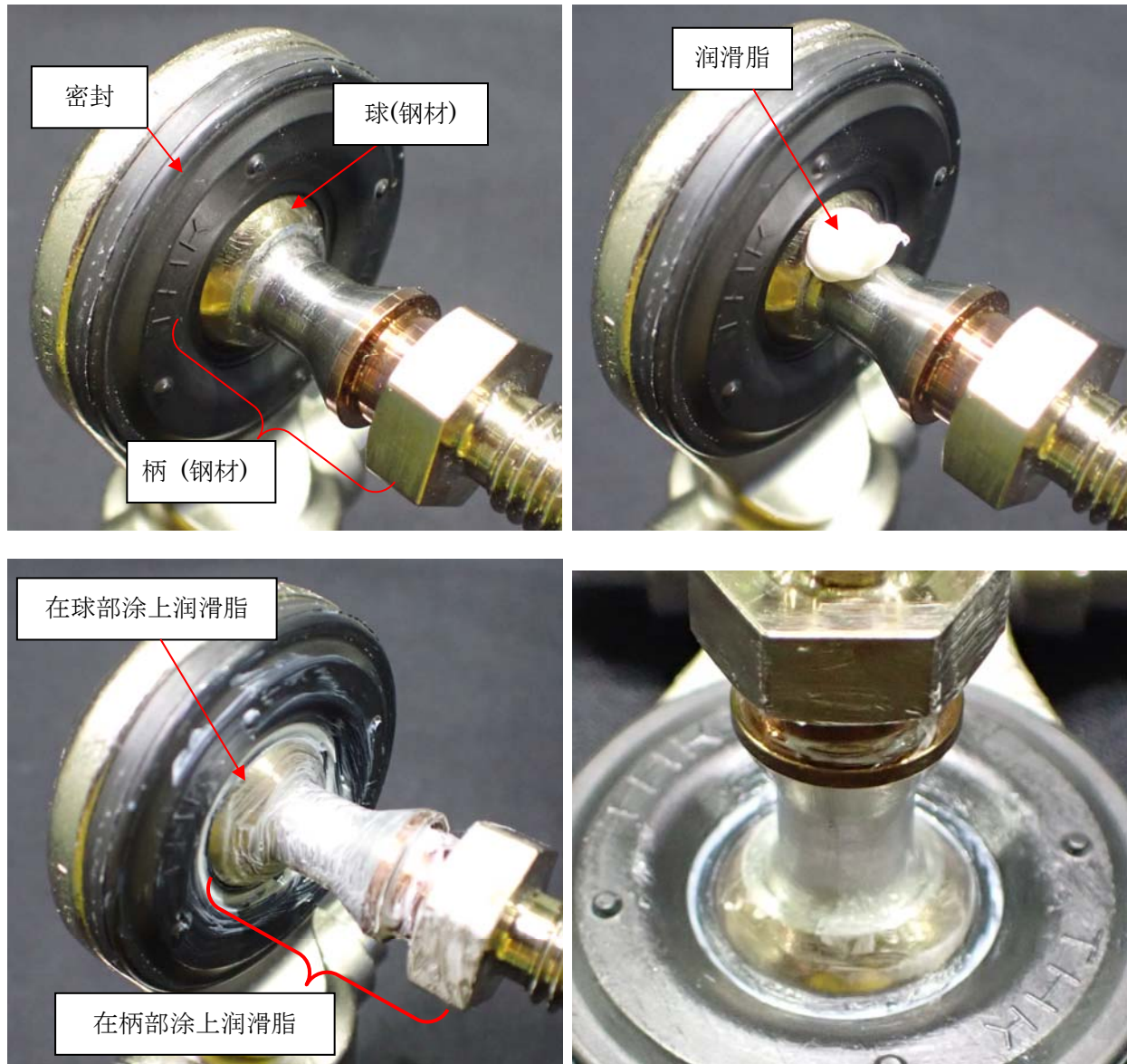
图 6.3.3.2 (a) 镀·密封类型的连杆 B 的维修步骤
