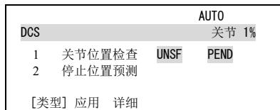
16 要使已经设定的值有效，请暂时断开电源，在冷启动下重新通电。
