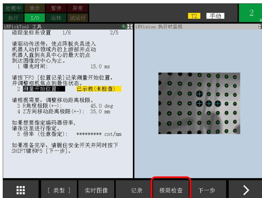
➤ 机器人必要最低限度地移动，开始检查可否移动到测量点。此时，在安全目标位置 X, Y, Z 的各个方向，以具有 5mm 左右的裕度状态下进行检查。
