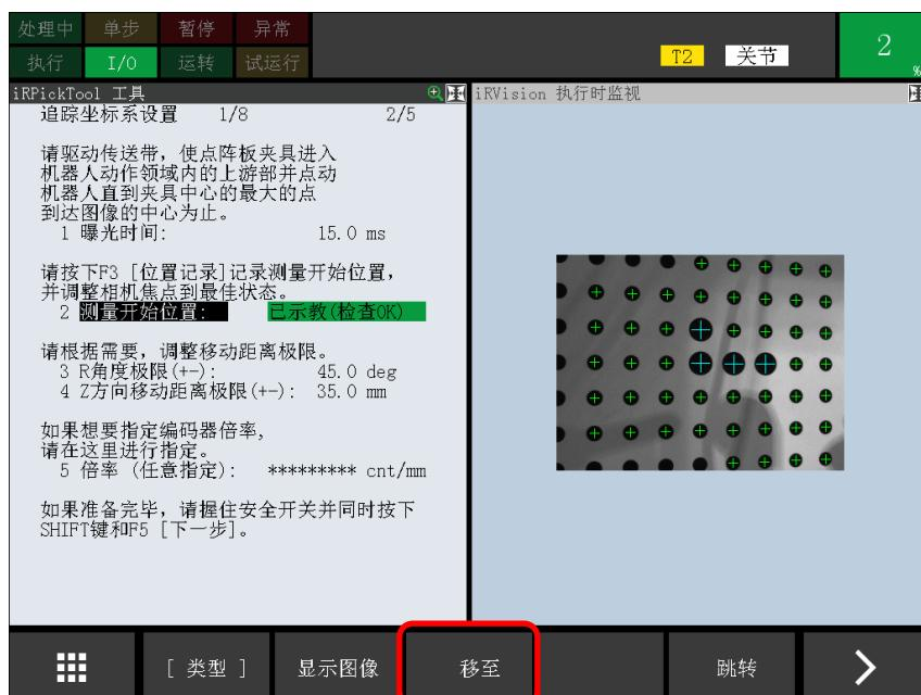
➤ 机器人移动到测量开始位置。
