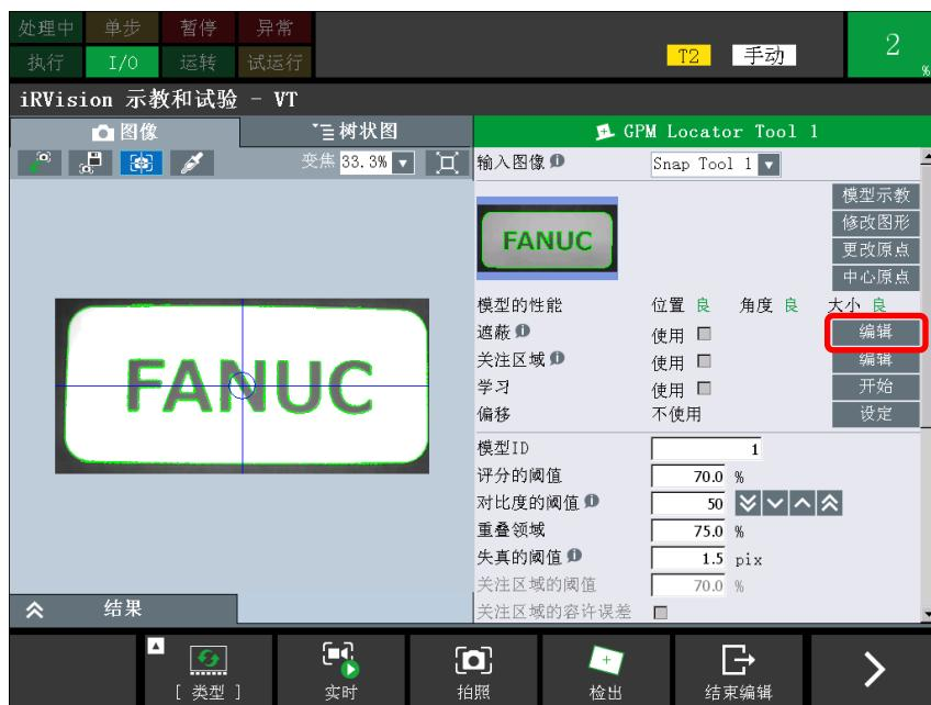
➤ 显示编辑按步骤 3 示教的模型主控范围（排除在型号之外的范围）的画面。
