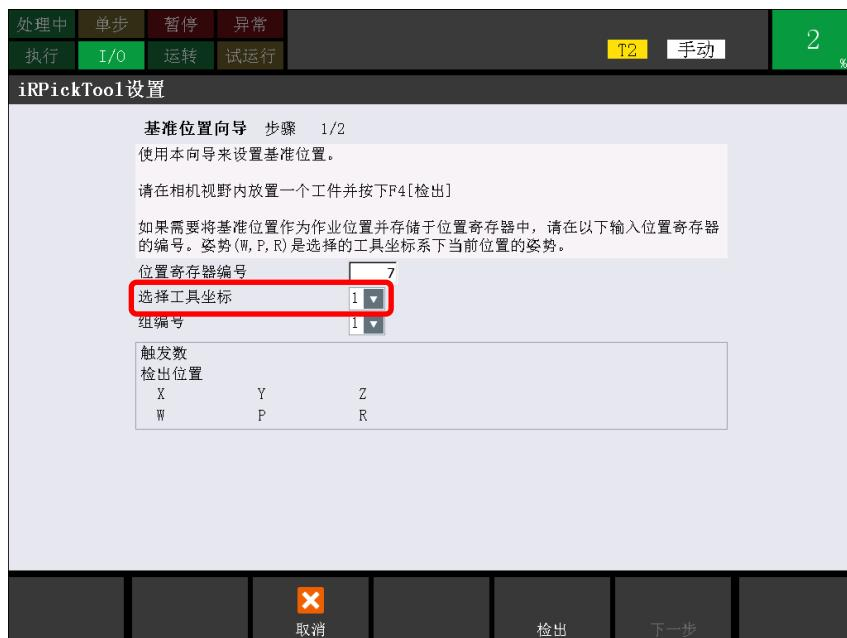
➤ 此处选择按《4 设定工具坐标系》设定的工具坐标系编号 1。
