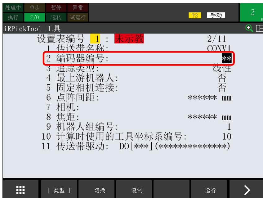
➤ 此处输入按《2.2 脉冲编码器的设定》设定的编码器编号 1。
