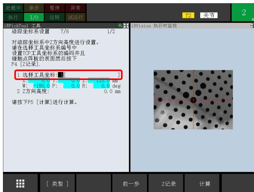
3. 通过点动操作移动机器人，使其碰触点阵板表面后，按下 F4“Z 记录”。
