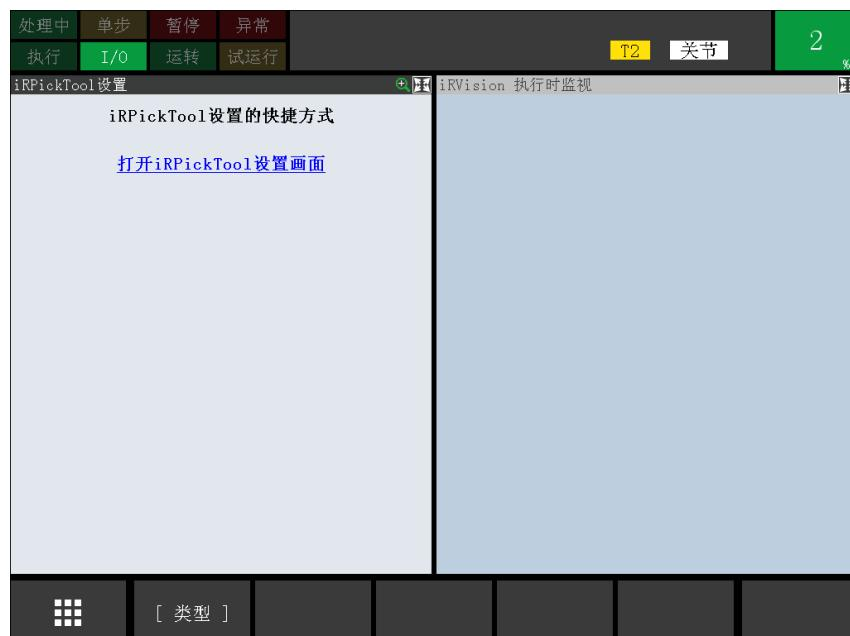
5. 在机器人控制装置的示教器上按压"MENU (菜单)"键, 选择"实用工具" — "iRPickTool"。
