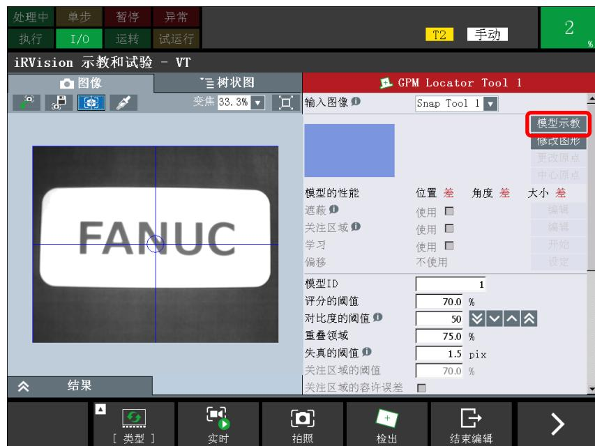
➤ 显示示教检出工件型号的画面。
