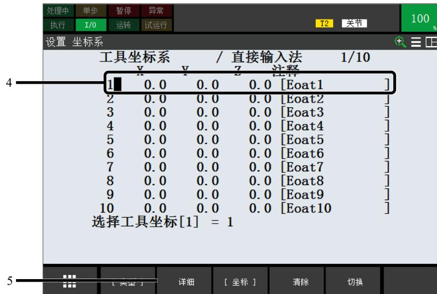
4 将光标对准要设置的工具坐标系编号的行。
