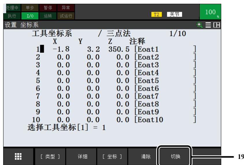
19 确认TCP是否正确设置。按F5“切换”，输入坐标系编号。
