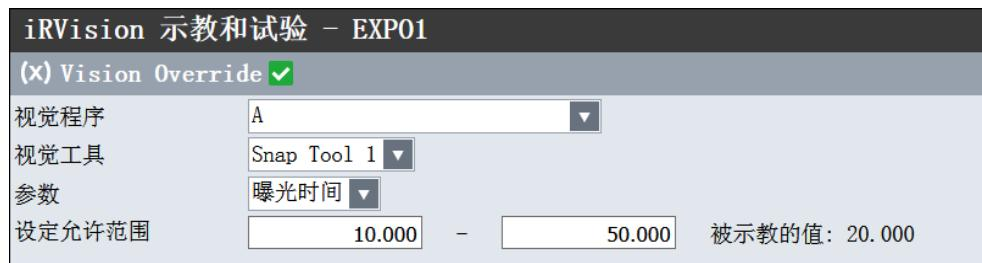
以下为程序样本。在第15行执行视觉检出。以此为例，将此时的曝光时间设定为20ms。视觉检出失败时，在第20行调用视觉变量设定命令，将曝光时间修改为保存于寄存器[5]中的数值(例如25ms)。在这种状态下再一次于第15行执行视觉程序“A”和检出，即会以25ms的保管时间进行拍照。
