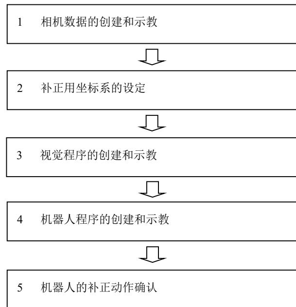
启动使用了 iRVision 的机器人系统时，请执行以上所有作业。相机位置偏移、更换相机时，请进行“1 相机数据的创建和示教”对相机重新校准。对于已校准完的相机，在进行工件的变更和品种的追加时，无需再次对相机进行校准。请进行“3 视觉程序的创建和示教”和“4 机器人程序的创建和示教”。
