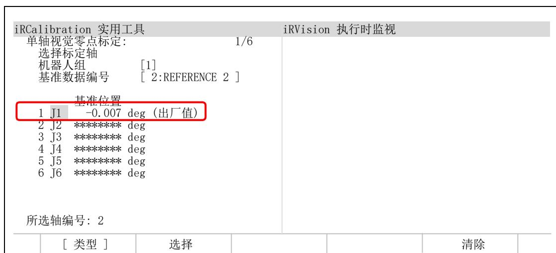
4 将光标指向已设置了值的基准位置按下[F5 (清除)]键, 再按下[F4 (是)]键, 就可清除光标所在行的基准位置值。
