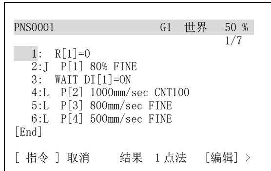
4 将机器人移动到希望在单步执行中修正示教位置的行。这里，假定移动到第 2 行的 P[1] 的位置。
