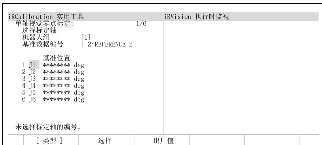
2 若按下 F2 (选择) 键, 画面的最下面一行显示“输入轴编号”。输入标定轴的编号, 按下 ENTER 键。
