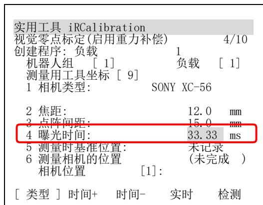
请参阅“3.2 显示执行时监视”，设置为能够同时看到执行时监视和创建程序画面。下面结合在 iPendant 上同时显示图像和创建程序画面的状态进行说明。示教器成为如下所示的情形。
