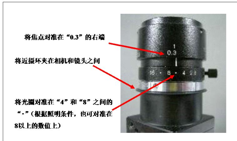
图 5.3.2 安装到相机上的镜头和近摄环 (M-1iA/0.5S, M-1iA/0.5SL)
