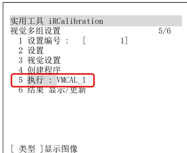
在示教器上显示校准用 TP 程序。
