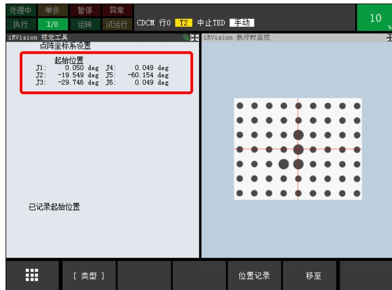
将机器人移动到已示教的测量开始位置时，在按住“SHIFT”键的同时按下 F5 “移至”。
