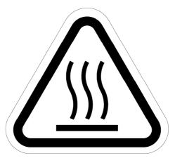
Fig. 4 (d) High-temperature warning label
