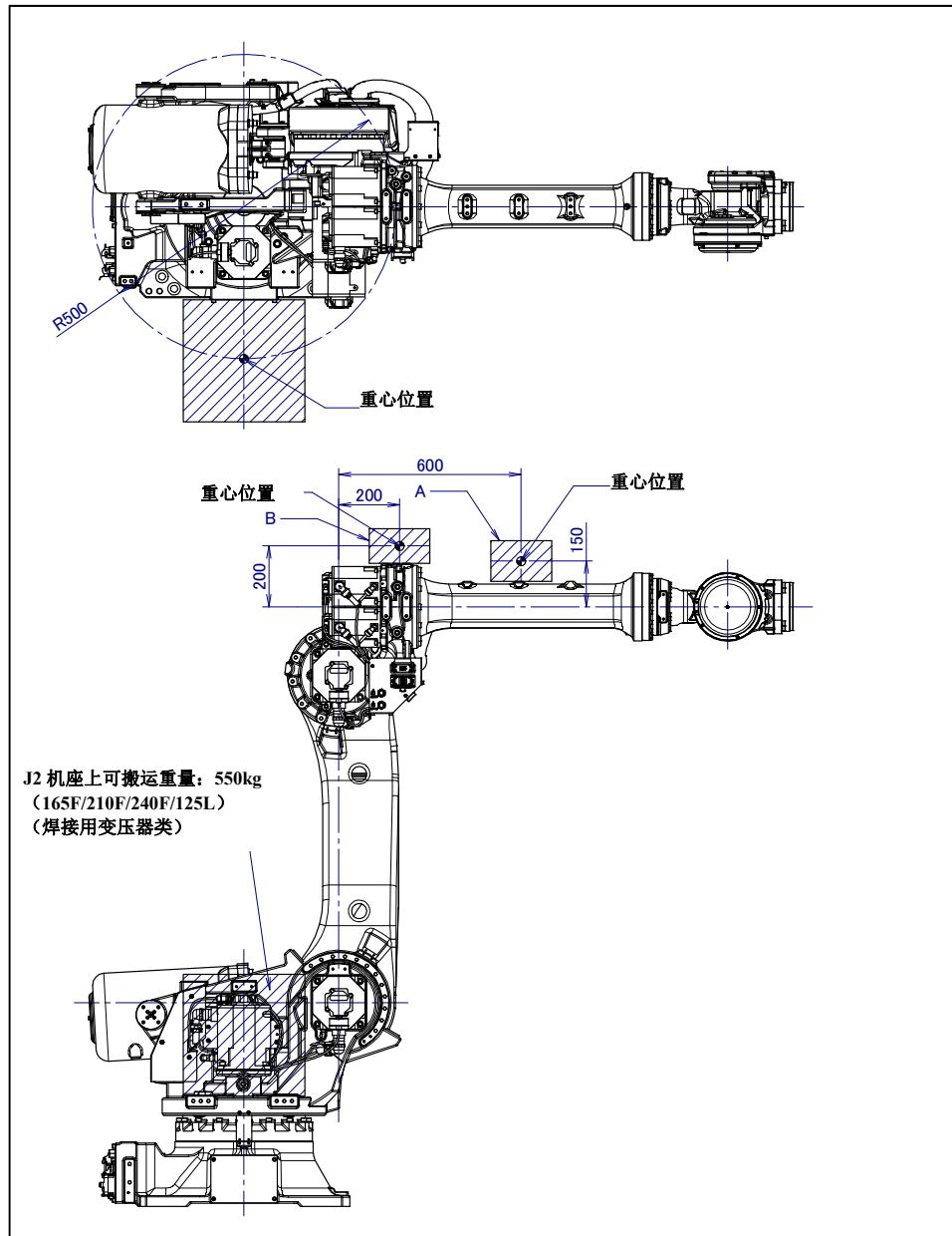
图 3.5 (b) J2 机座/J3 手臂部/J3 外壳上的负载条件 (R-2000iC/165F/210F/240F/125L/220U)
