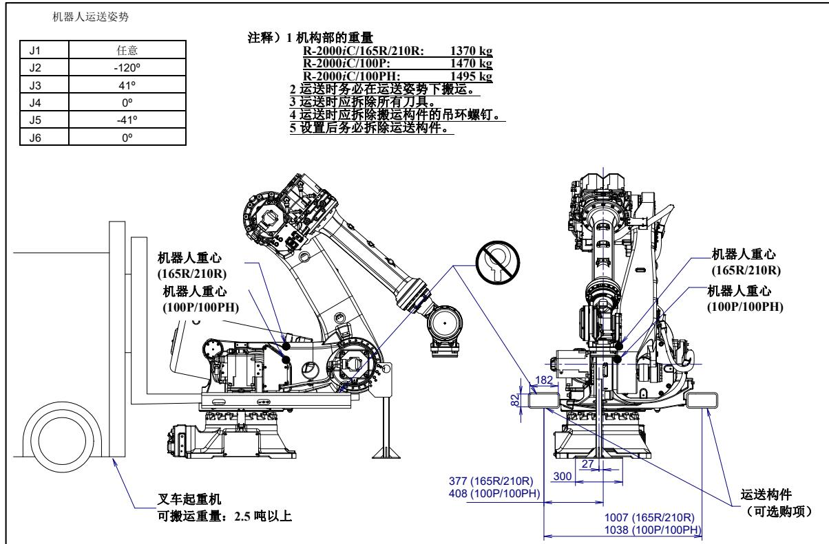
图 1.1 (o) 采用叉车搬运(R-2000iC/165R/210R/100P/100PH J2 机座类型)
