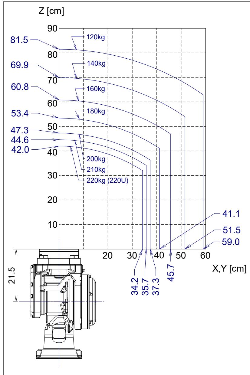
图 3.4 (c) 手腕部允许负载线图 (ISO 法兰盘)
