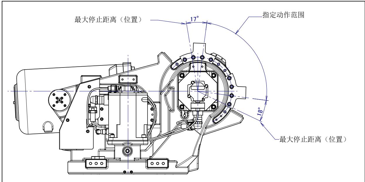
图 6.2.3 (b) J2 轴机械式可变制动器的最大停止距离 (位置)
