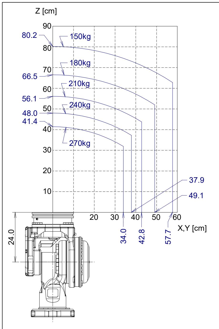
图 3.4 (k) 手腕部允许负载线图 (ISO 法兰盘)
