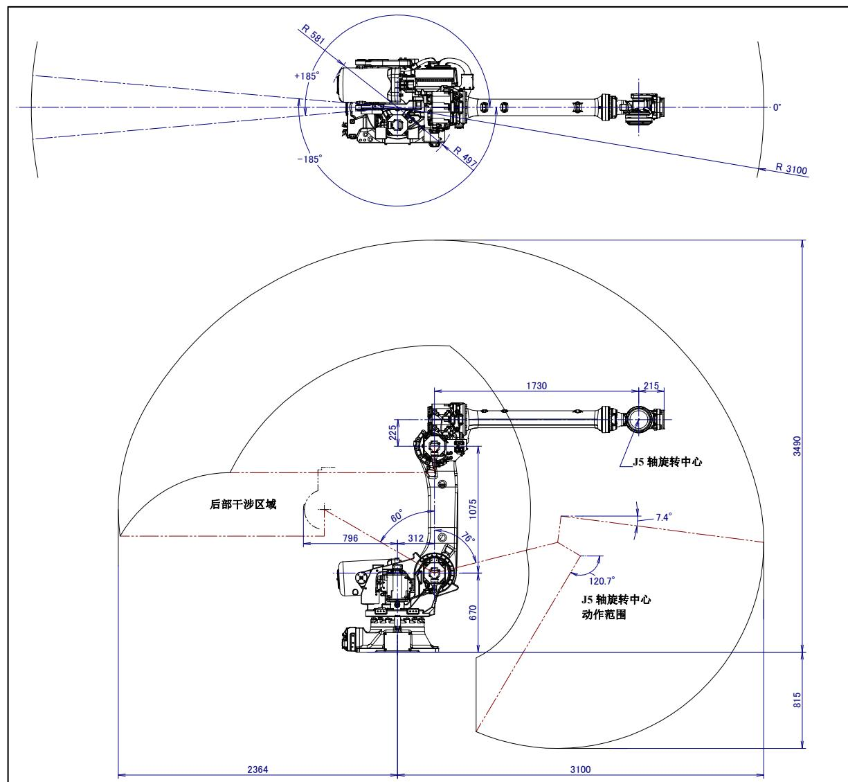
图 3.2 (b) 动作范围图 (R-2000iC/125L)
