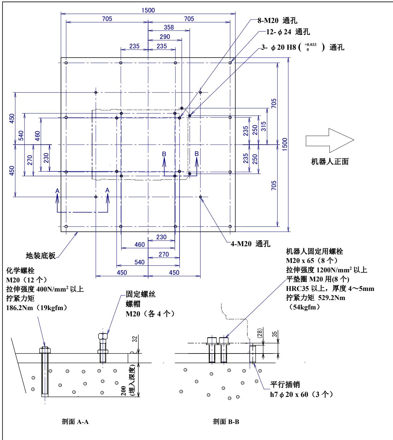
图 1.2.1 (e) 安装方法 II (R-2000iC/100P/100PH/270F/270R/190S/210L/190U)
