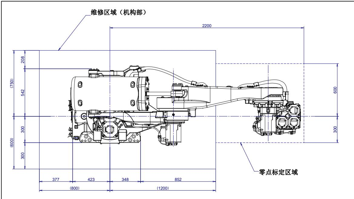
图 1.3 (b) 维修空间的布局图 (R-2000iC/165R/210R)
