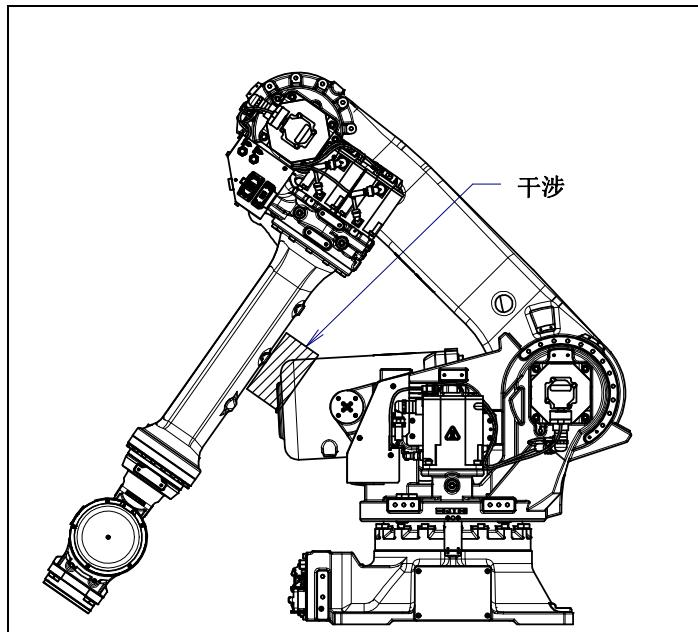
图 3.5 (a) J3 手臂和平衡缸的干涉
