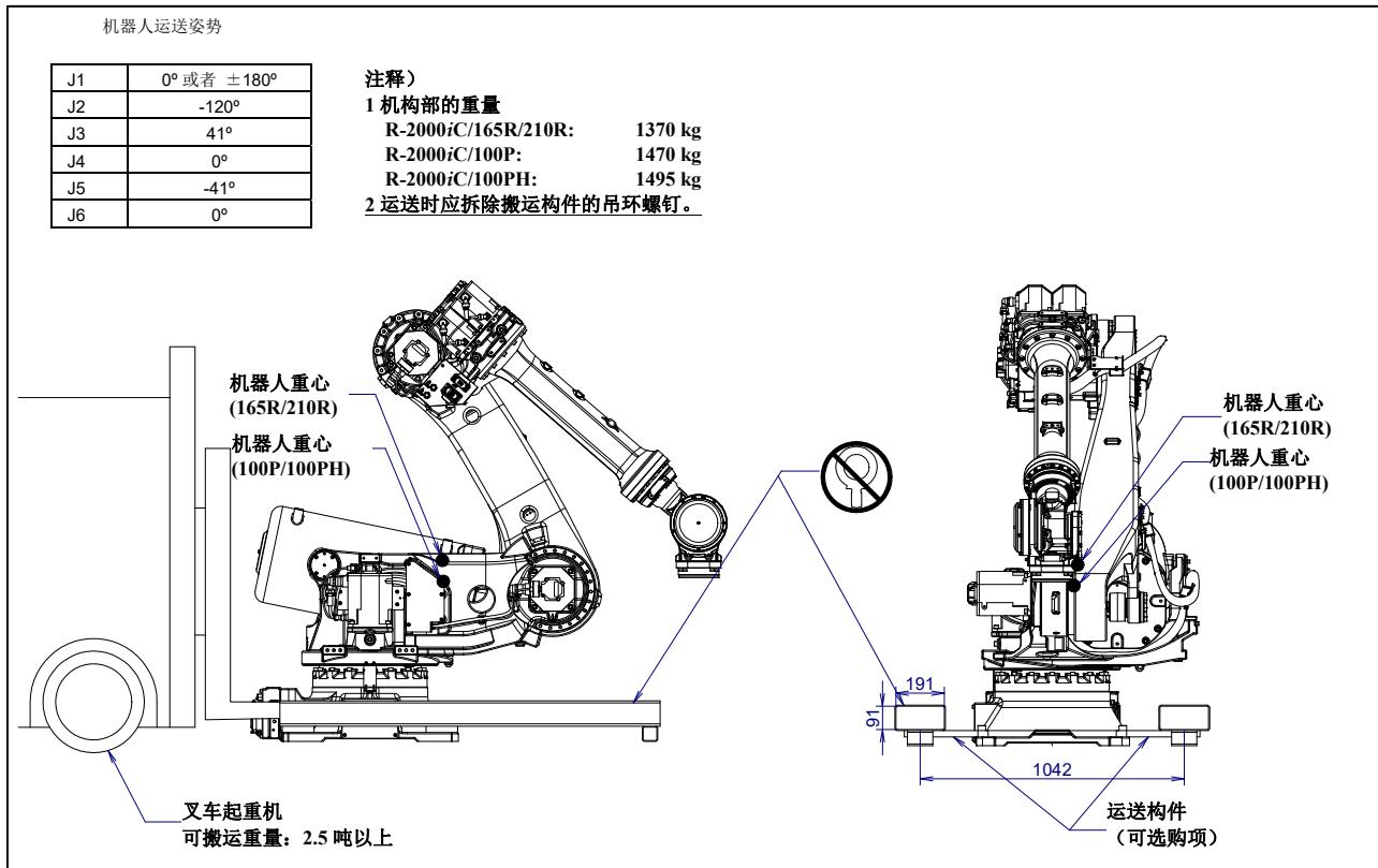
图 1.1 (n) 采用叉车搬运(R-2000iC/165R/210R/100P/100PH J1 机座类型)
