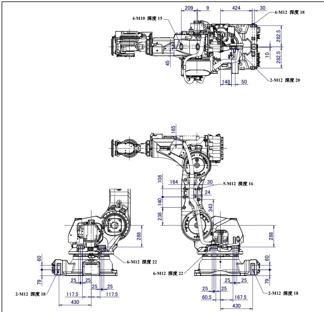
图 4.2 (h) 设备安装面尺寸 (R-2000iC/190S 指定精度·刚性强化可选购项时)
