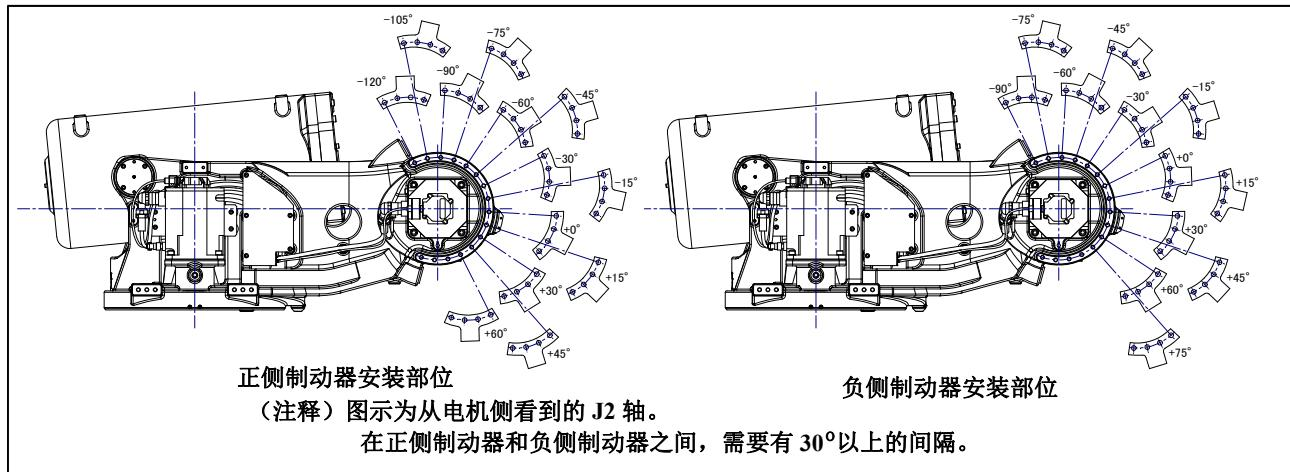
图 6.2.1 (m) J2 轴机械式可变制动器的安装 (2/2)
