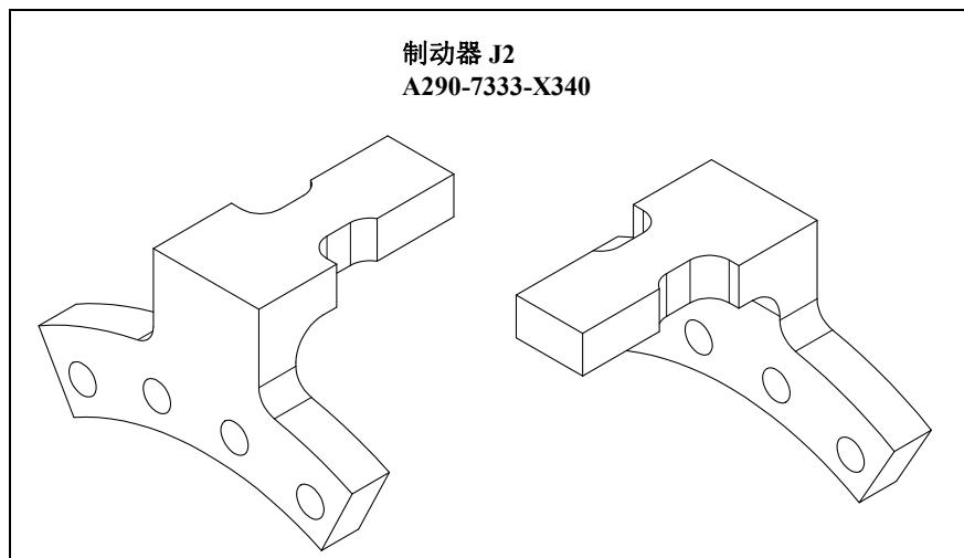
图 6.2.1 (h) J2 轴机械式可变制动器 (可选购项)
