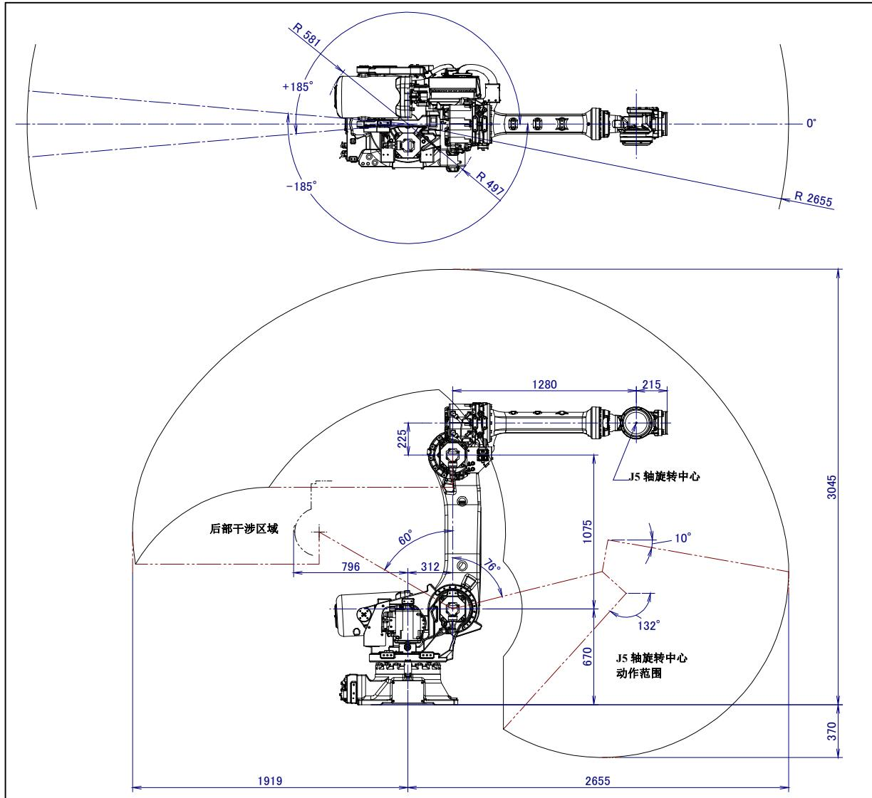
图 3.2 (a) 动作范围图 (R-2000iC/165F/210F/240F)
