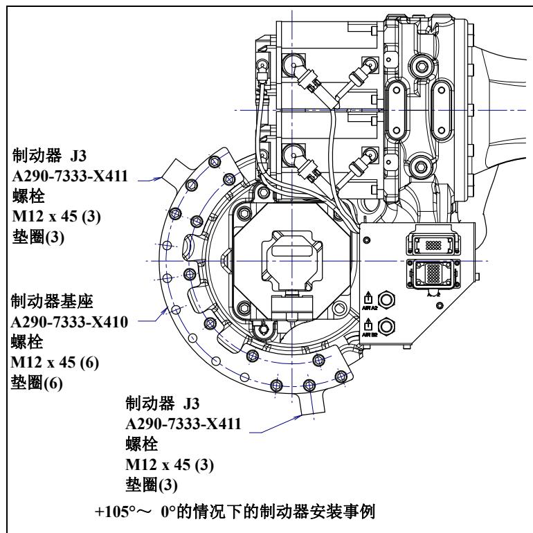
图 6.2.1 (s) J3 轴机械式可变制动器的安装 (2/3)
