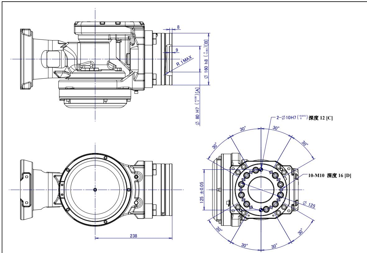
图 4.1 (c) 末端执行器安装面(绝缘 ISO 法兰盘 A05B-1333-H153)
