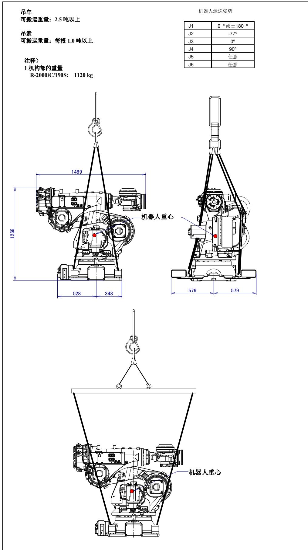
图 1.1 (k) 采用吊车搬运 (R-2000iC/190S 使用搬运构件时)
