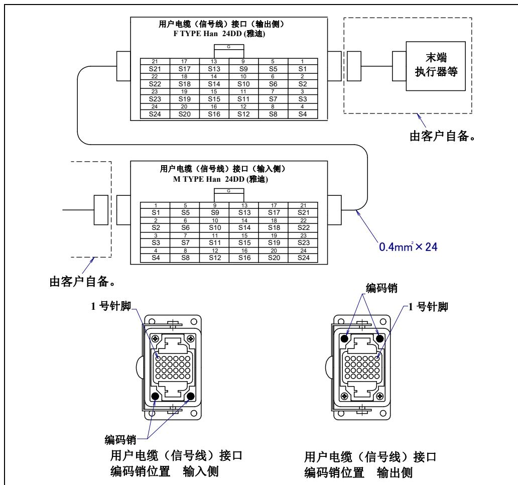
图 5.3 (r) 用户电缆 (信号线) (AS)
