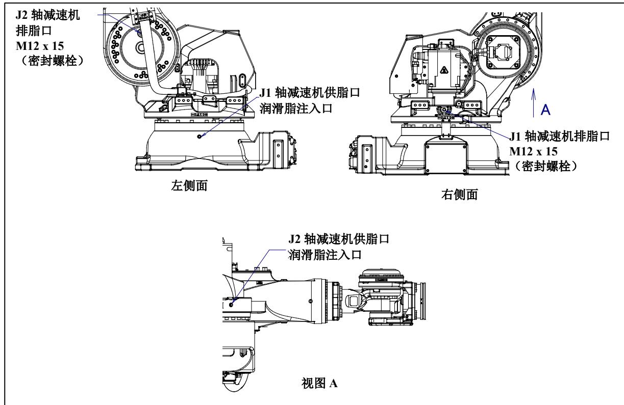
图 7.3.3 (e) J1/J2 轴减速机的润滑脂的更换(R-2000iC/190S)
