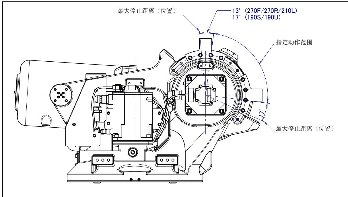
图 6.2.3 (d) J2 轴机械式可变制动器的最大停止距离 (位置)
