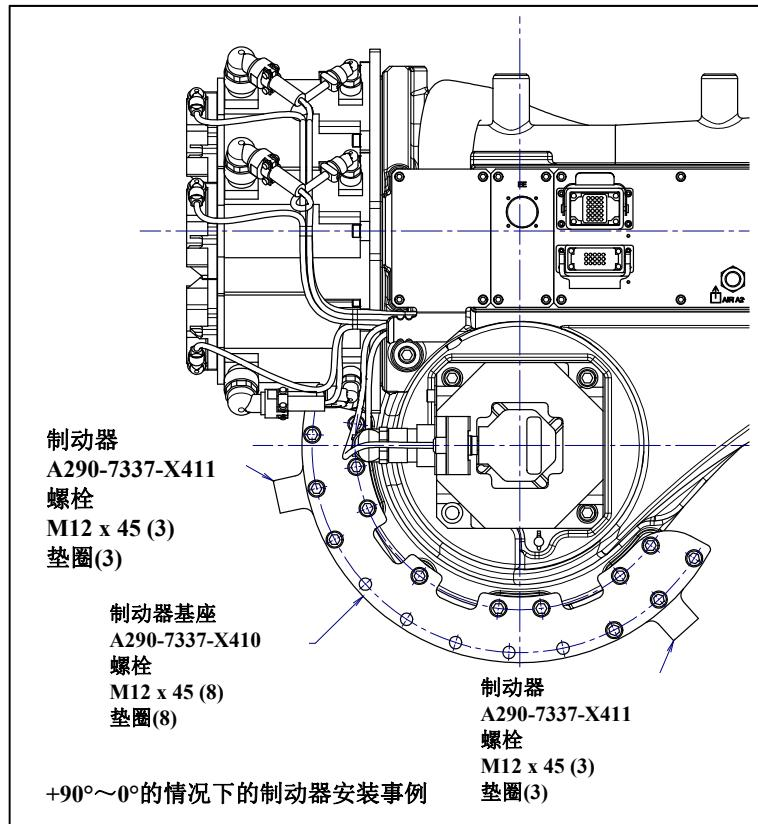
图 6.2.1 (v) J3 轴机械式可变制动器的安装 (1/2)
