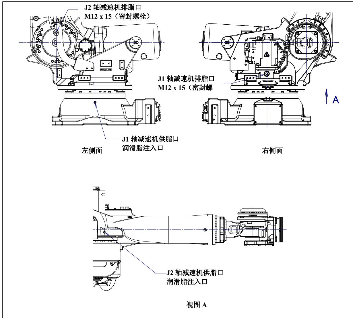
图 7.3.3 (d) J1/J2 轴减速机的润滑脂的更换(R-2000iC/270F/270R/210L/190U)
