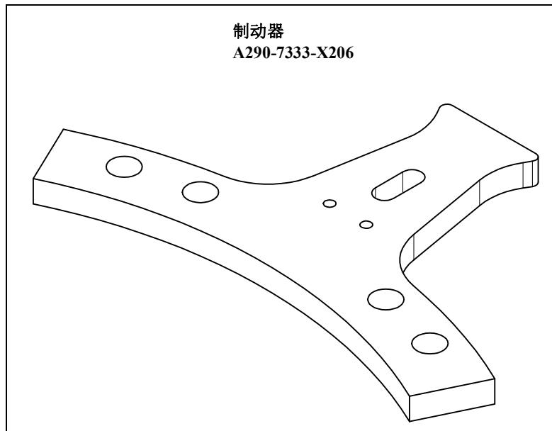
图 6.2.1 (a) J1 轴机械式可变制动器 (可选购项)
