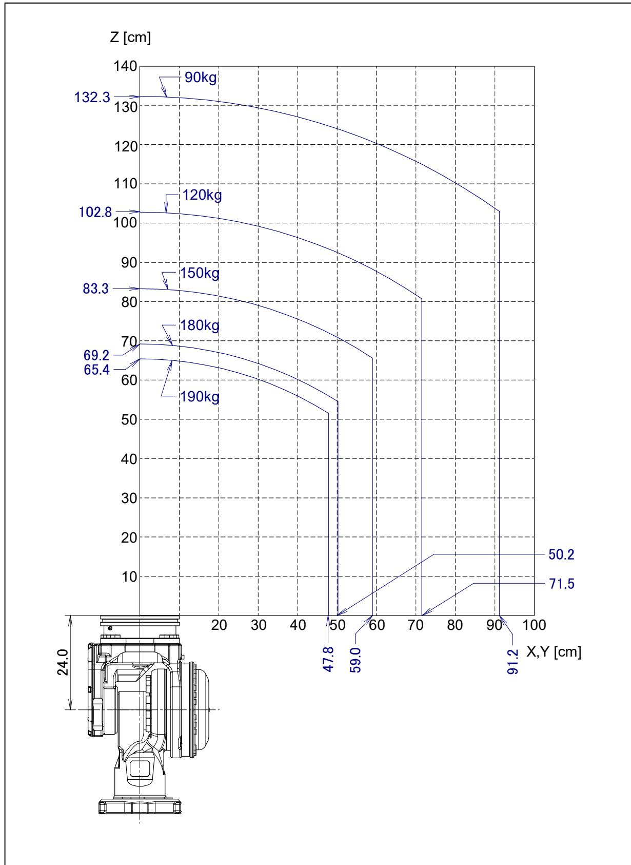
图 3.4 (s) 手腕部允许负载线图 (ISO 法兰盘)
