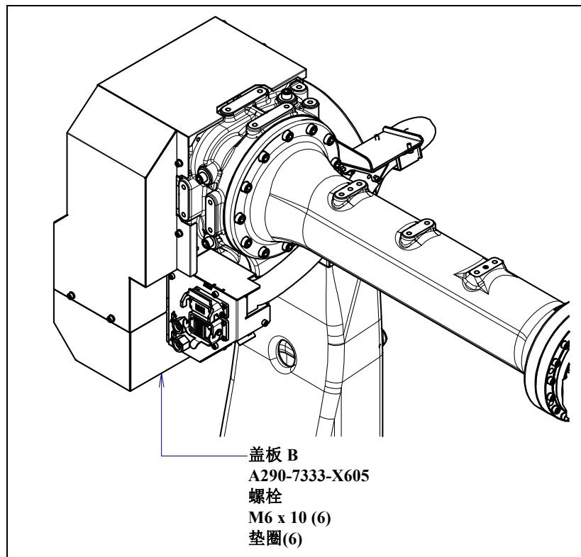
图 6.2.1 (r) J3 轴机械式可变制动器的安装 (1/3)
