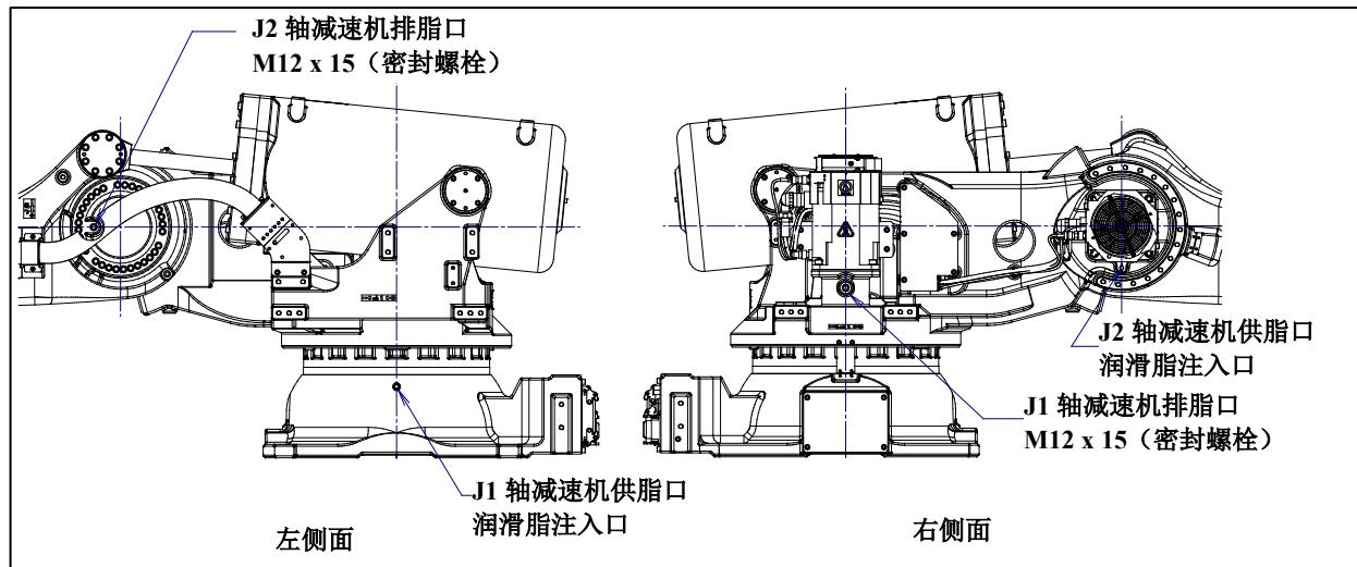
图 7.3.3 (c) J1/J2 轴减速机的润滑脂的更换(R-2000iC/100P/100PH)
