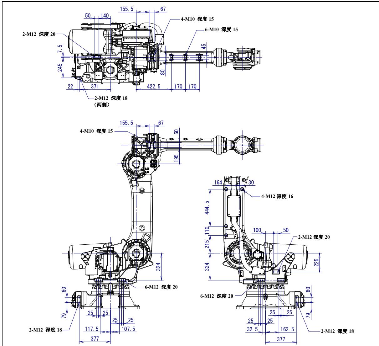
图 4.2 (a) 设备安装面尺寸 (R-2000iC/165F/210F/240F/220U)
