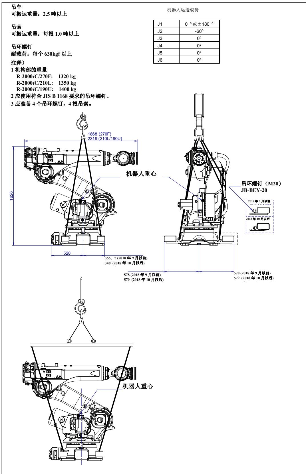
图 1.1 (i) 采用吊车搬运 (R-2000iC/270F/210L/190U 使用搬运构件时)
