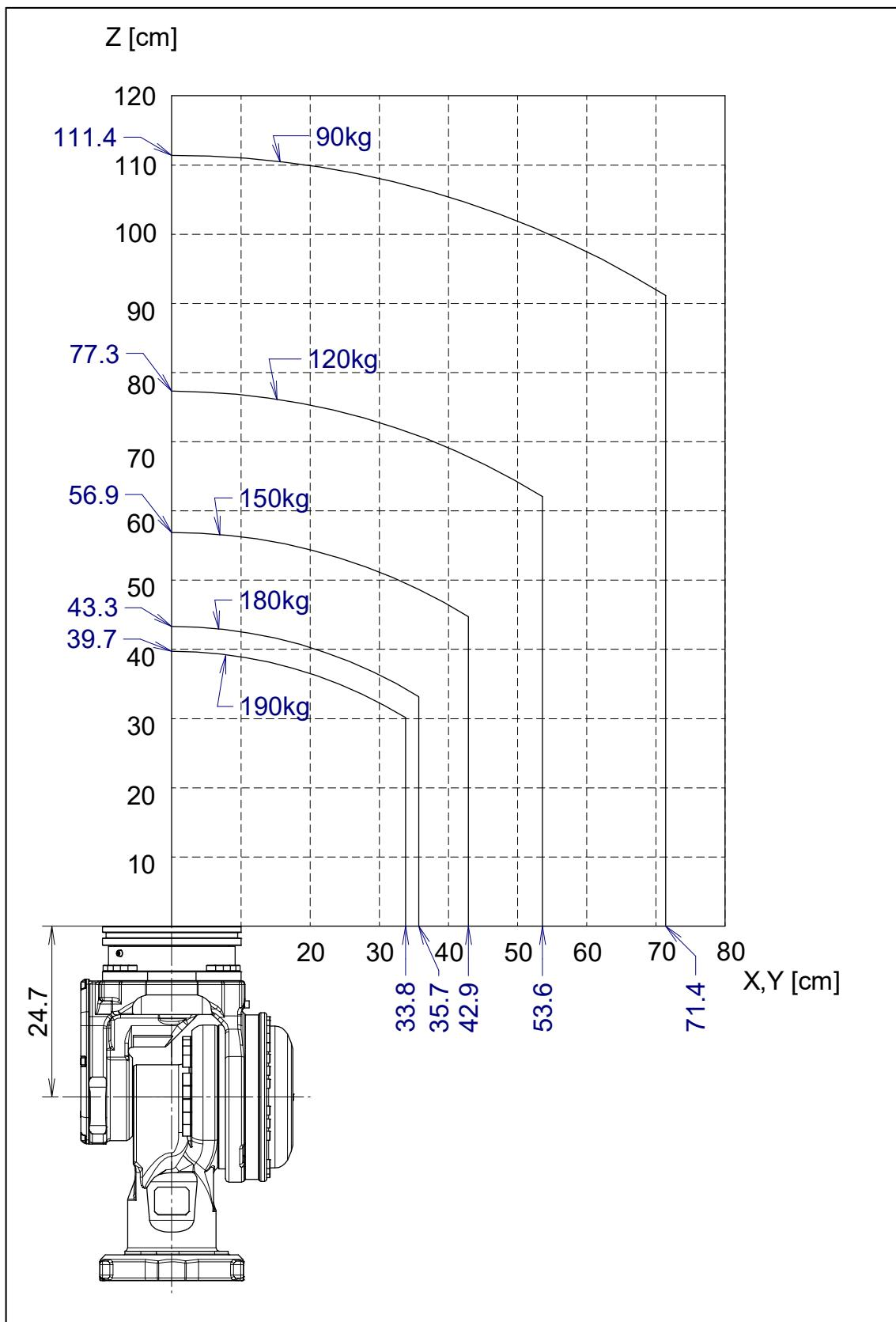
图 3.4 (p) 手腕部允许负载线图 (绝缘 ISO 法兰盘)
