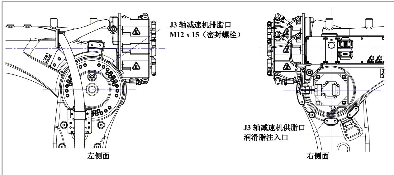
图 7.3.3 (g) J3 轴减速机的润滑脂的更换 (R-2000iC/270F/270R/190S/210L/190U)
