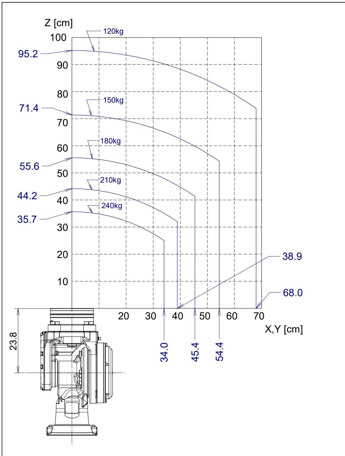
图 3.4 (f) 手腕部允许负载线图 (绝缘 ISO 法兰盘)
