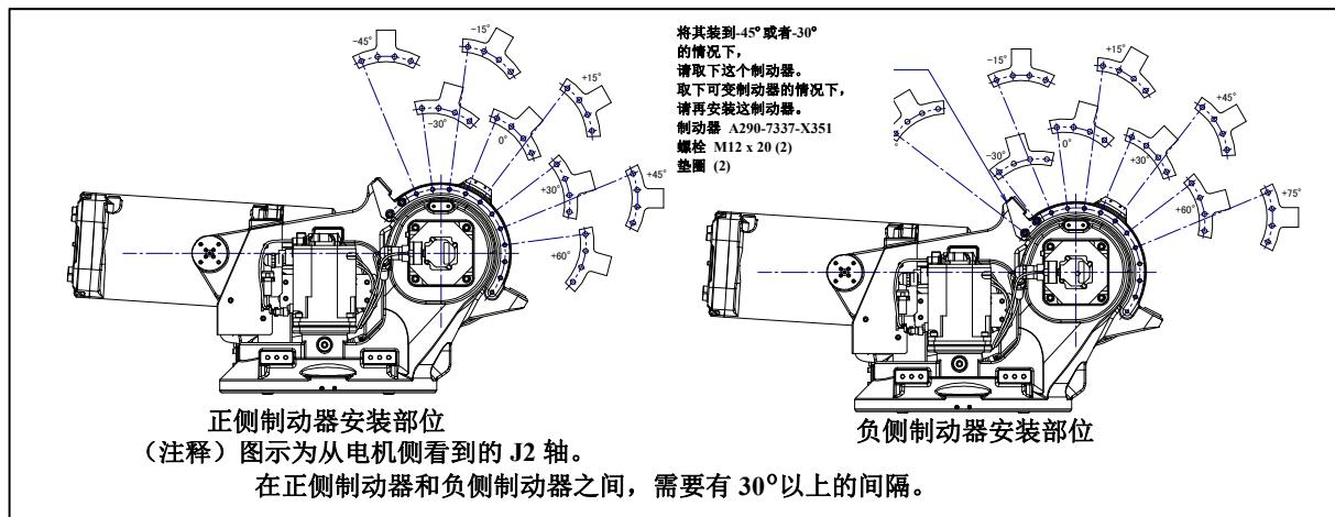
图 6.2.1 (p) J3 轴机械式可变制动器的安装 (3/3)
