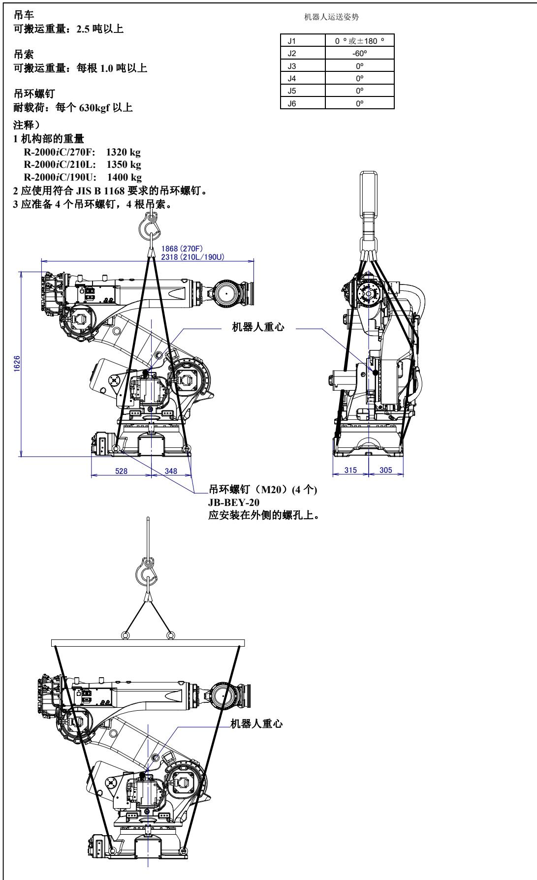
图 1.1 (h) 采用吊车搬运 (R-2000iC/270F/210L/190U)
