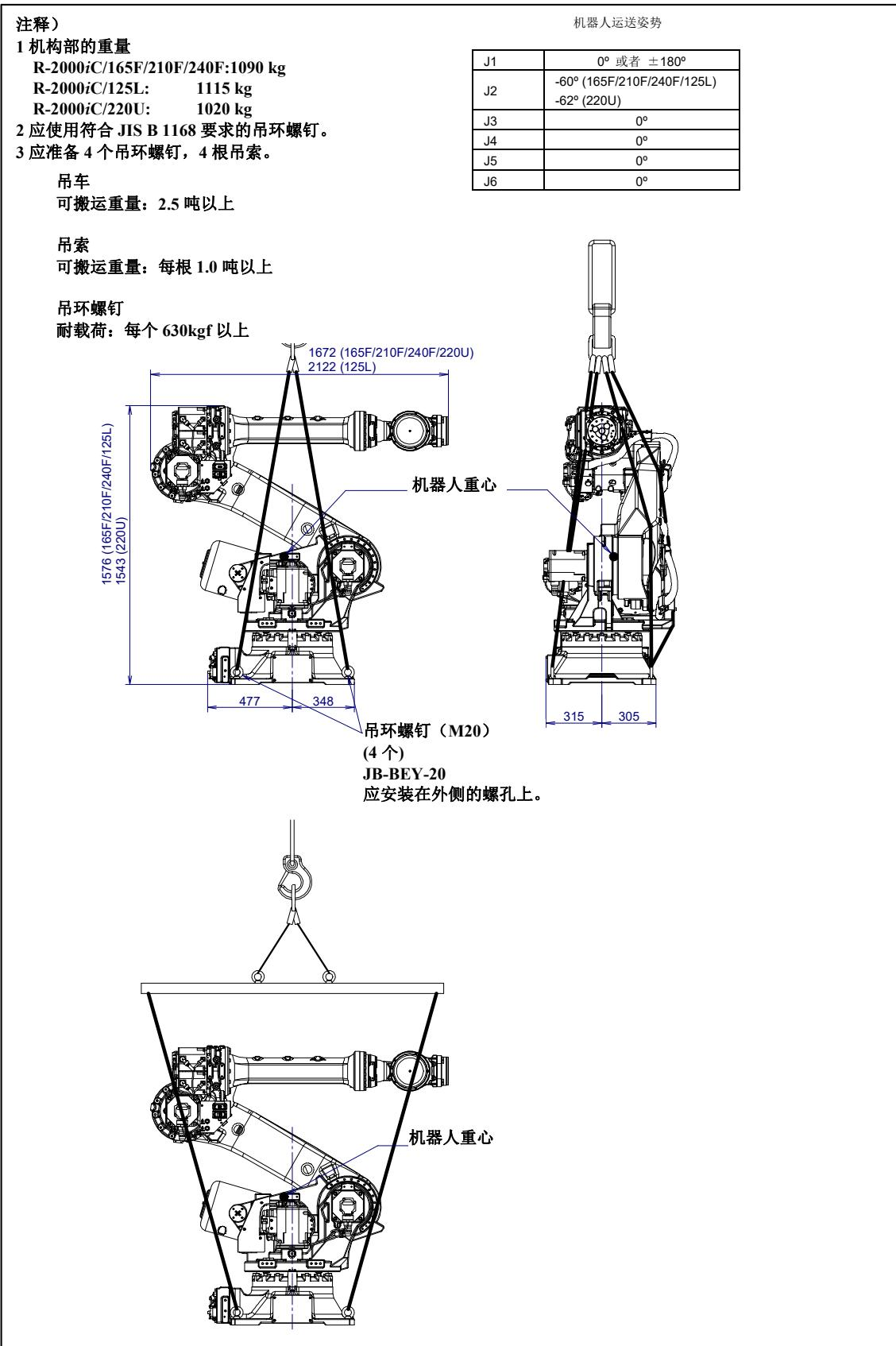
图 1.1 (b) 采用吊车搬运 (R-2000iC/165F/210F/240F/125L/220U)
