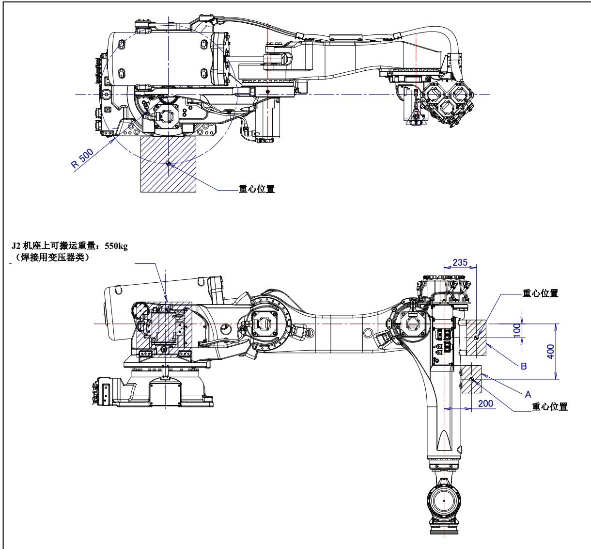
图 3.5 (e) J2 机座/J3 手臂部上的负载条件(R-2000iC/270R)
