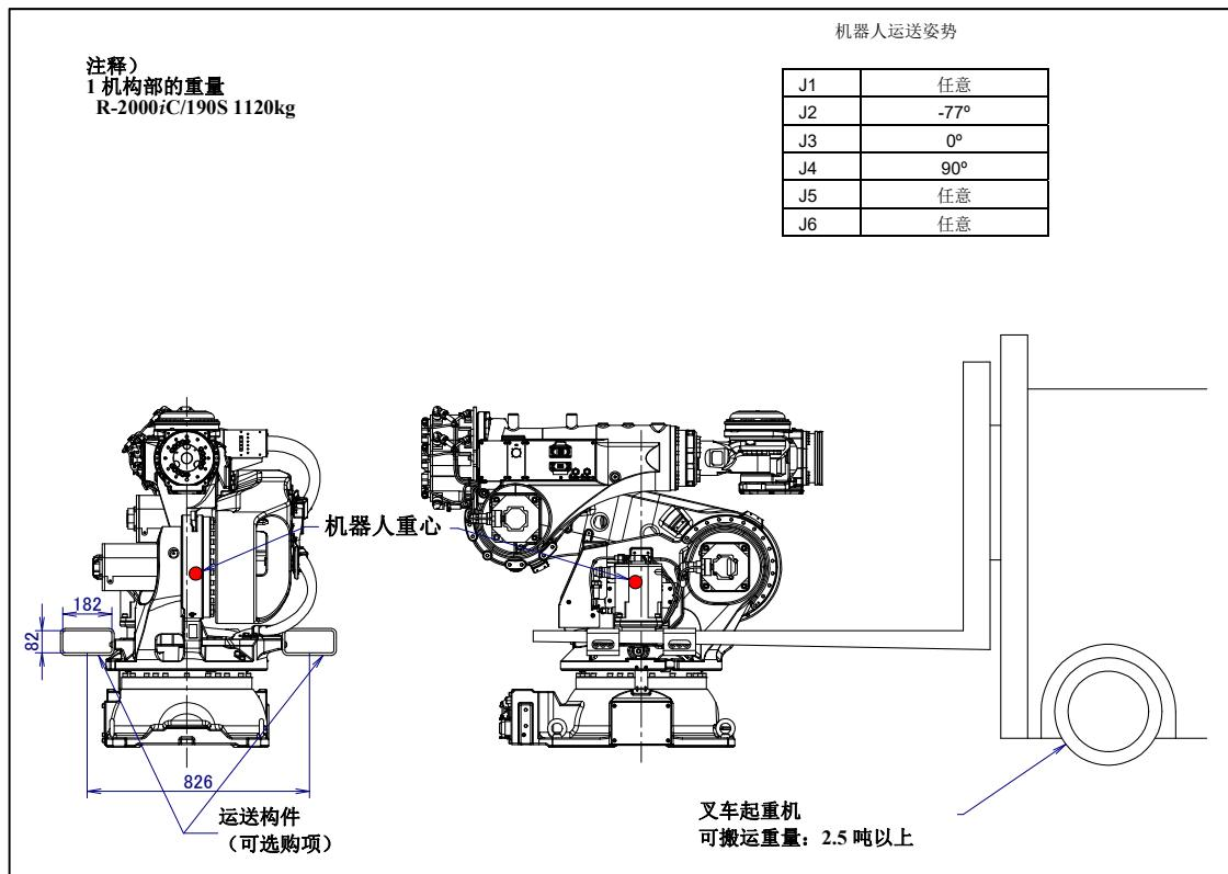
图 1.1 (u) 采用叉车搬运 (R-2000iC/190S J2 机座类型)
