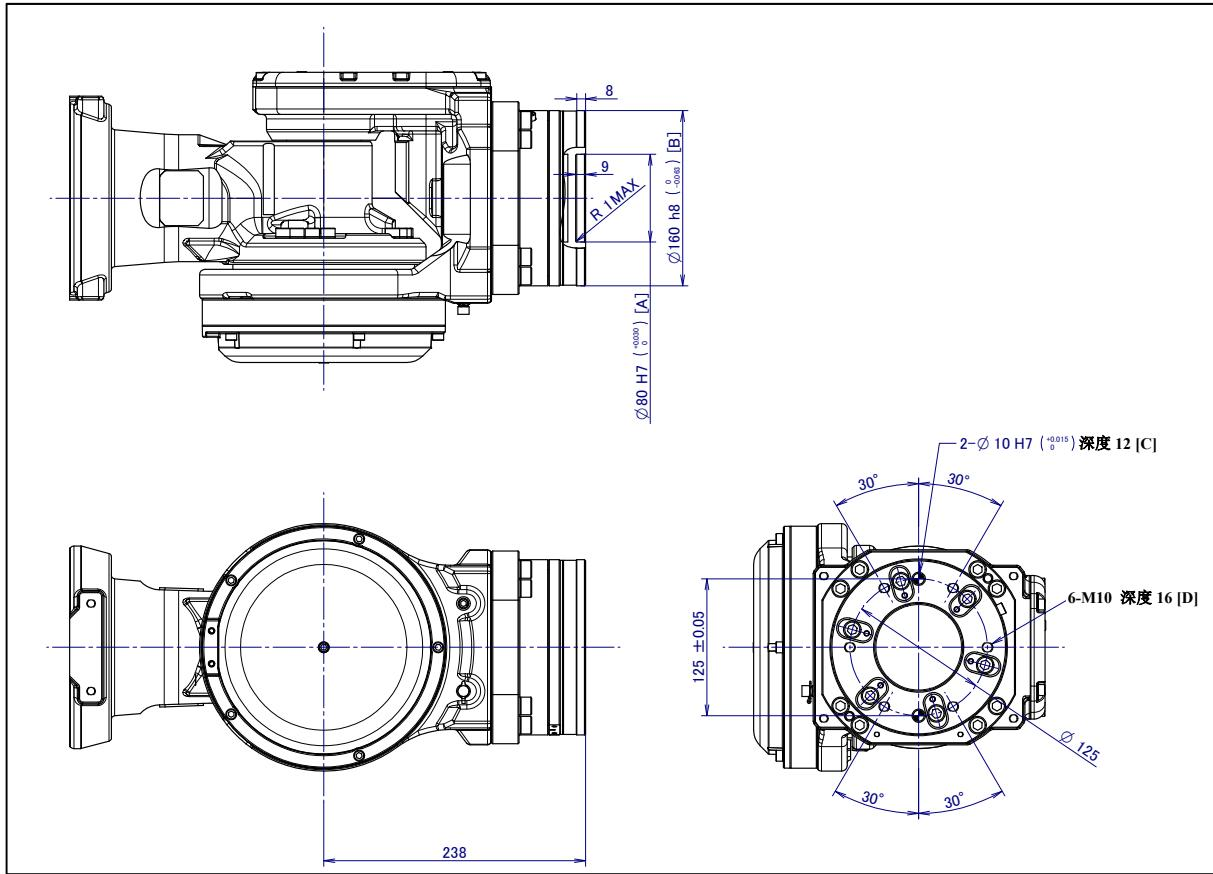
图 4.1 (b) 末端执行器安装面(绝缘 ISO 法兰盘 A05B-1329-H151) (R-2000iC/165F/210F/240F/125L/220U/165R/210R)
