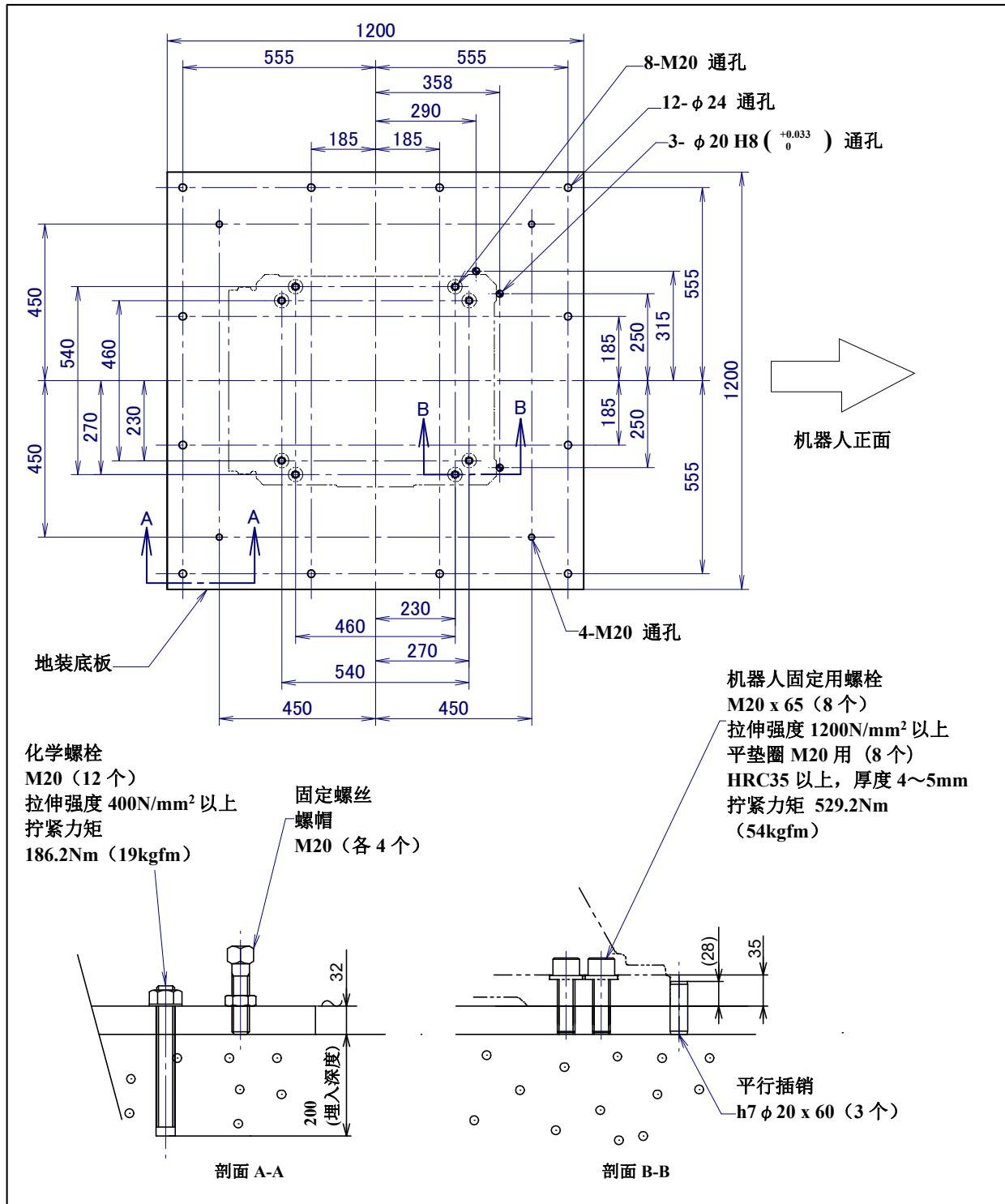
图 1.2.1 (b) 具体安装例 II (R-2000iC/165F/210F/240F/125L/220U/165R/210R)
