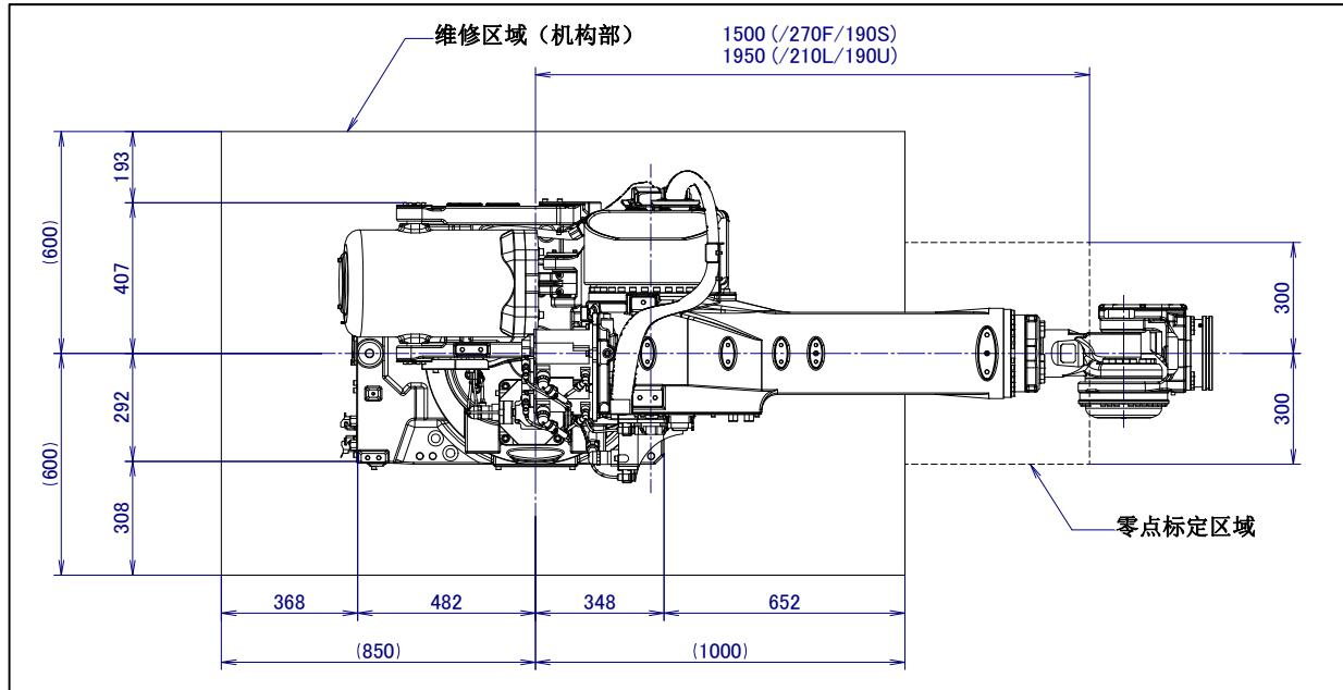
图 1.3 (d) 维修空间的布局图 (R-2000iC/270F/190S/210L/190U)
