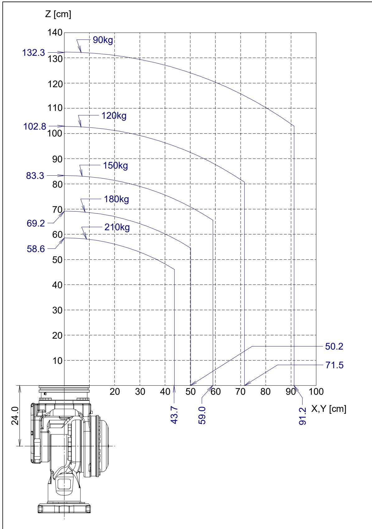
图 3.4 (q) 手腕部允许负载线图 (ISO 法兰盘)
