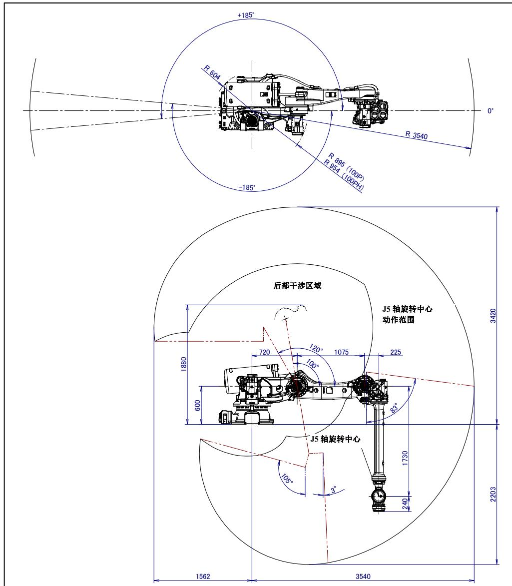
图 3.2 (e) 动作范围图 (R-2000iC/100P/100PH)
