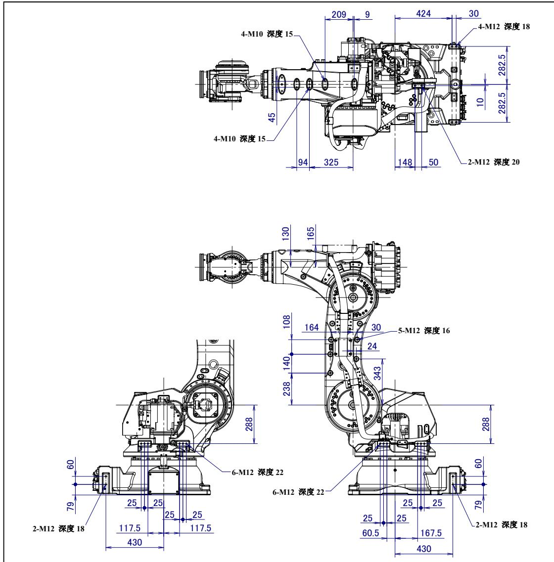
图 4.2 (g) 设备安装面尺寸 (R-2000iC/190S)
