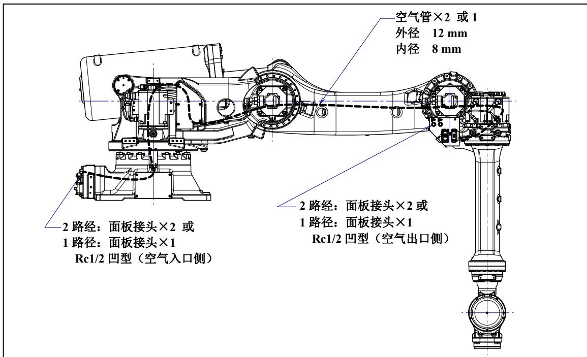
图 5.1 (b) 气压供应口 (可选购项) (R-2000iC/165R/210R/100P/100PH)
