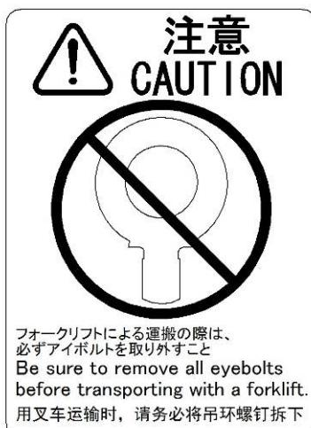
图 4(o) 搬运注意标签 (R-2000iC/165R/210R/100P/100PH/270R 用 J1 机座类型搬运部件可选购项时)
