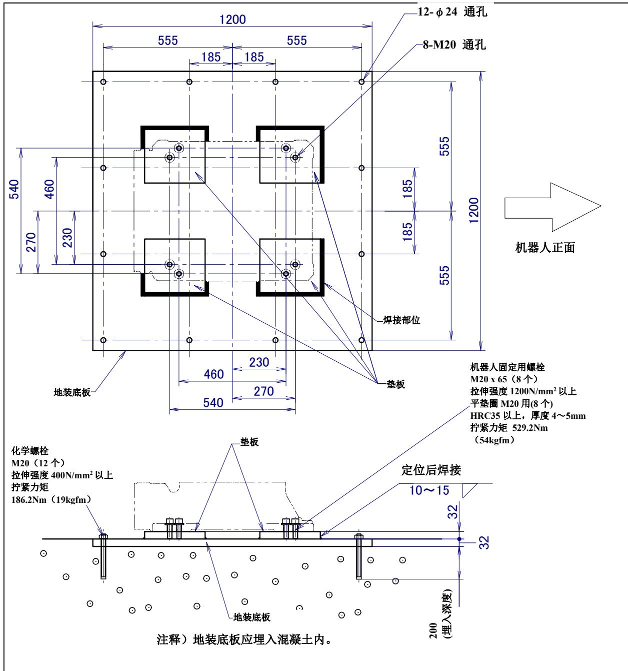
图 1.2.1 (a) 具体安装例 I(R-2000iC/165F/210F/240F/125L/220U/165R/210R)
