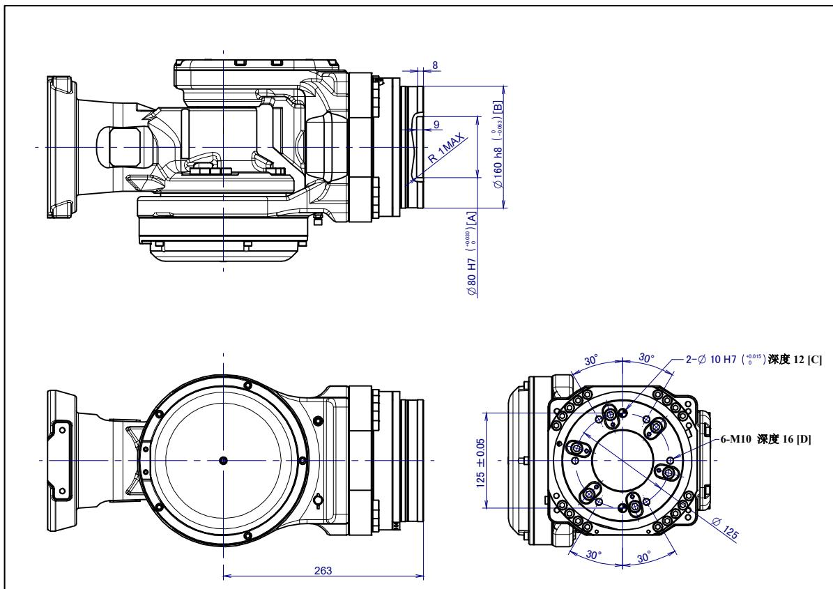
图 4.1 (e) 末端执行器安装面 (绝缘 ISO 法兰盘 A05B-1329-H151) (R-2000iC/100P/100PH)
