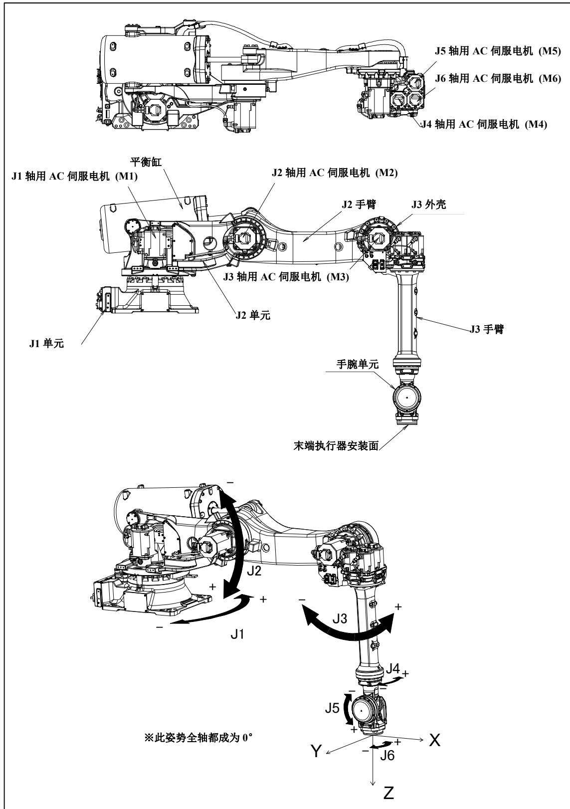
图 3.1 (b) 机构部的构成、各轴坐标和机械接口坐标 (R-2000iC/165R/210R/100P/100PH)
