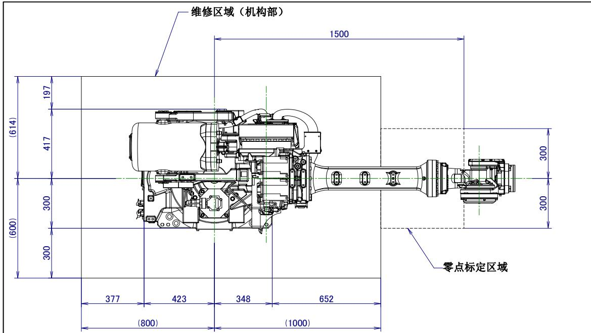
图 1.3 (a) 维修空间的布局图 (R-2000iC/165F/210F/240F/125L/220U)
