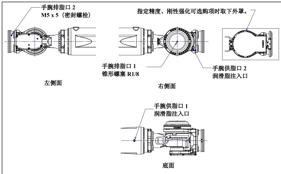
图 7.3.3 (i) 手腕的润滑脂的更换 (R-2000iC/270F/270R/190S/210L/190U)
