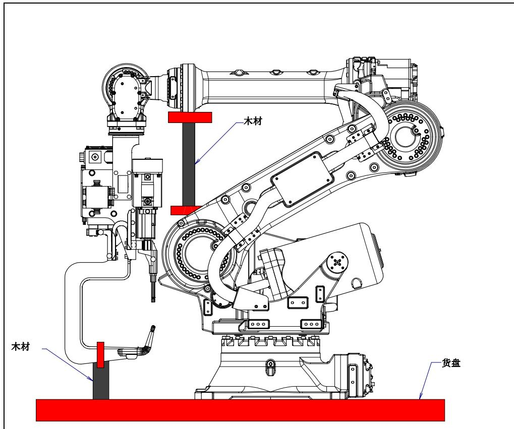
图 1.1.1 (a) 安装着末端执行器时搬运时的固定例
