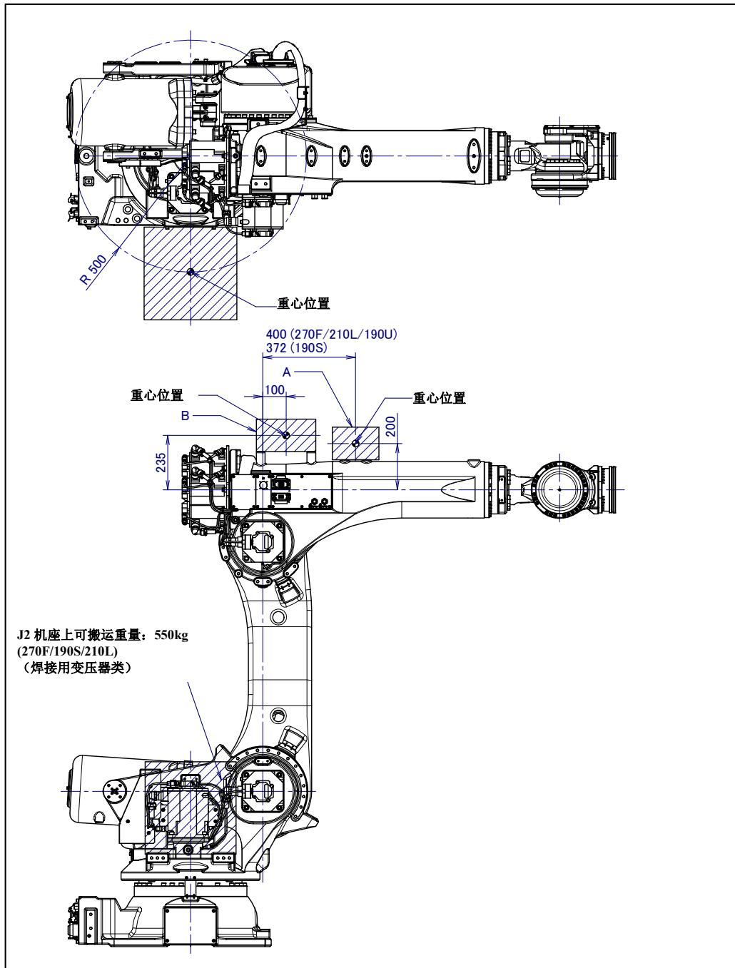
图 3.5 (d) J2 机座/J3 手臂部上的负载条件(R-2000iC/270F/190S/210L/190U)
