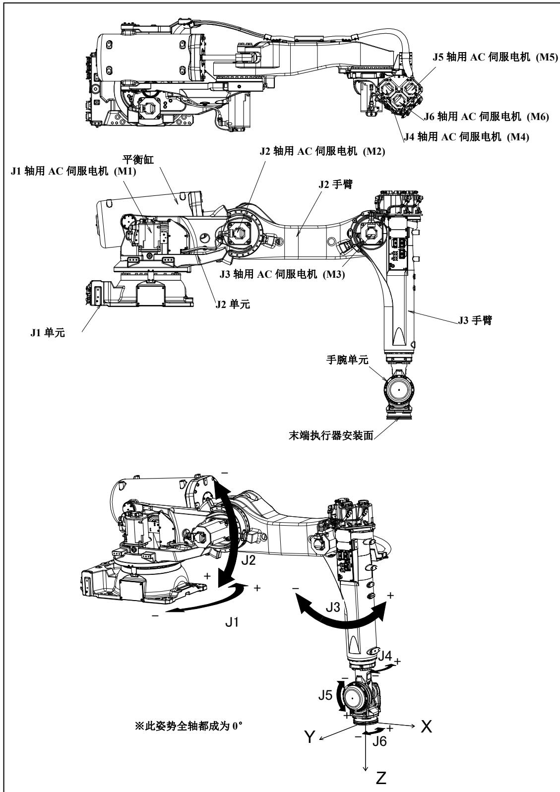
图 3.1 (d) 机构部的构成、各轴坐标和机械接口坐标(R-2000iC/270R)
