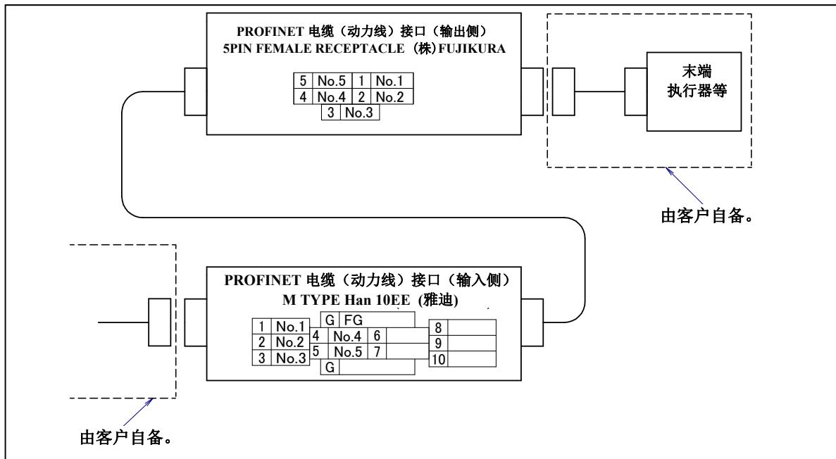
图 5.3 (ab) PROFINET 电缆（动力线）(PNP)接口的插针排列（可选购项）
