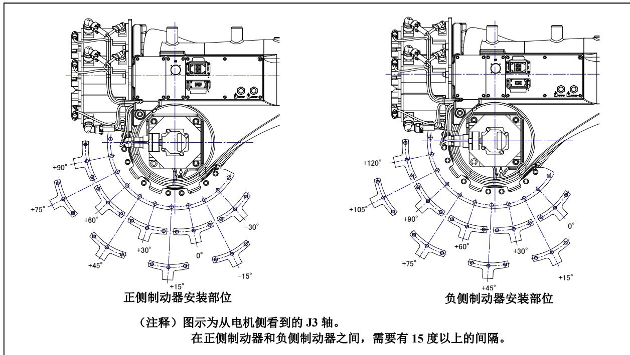
图 6.2.1 (w) J3 轴机械式可变制动器的安装 (2/2)
