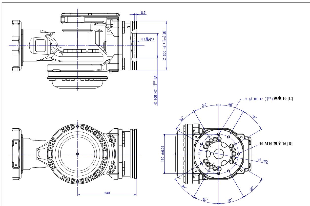
图 4.1 (g) 末端执行器安装面(ISO 法兰盘 A05B-1333-H153) (R-2000iC/270F/270R/190S/210L/190U)
