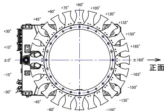
$$(2) \text{ 限制角度 } 5^\circ + 15^\circ \times N \quad (N = 0, \pm 1, \pm 2, \dots)$$
