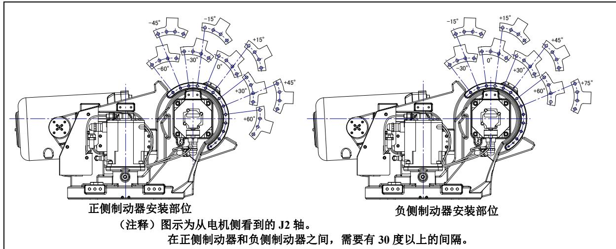
图 6.2.1 (k) J2 轴机械式可变制动器的安装 (2/2)
