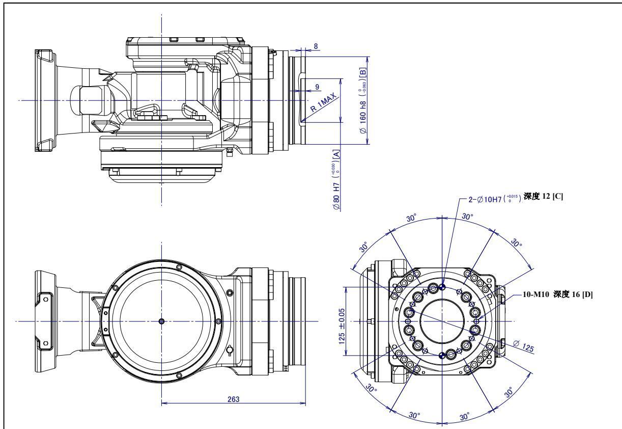
图 4.1 (f) 末端执行器安装面(绝缘 ISO 法兰盘 A05B-1333-H153) (R-2000iC/100P/100PH)
