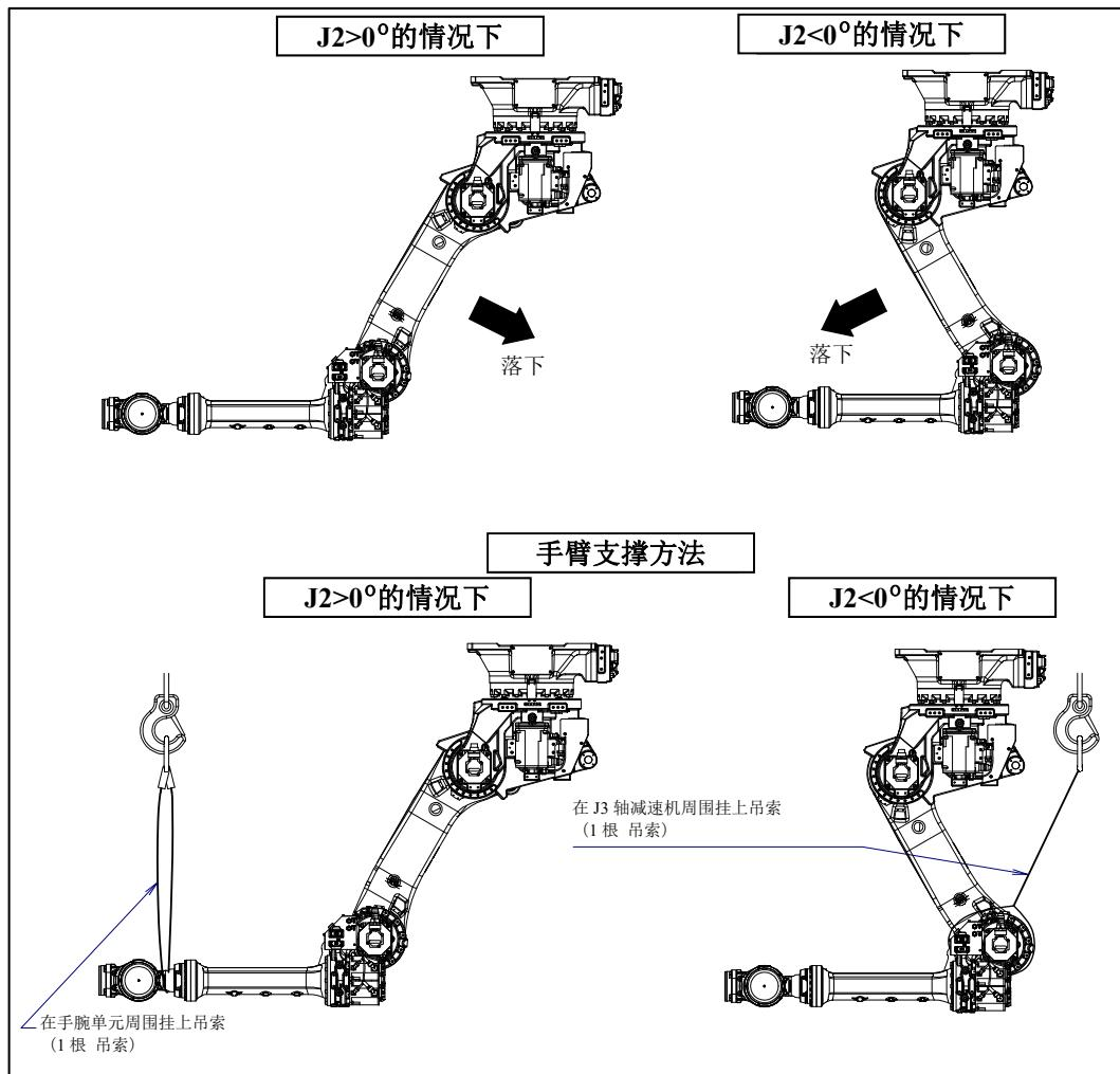
图 3 (c) 解除 J2 轴的电机制动器造成的手臂动作和事先采取的措施例
