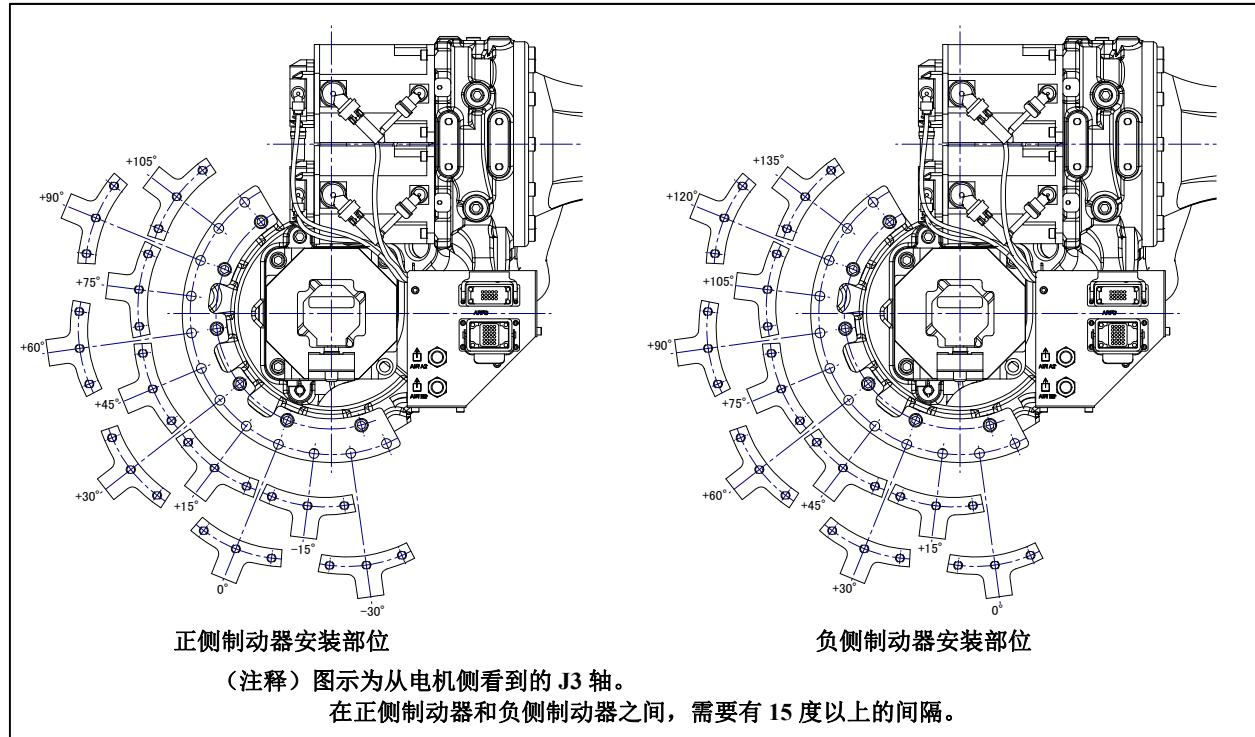
图 6.2.1 (t) J3 轴机械式可变制动器的安装 (3/3)
