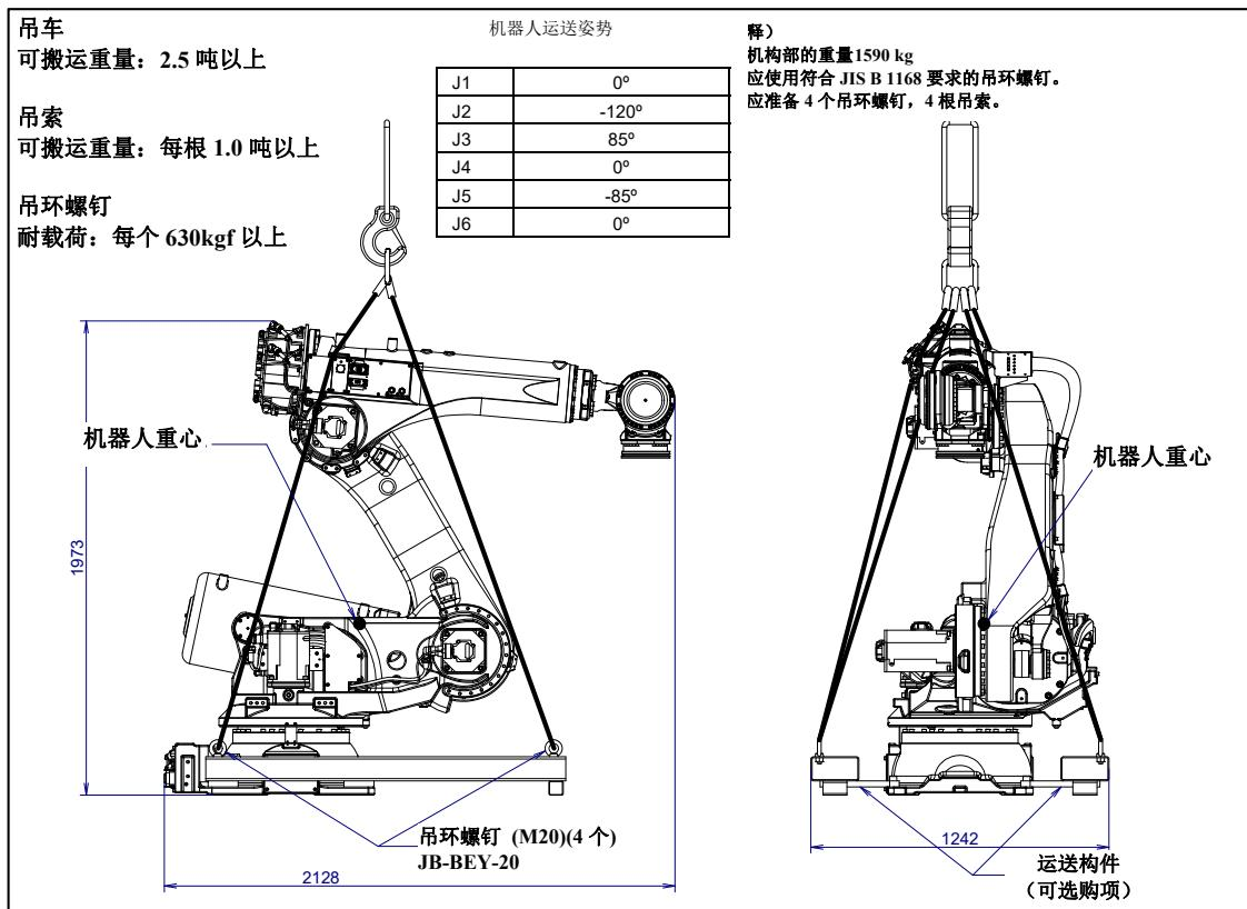
图 1.1 (e) 采用吊车搬运 (R-2000iC/270R J1 机座类型)
