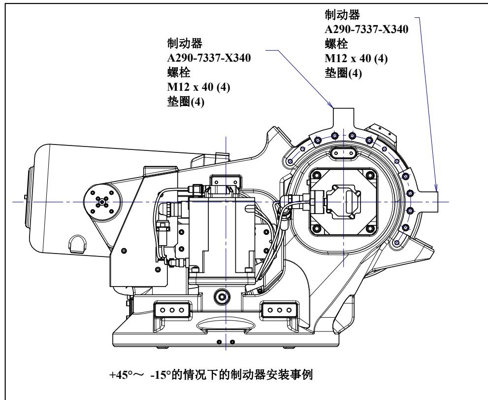
图 6.2.1 (n) J2 轴机械式可变制动器的安装 (1/3)
