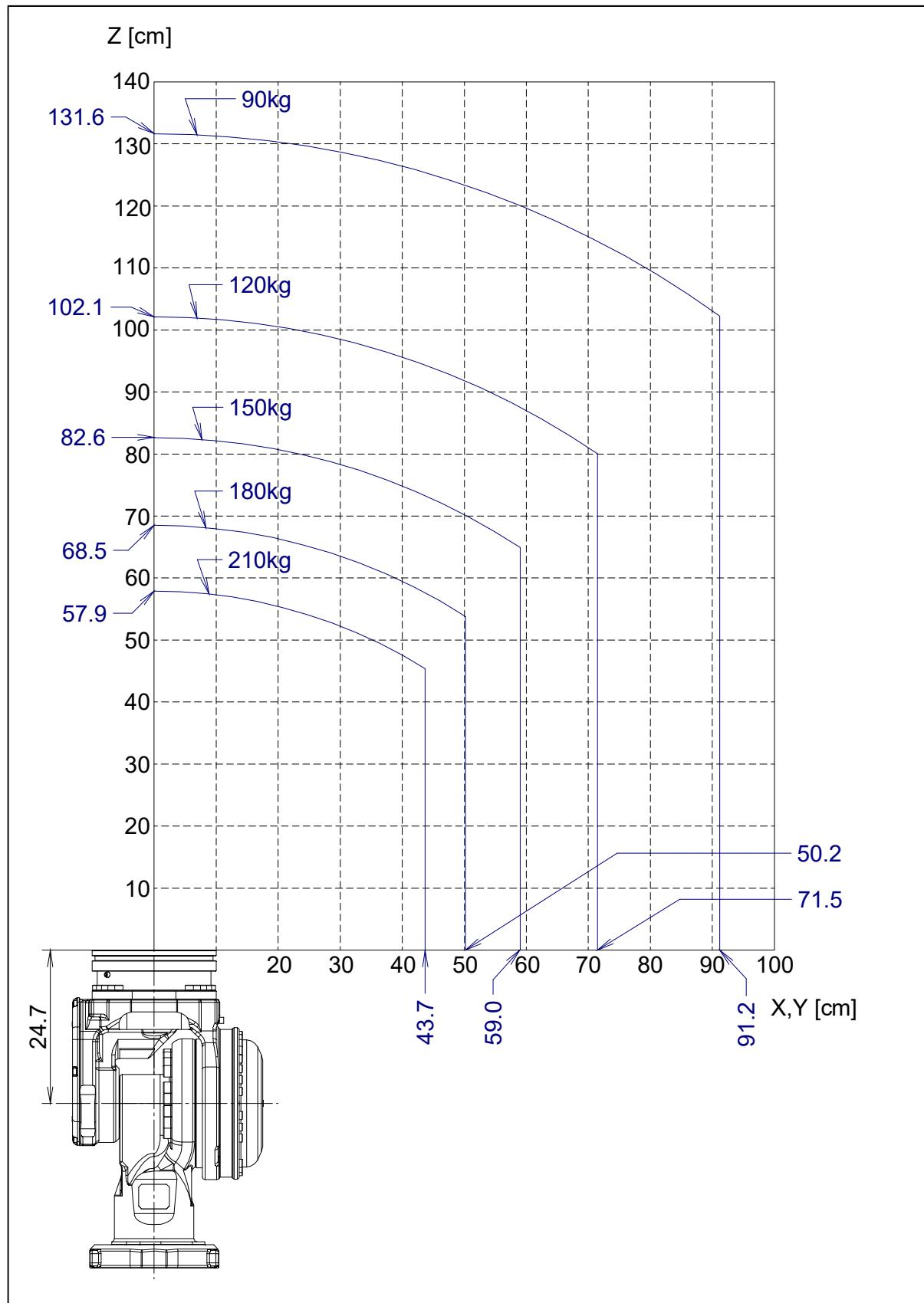
图 3.4 (r) 手腕部允许负载线图 (绝缘 ISO 法兰盘)
