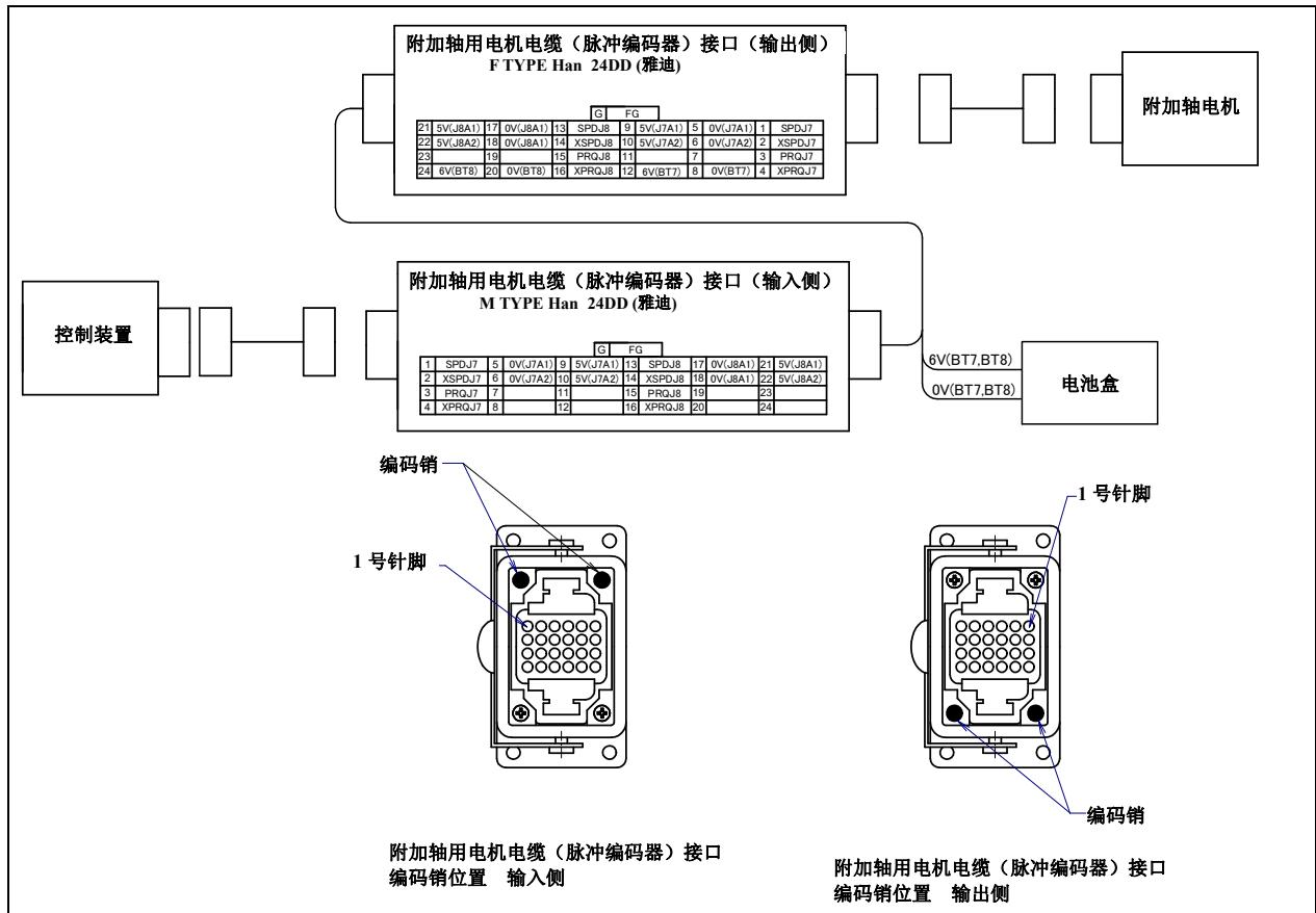
图 5.3(w) 附加轴用电机电缆（脉冲编码器线）(ARP)接口的插针排列和编码销配置位置（可选购项）
