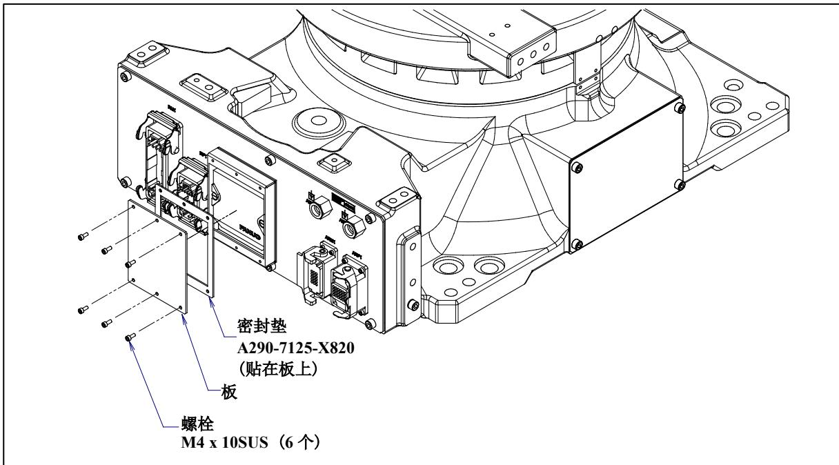
图 7.3.2 (b) 电池盖板的拆除 (指定防尘防液强化可选购项时)
