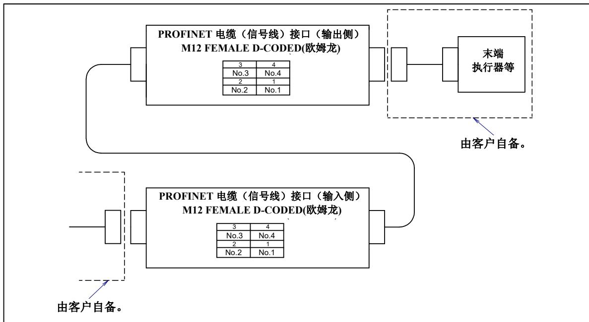
图 5.3 (aa) PROFINET 电缆（信号线）(PNS)接口的插针排列（可选购项）
