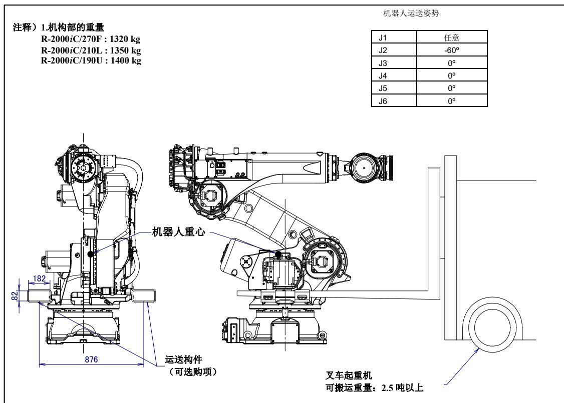
图 1.1 (q) 采用叉车搬运 (R-2000iC/270F/210L/190U J2 机座类型)
