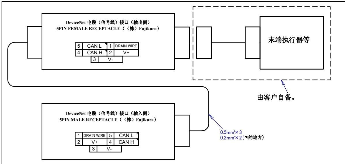
图 5.3 (u) DeviceNet 电缆（信号线）(DS)接口的插针排列（可选购项）
