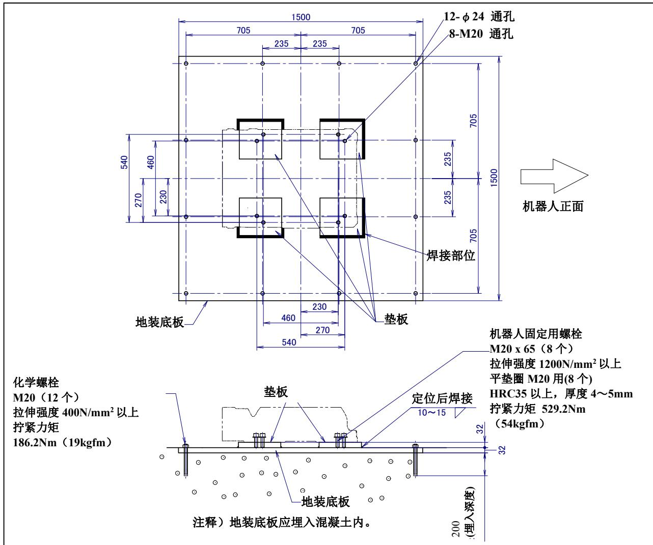
图 1.2.1 (d) 安装方法 I (R-2000iC/100P/100PH/270F/270R/190S/210L/190U)
