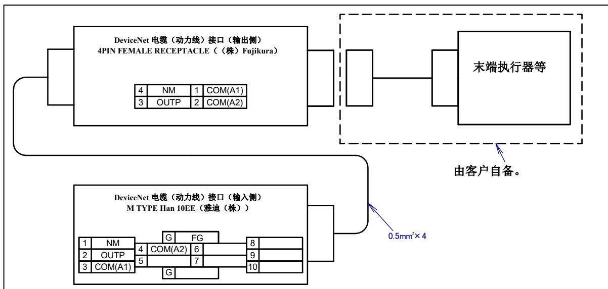
图 5.3 (v) DeviceNet 电缆（动力线）(DP)接口的插针排列（可选购项）
