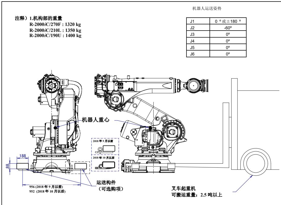
图 1.1 (p) 采用叉车搬运 (R-2000iC/270F/210L/190U J1 机座类型)
