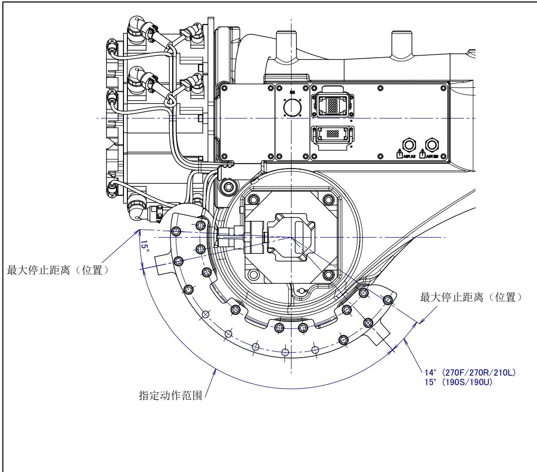
图 6.2.3 (f) J3 轴机械式可变制动器的最大停止距离 (位置)
