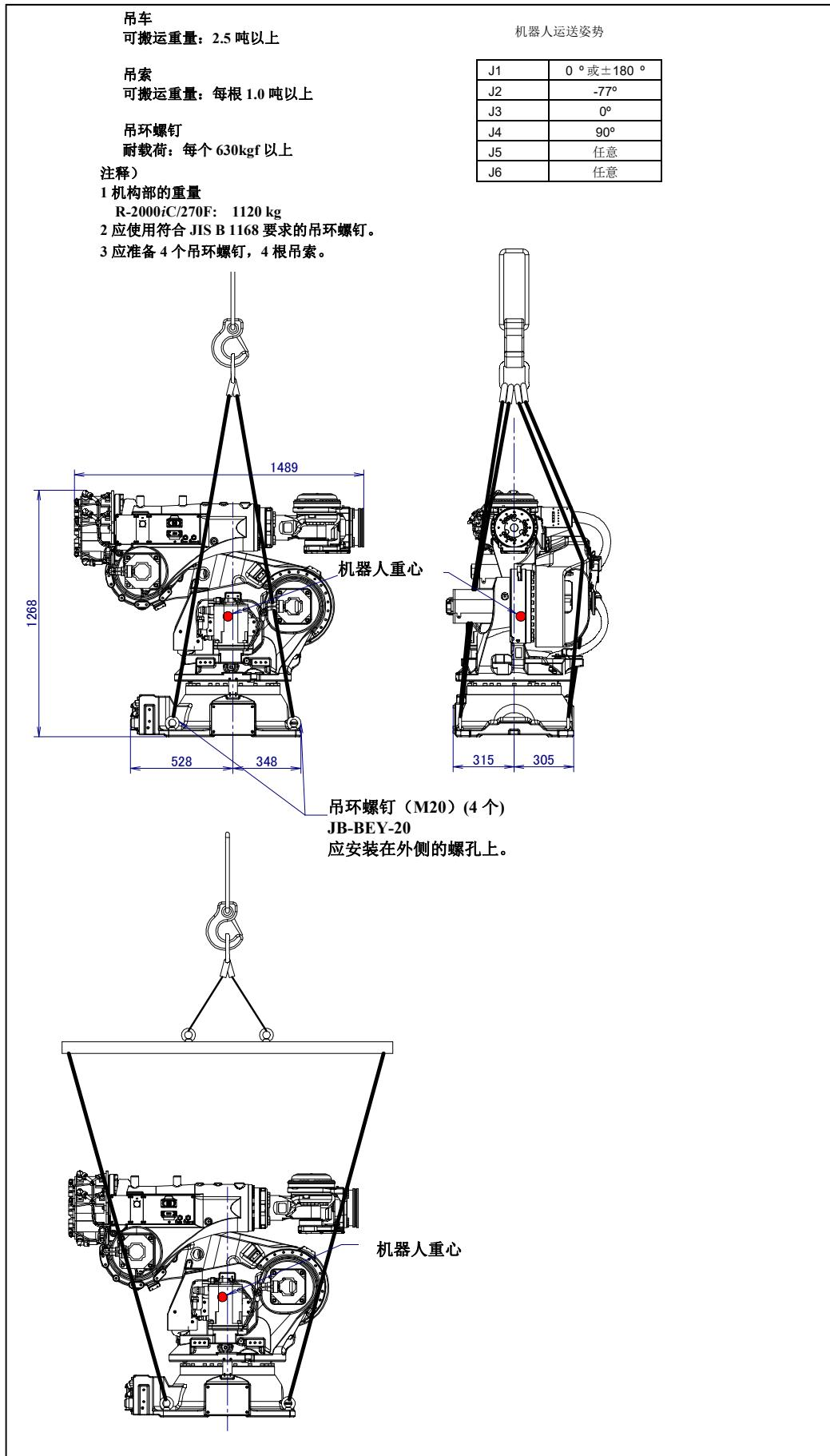
图 1.1 (j) 采用吊车搬运 (R-2000iC/190S)
