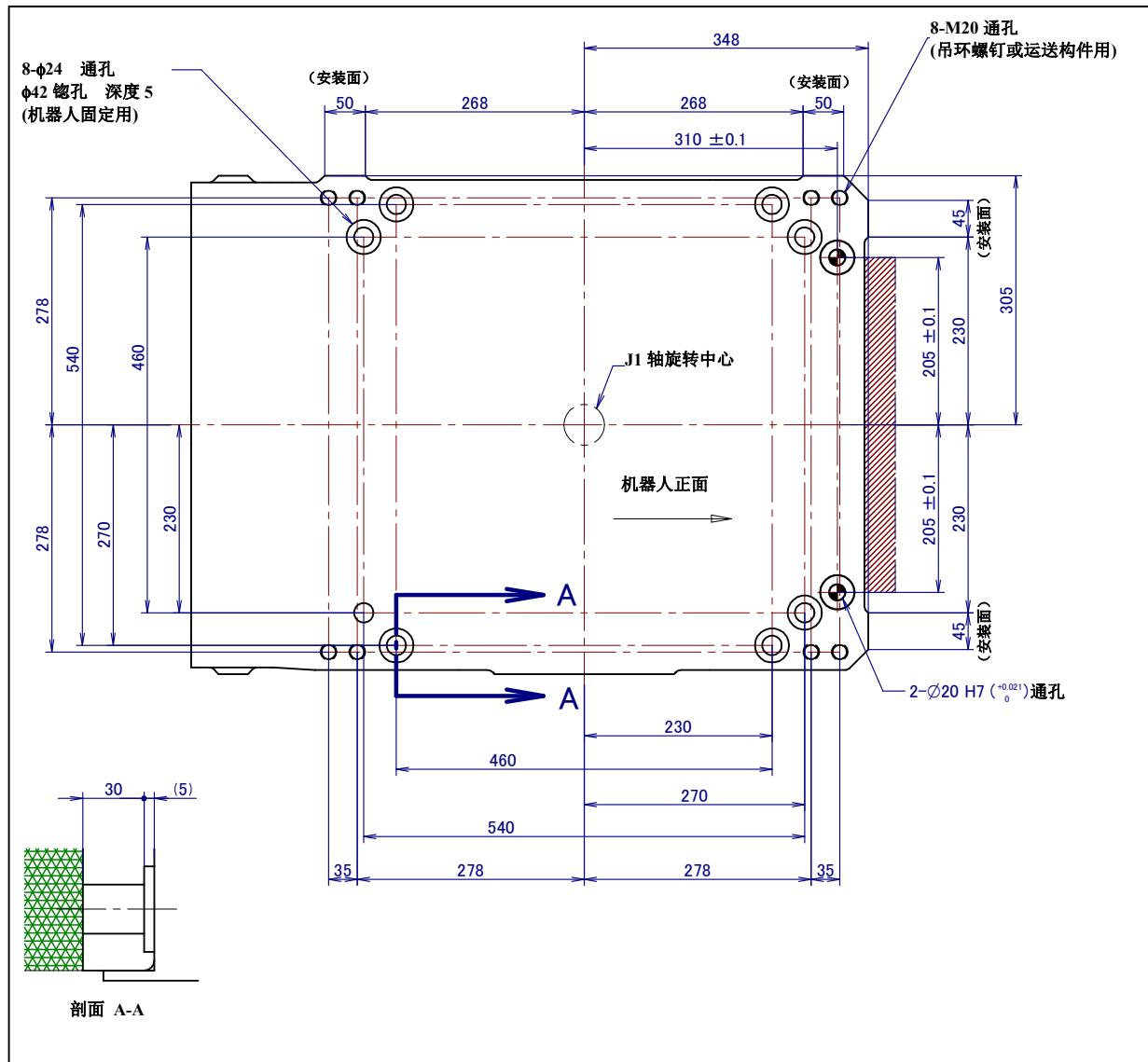
图 1.2 (b) 机器人机座尺寸(R-2000iC/100P/100PH/270F/270R/190S/210L/190U)
