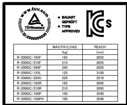
图 4 (i) 回转半径、可搬运重量标签 (例: R-2000iC/165F/210F/240F/125L/220U/165R/210R/100P/100PH)
