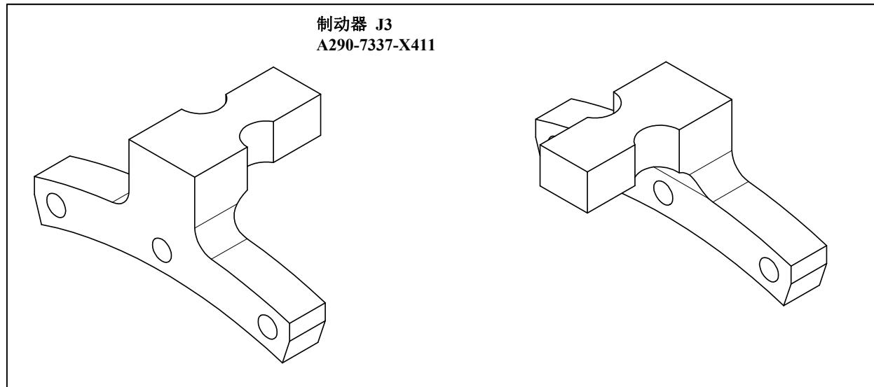
图 6.2.1 (u) J3 轴机械式可变制动器 (可选购项)
