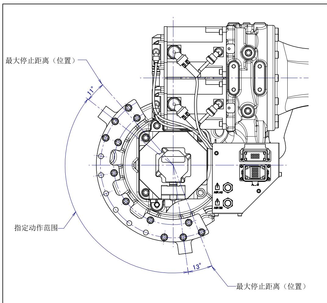
图 6.2.3 (e) J3 轴机械式可变制动器的最大停止距离 (位置)
