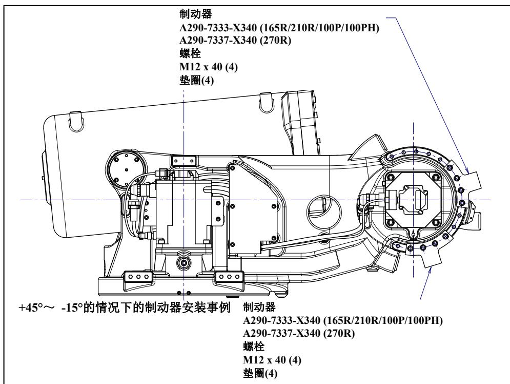
图 6.2.1 (l) J2 轴机械式可变制动器的安装 (1/2)
