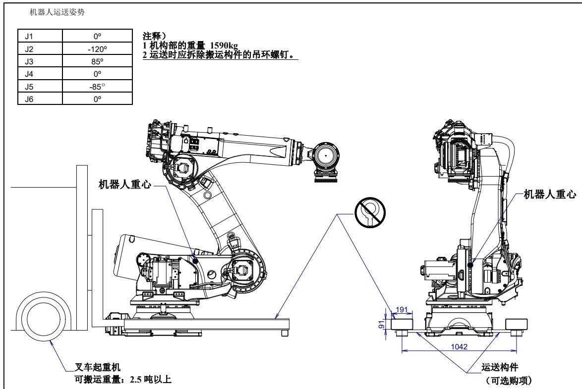
图 1.1 (r) 采用叉车搬运 (R-2000iC/270R J1 机座类型)
