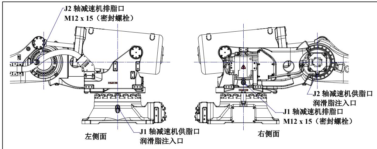
图 7.3.3 (b) J1/J2 轴减速机的润滑脂的更换(R-2000iC/165R/210R)
