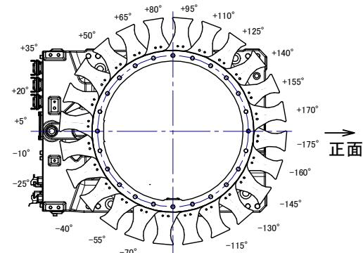
**图 6.2.1 (f) J1 轴机械式可变制动器的安装 (2/3)**
