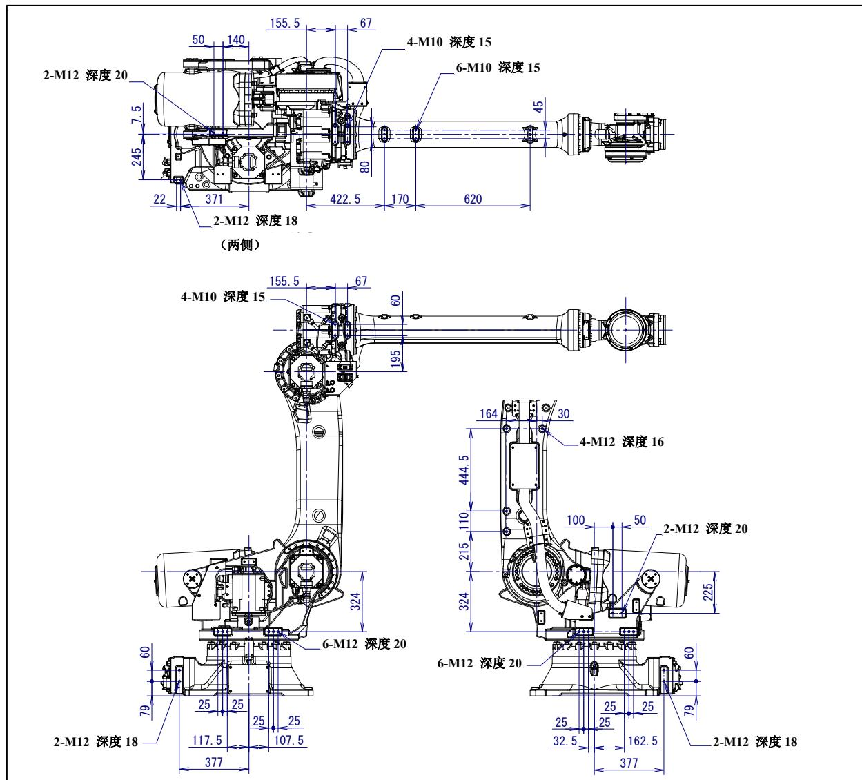
图 4.2 (b) 设备安装面尺寸 (R-2000iC/125L)
