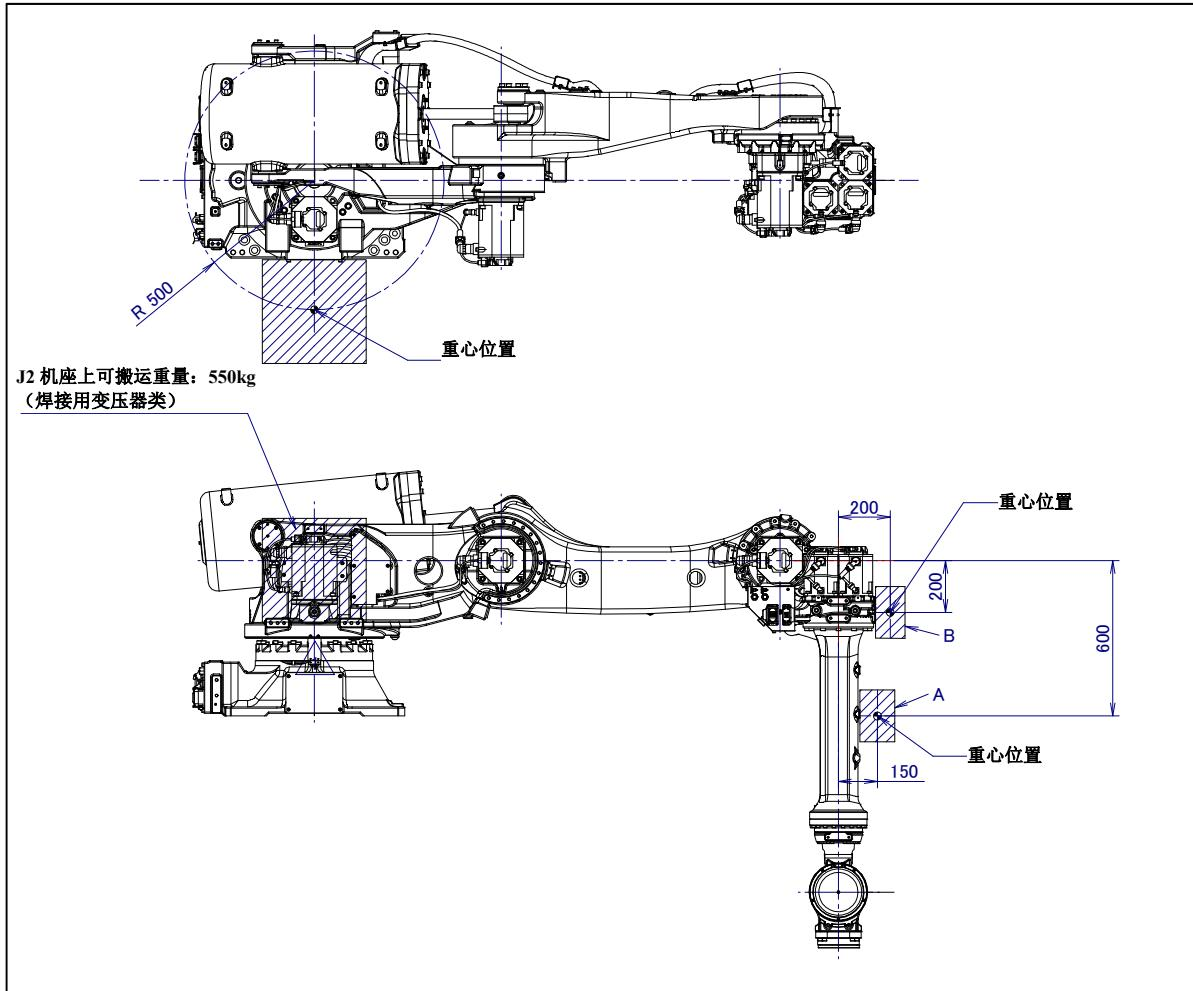
图 3.5 (c) J2 机座/J3 手臂部/J3 外壳上的负载条件(R-2000iC/165R/210R/100P/100PH)
