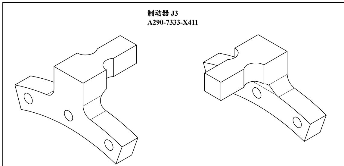
图 6.2.1 (q) J3 轴机械式可变制动器(可选购项)
