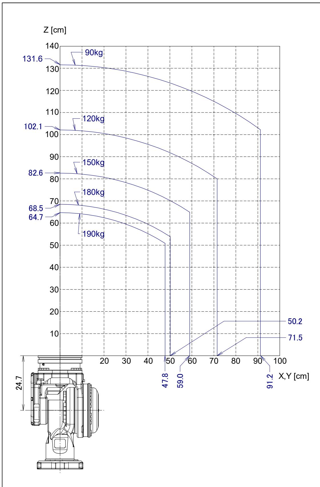
图 3.4 (t) 手腕部允许负载线图 (绝缘 ISO 法兰盘)
