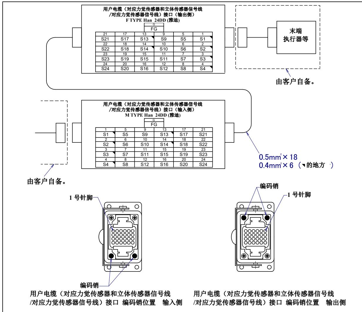
图 5.3 (s) 用户电缆（对应力觉传感器和立体传感器信号线）(ASi)（对应力觉传感器信号线）(ASH)
