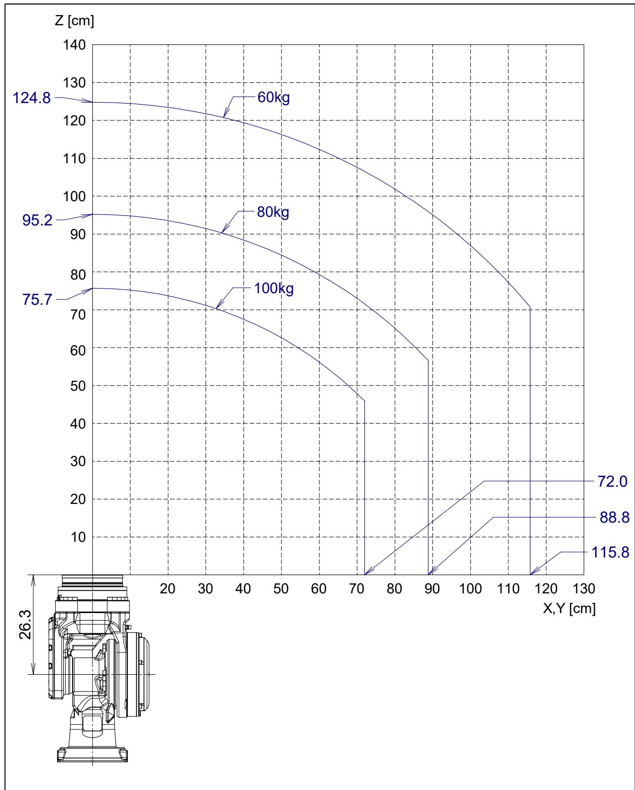
图 3.4 (j) 手腕部允许负载线图 (绝缘 ISO 法兰盘)
