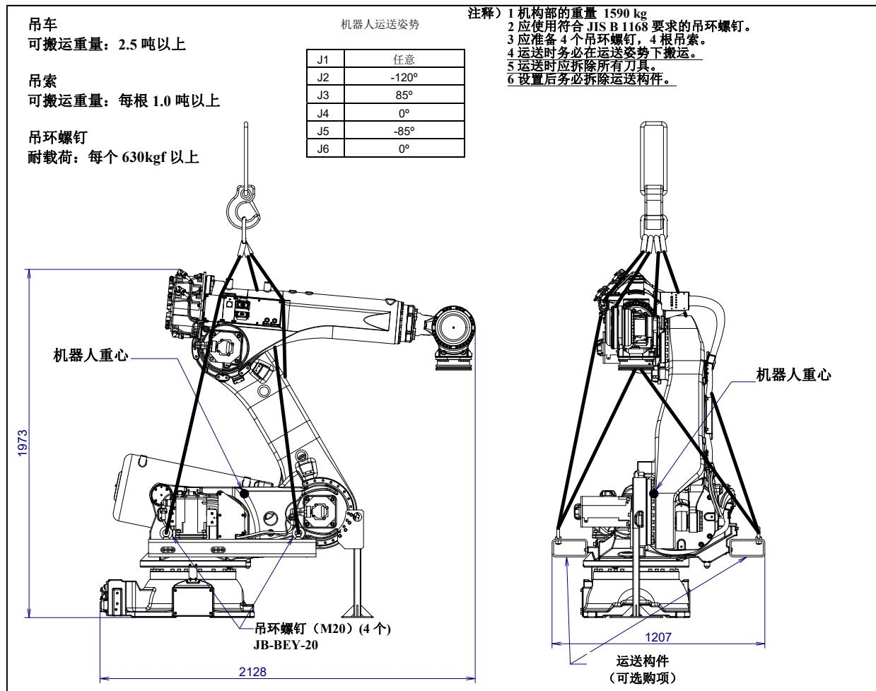
图 1.1 (g) 采用吊车搬运 (R-2000iC/270R J2 机座类型)
