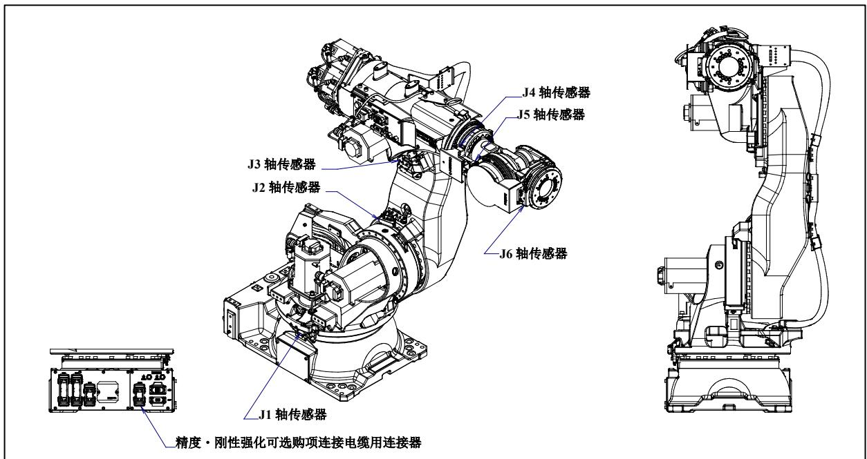
图 12 (a) 精度·刚性强化可选购项的构成
