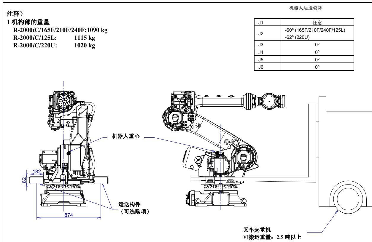
图 1.1 (m) 采用叉车搬运 (R-2000iC/165F/210F/240F/125L/220U J2 机座类型)
