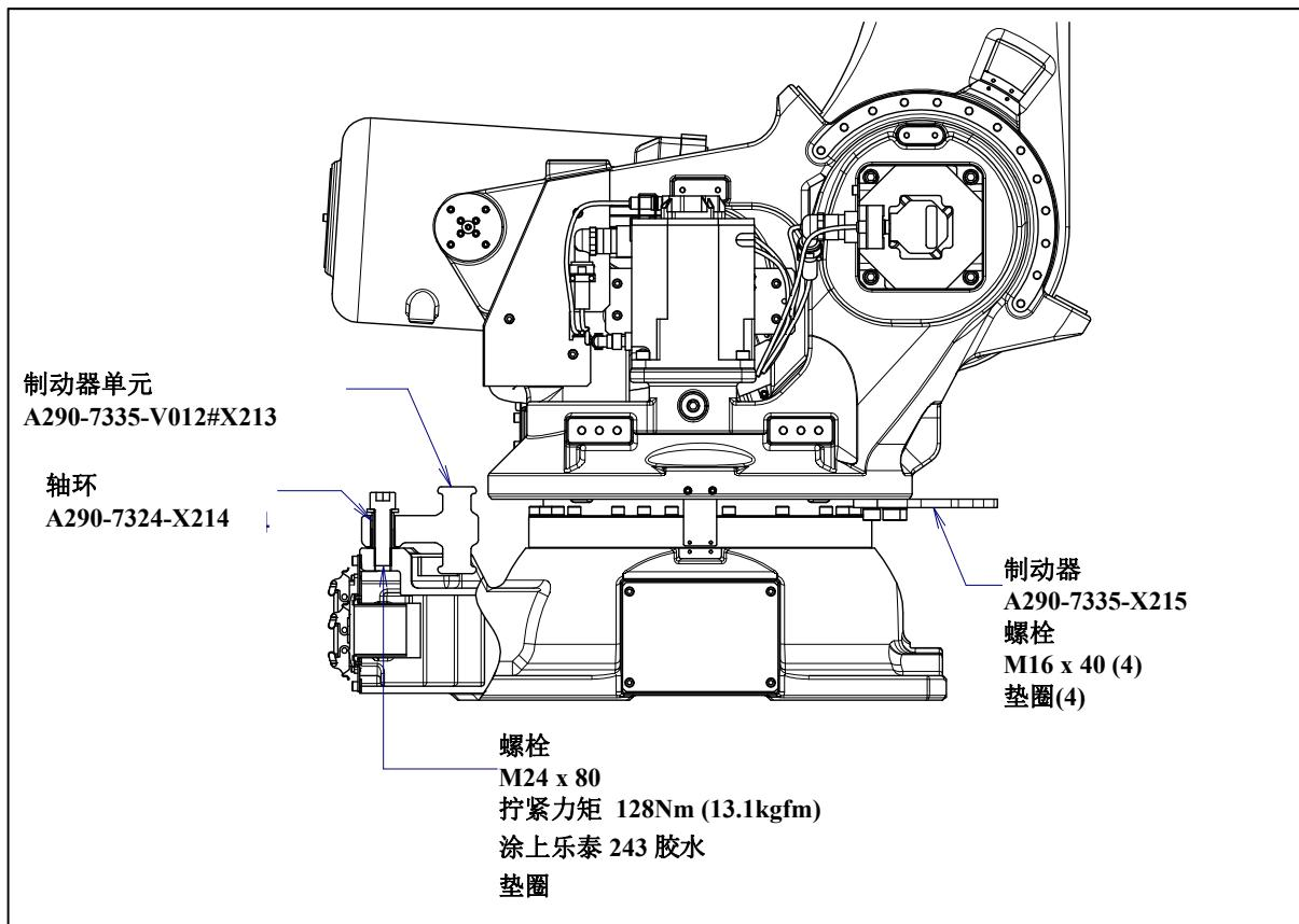
图 6.2.1 (e) J1 轴机械式可变制动器的安装 (1/3)
