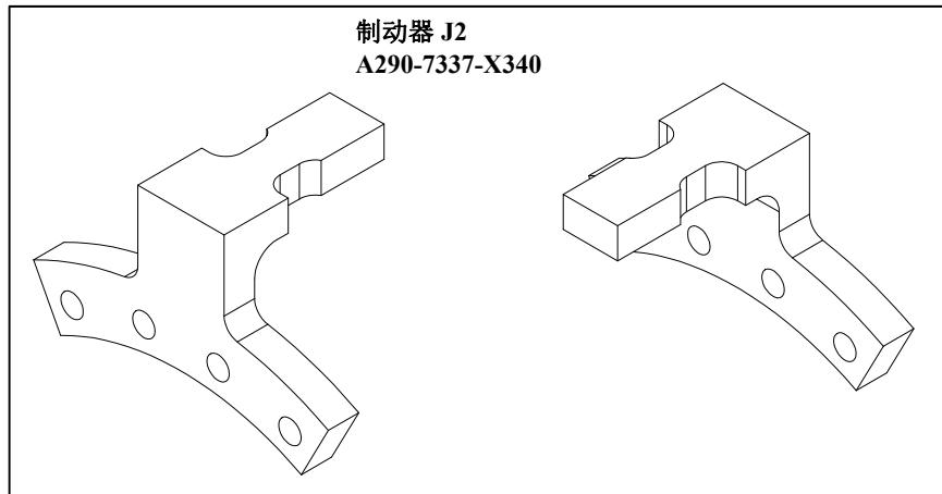
图 6.2.1 (i) J2 轴机械式可变制动器（可选购项）
