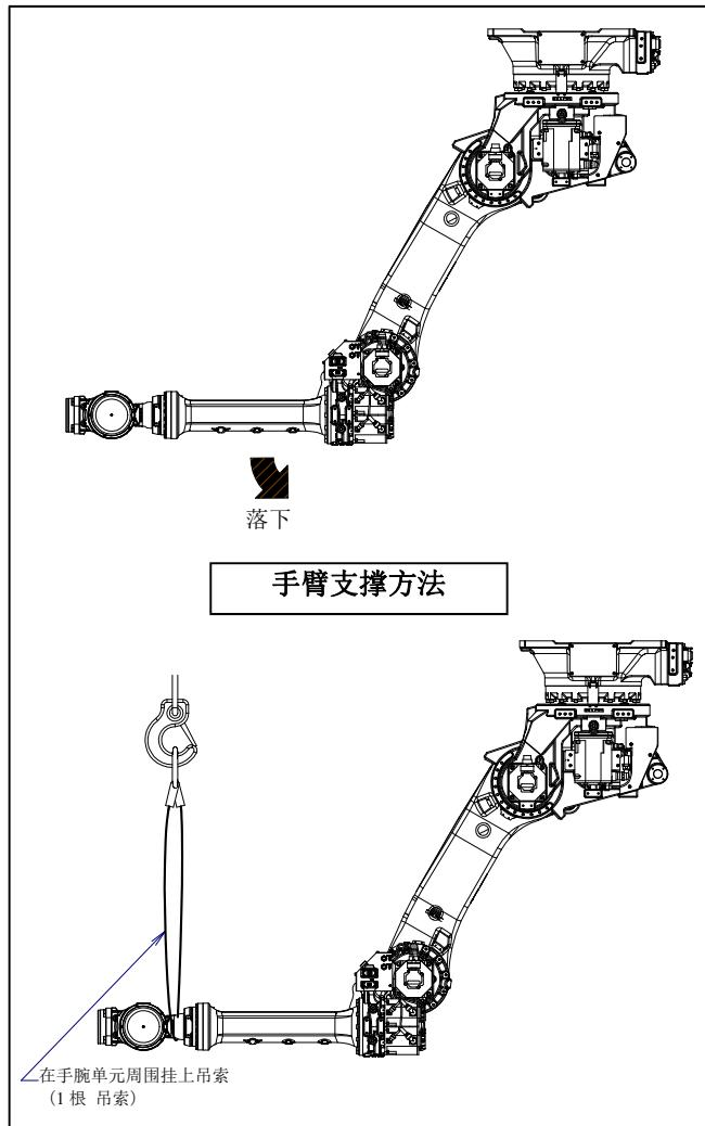
图 3 (e) 解除 J3 轴的电机制动器造成的手臂动作和事先采取的措施例
