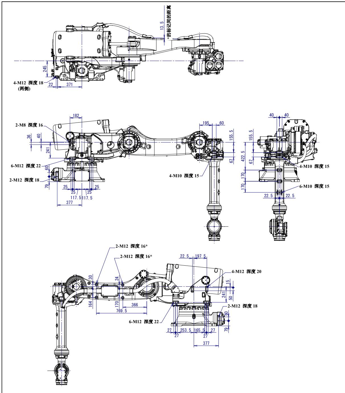
图 4.2 (c) 设备安装面尺寸 (R-2000iC/165R/210R)
