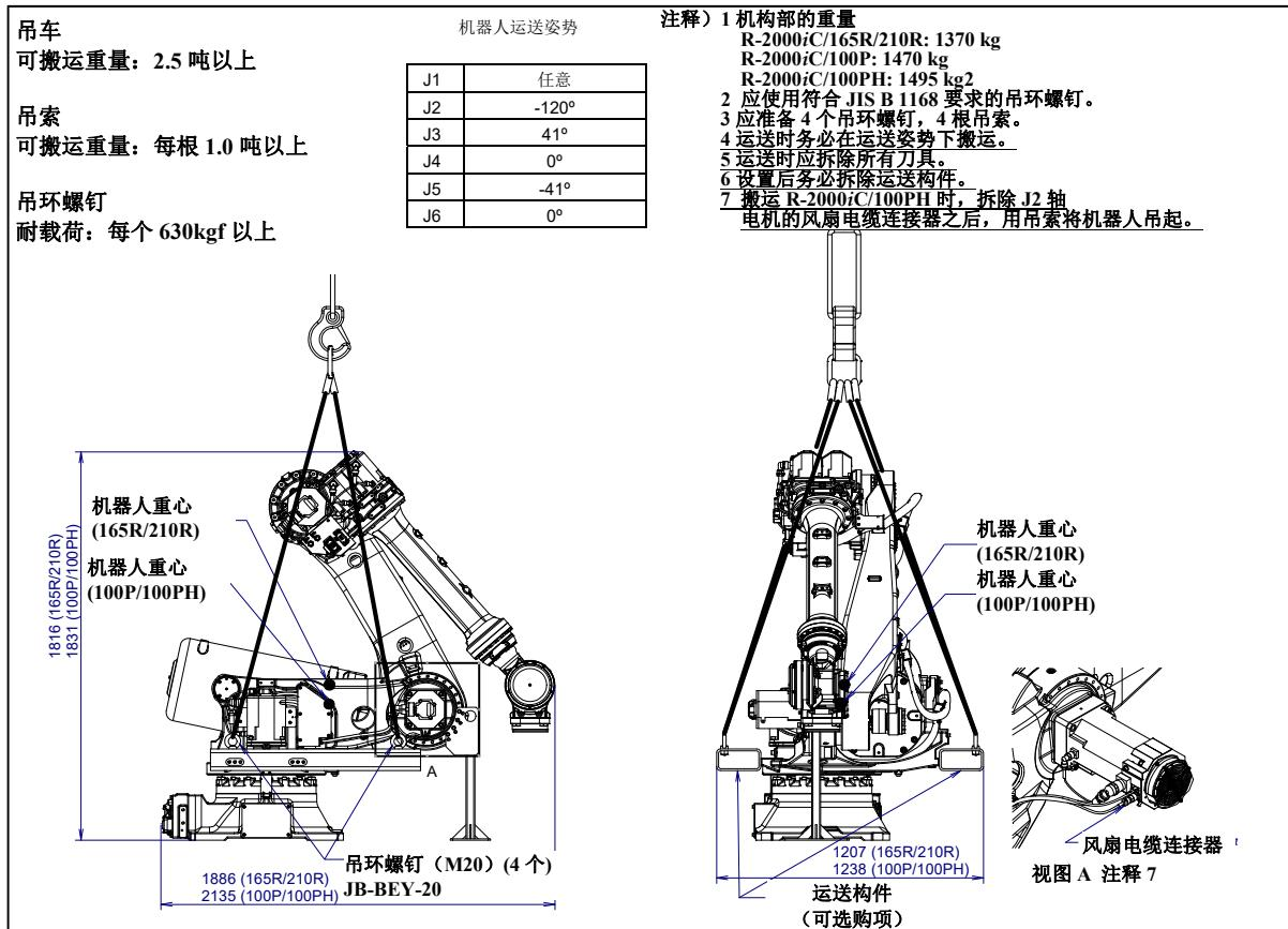
图 1.1 (f) 采用吊车搬运 (R-2000iC/165R/210R/100P/100PH J2 机座类型)
