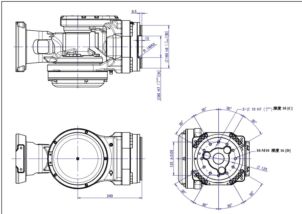
图 4.1 (d) 末端执行器安装面 (ISO 法兰盘) (R-2000iC/100P/100PH)
