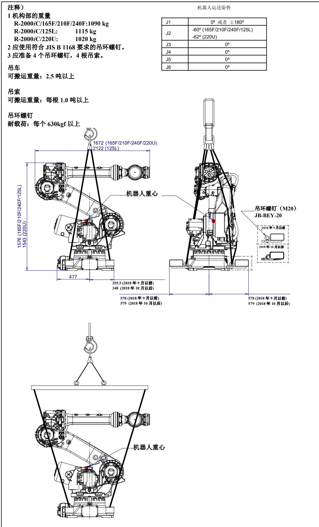
图 1.1 (c) 采用吊车搬运 (R-2000iC/165F/210F/240F/125L/220U 使用吊环螺钉)
