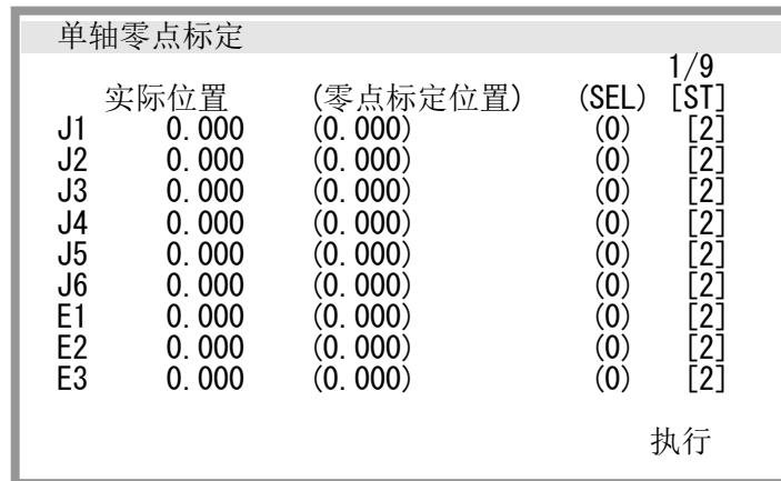
8 对于希望进行单轴零点标定的轴，将(SEL)设定为“1”。可以为每个轴单独指定(SEL)，也可以为多个轴同时指定(SEL)。
