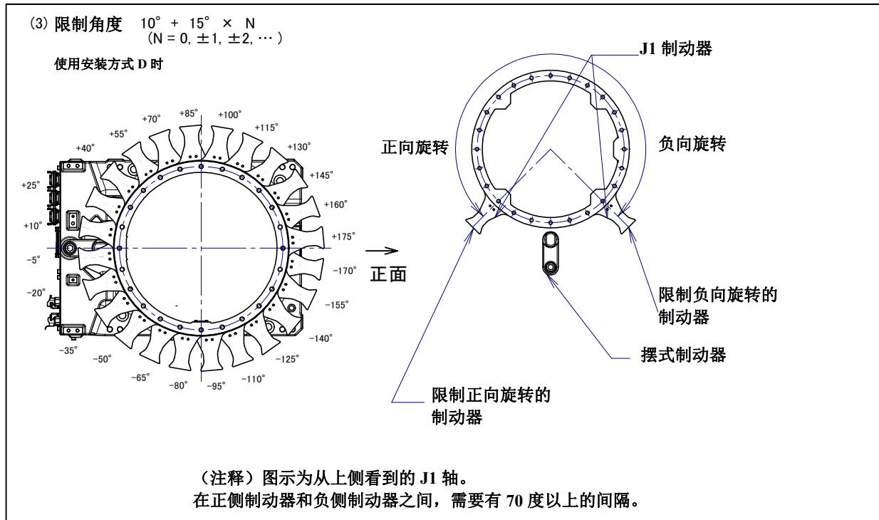
图 6.2.1 (g) J1 轴机械式可变制动器的安装 (3/3)
