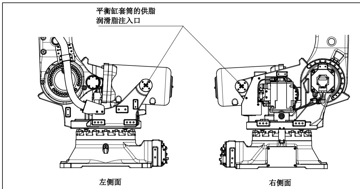
图 7.3.1 (a) 平衡缸套筒供脂部位
