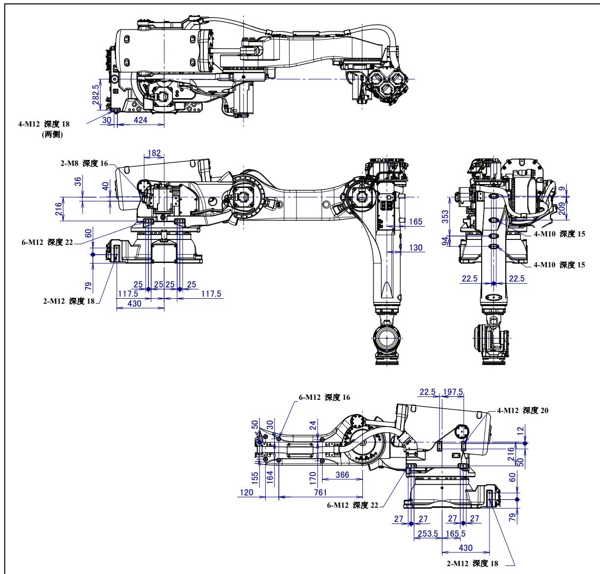
图 4.2 (f) 设备安装面尺寸(R-2000iC/270R)
