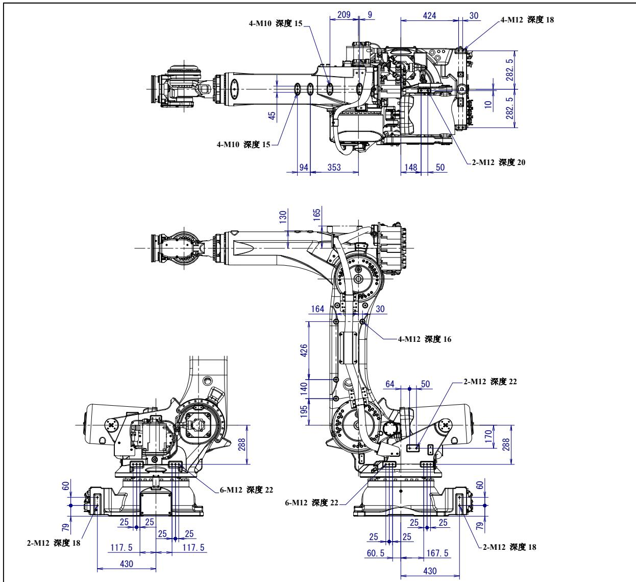
图 4.2 (e) 设备安装面尺寸(R-2000iC/270F/210L/190U)
