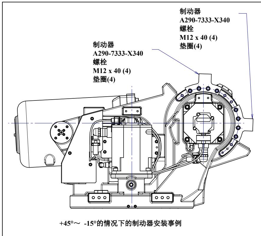
图 6.2.1 (j) J2 轴机械式可变制动器的安装 (1/2)
