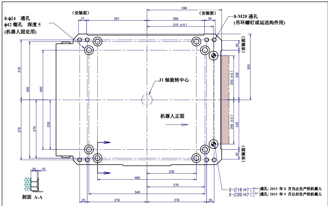
图 1.2 (a) 机器人机座尺寸 (R-2000iC/165F/210F/240F/125L/220U/165R/210R)
