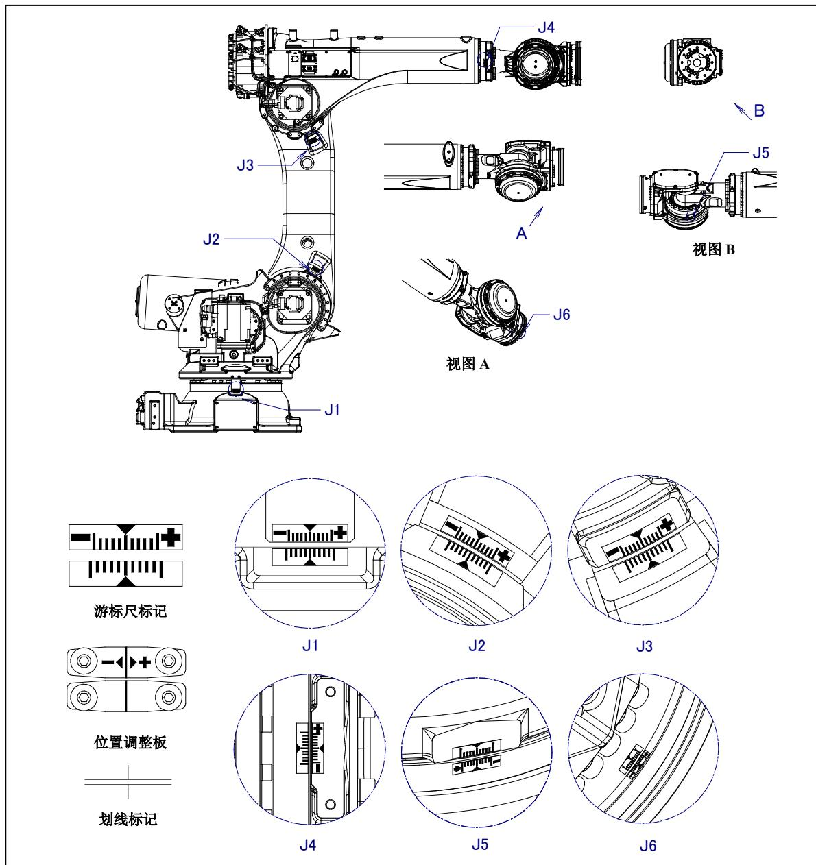
图 8.3 (c) 各轴的对合标记位置(R-2000iC/270F/270R/190S/210L/190U)
