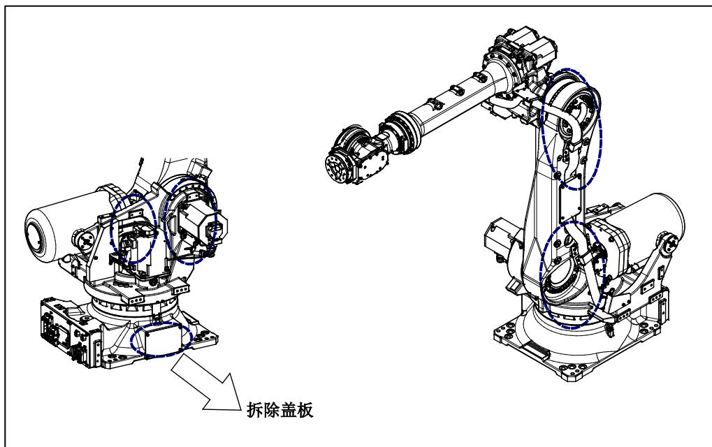
图 7.2.3 (a) 机构部内电缆的检修部位
