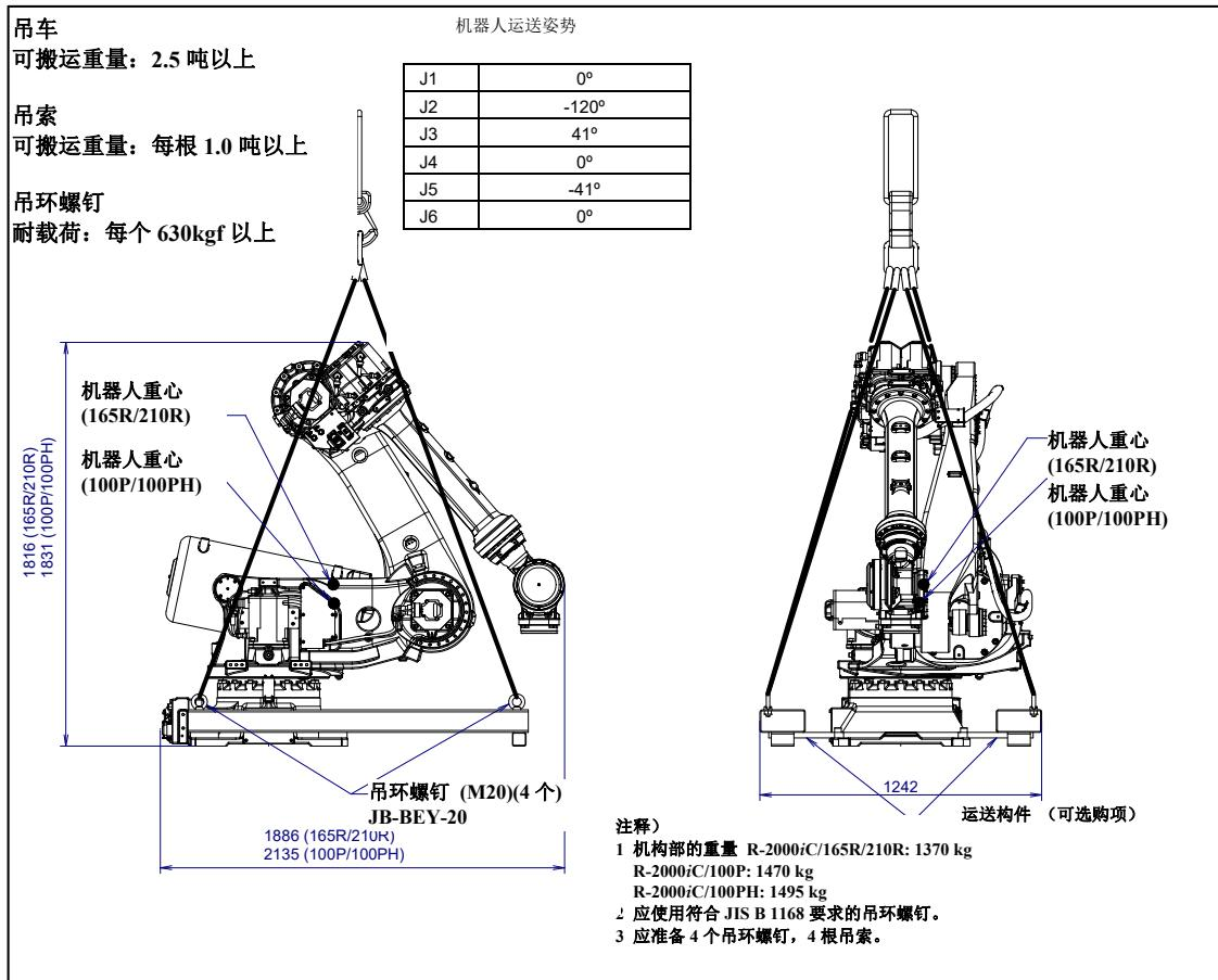
图 1.1 (d) 采用吊车搬运 (R-2000iC/165R/210R/100P/100PH J1 机座类型)
