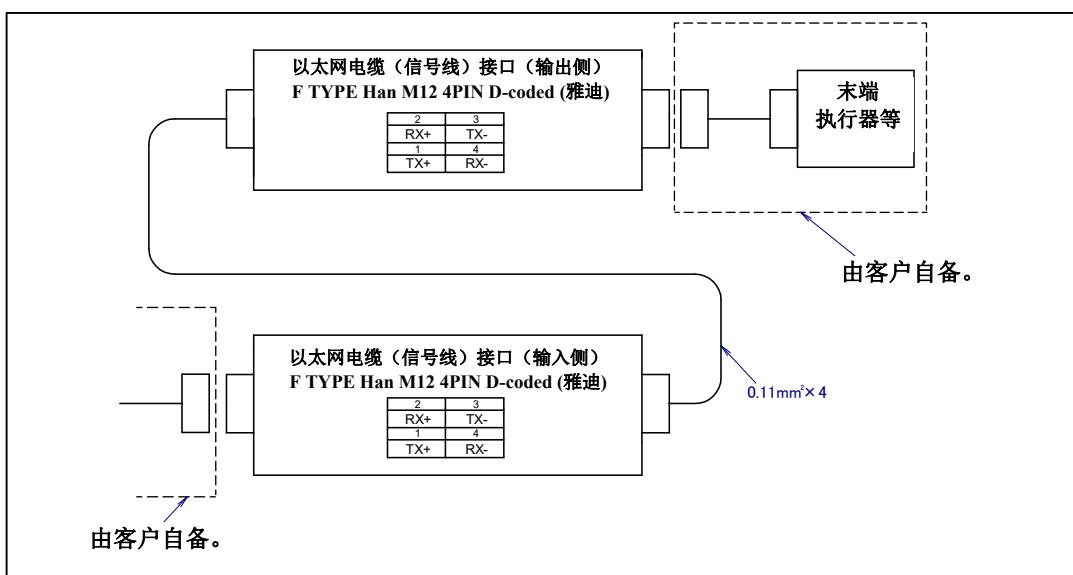
图 5.3 (y) 以太网电缆（信号线）(ES)接口的插针排列（可选购项）
