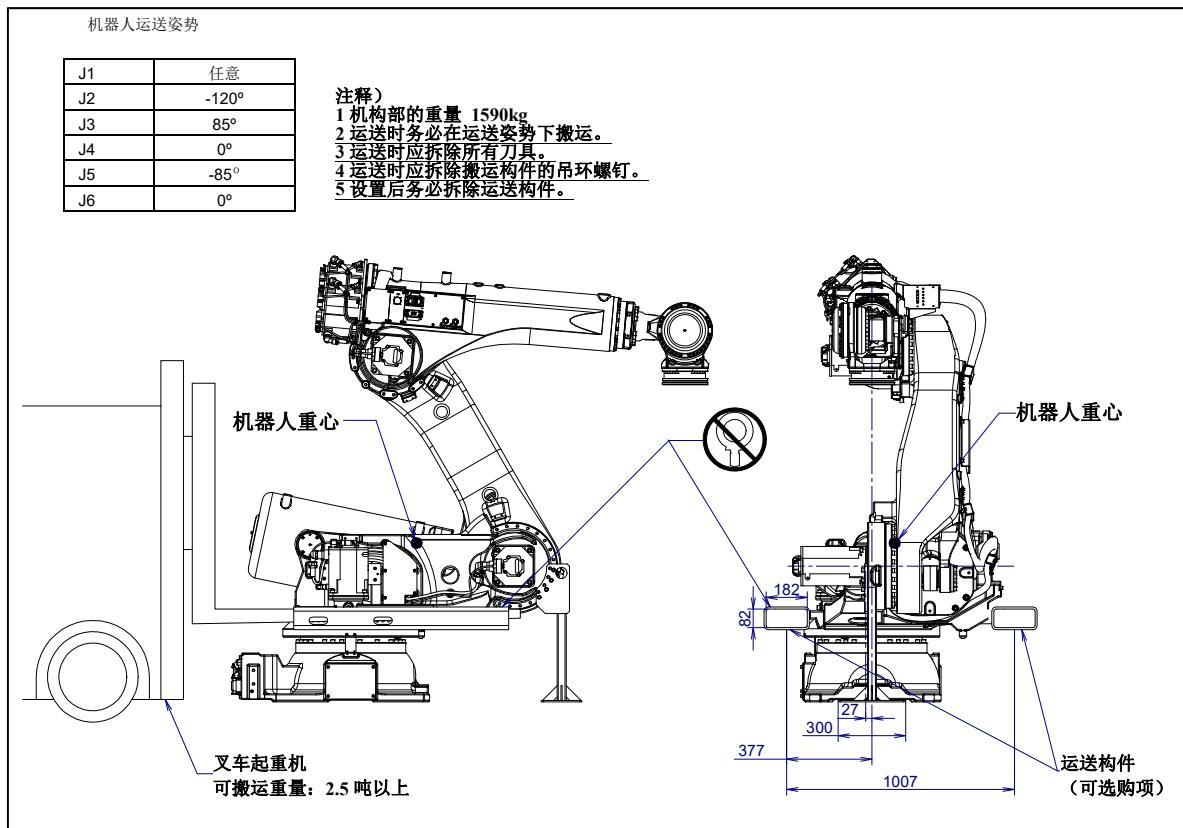
图 1.1 (s) 采用叉车搬运 (R-2000iC/270R J2 机座类型)
