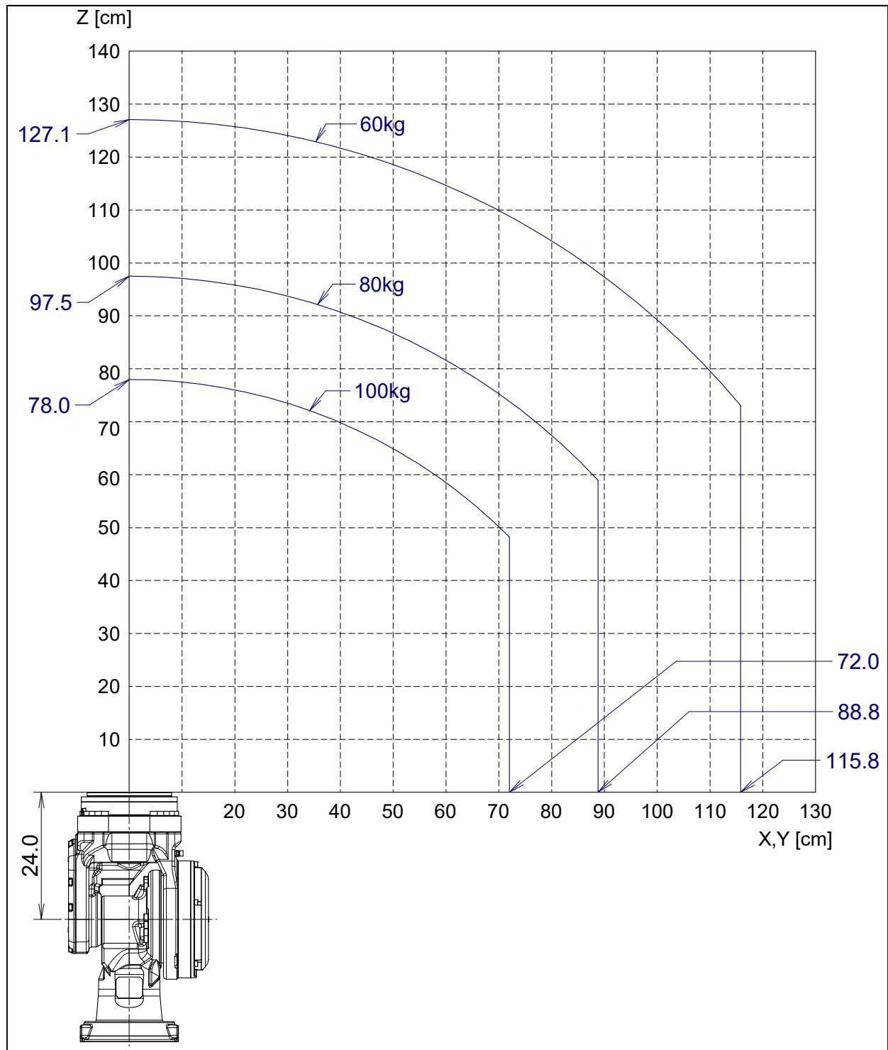
图 3.4 (i) 手腕部允许负载线图 (ISO 法兰盘)
