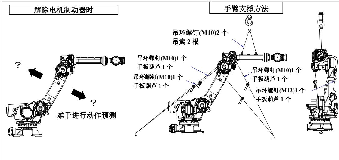
图 3 (a) 解除 J2 轴的电机制动器造成的手臂动作和事先采取的措施例
