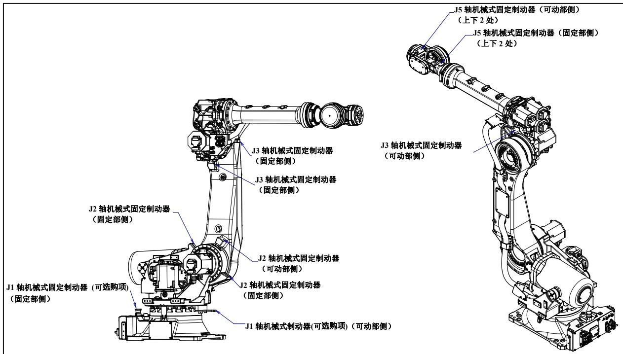
图 3.3 (a) 机械式制动器的位置
