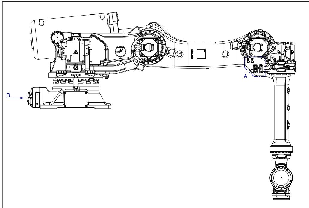
图 5.3 (b) 可选购项电缆用接口的位置 (可选购项) (R-2000iC/165R/210R/100P/100PH)
