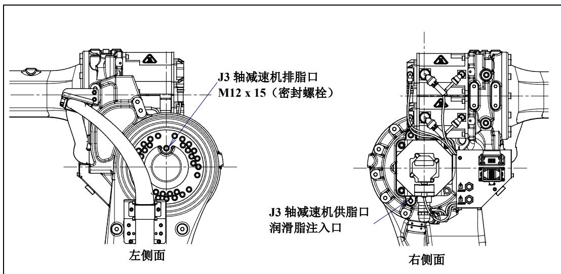
图 7.3.3 (f) J3 轴减速机的润滑脂的更换 (R-2000iC/165F/210F/240F/125L/220U/165R/210R/100P/100PH)
