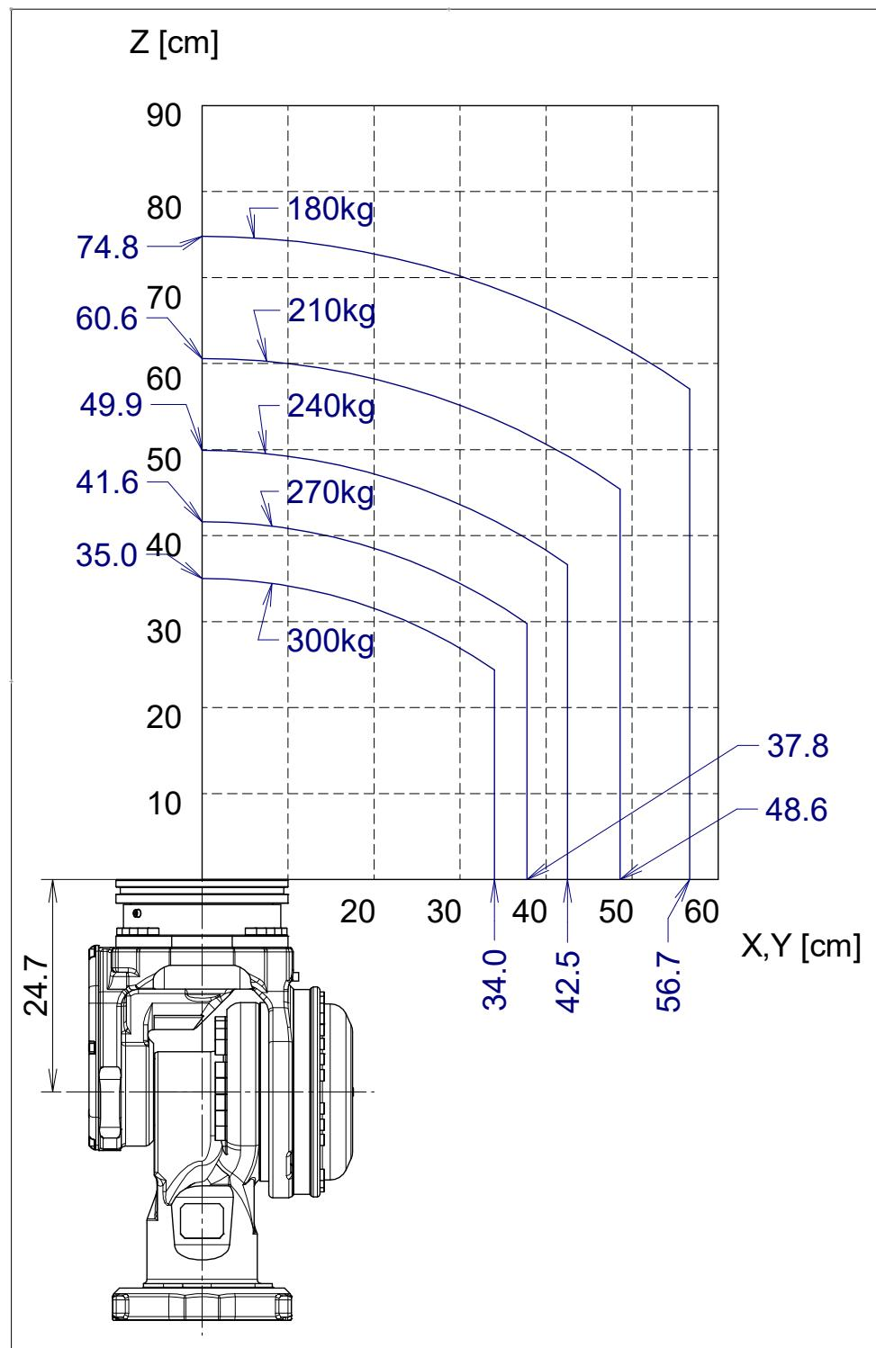
图 3.4 (n) 手腕部允许负载线图 (绝缘 ISO 法兰盘)
