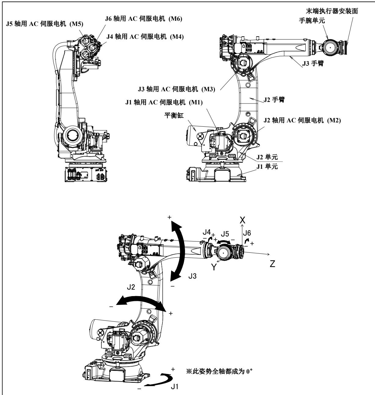
图 3.1 (c) 机构部的构成、各轴坐标和机械接口坐标(R-2000iC/270F/190S/210L/190U)
