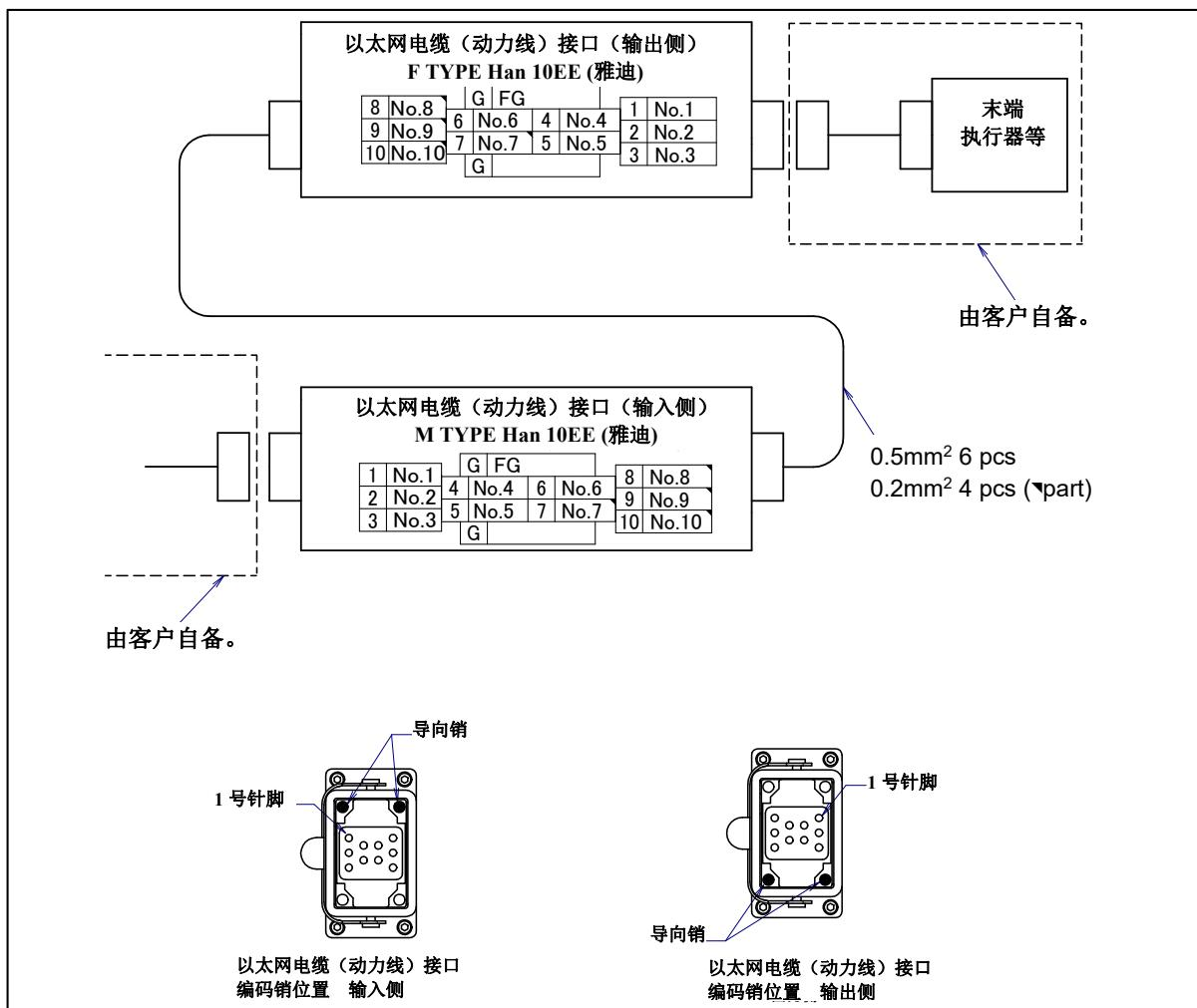
图 5.3 (z) 以太网电缆（动力线）(EP)接口的插针排列（可选购项）
