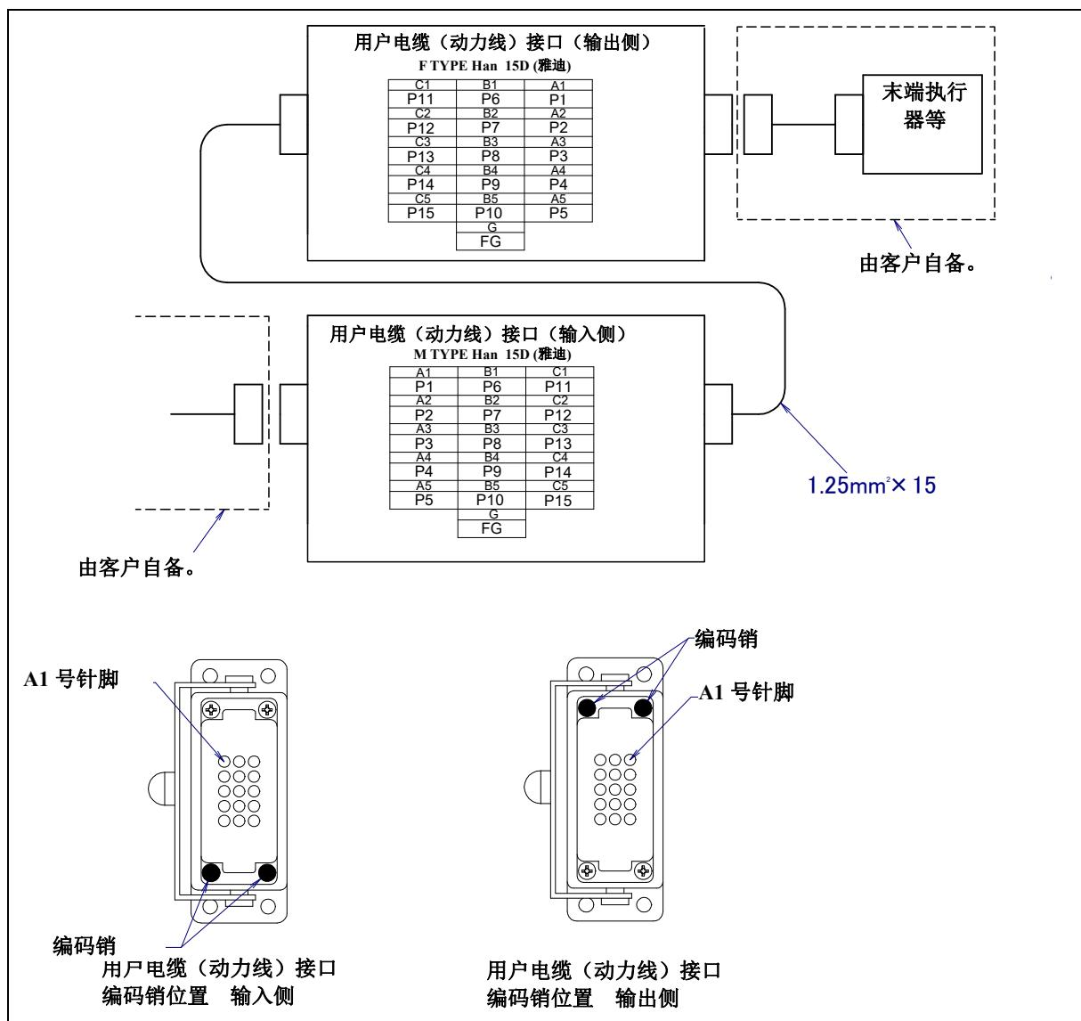
图 5.3 (t) 用户电缆（动力线）(AP)接口的插针排列和编码销配置位置（可选购项）
