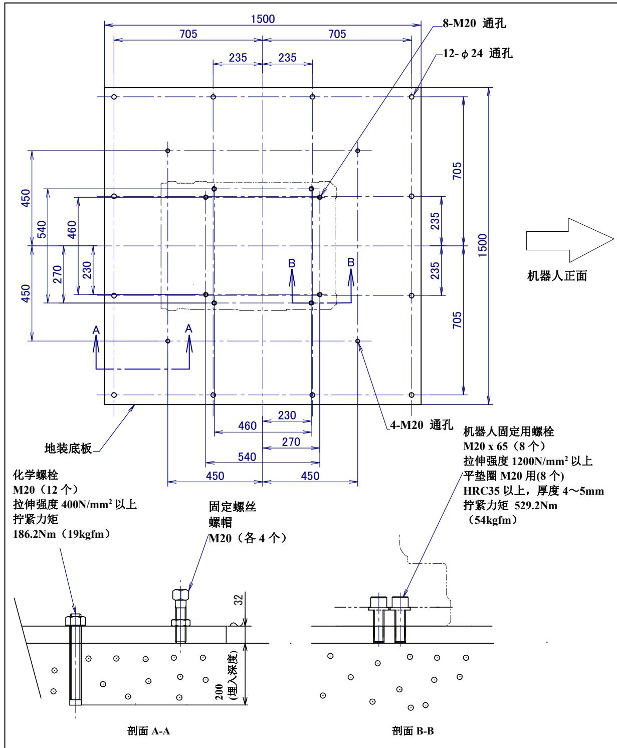
图 1.2.1 (f) 安装方法III(R-2000iC/100P/100PH/270F/270R/190S/210L/190U)
