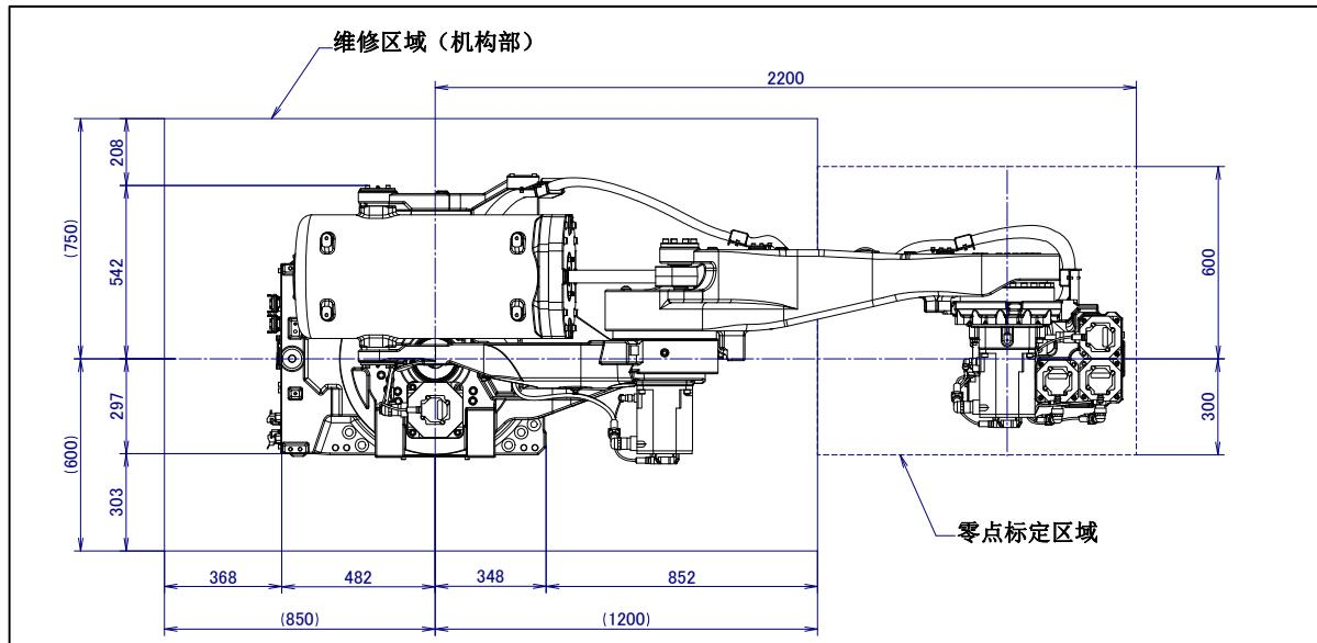
图 1.3 (c) 维修空间的布局图 (R-2000iC/100P/100PH/270R)
