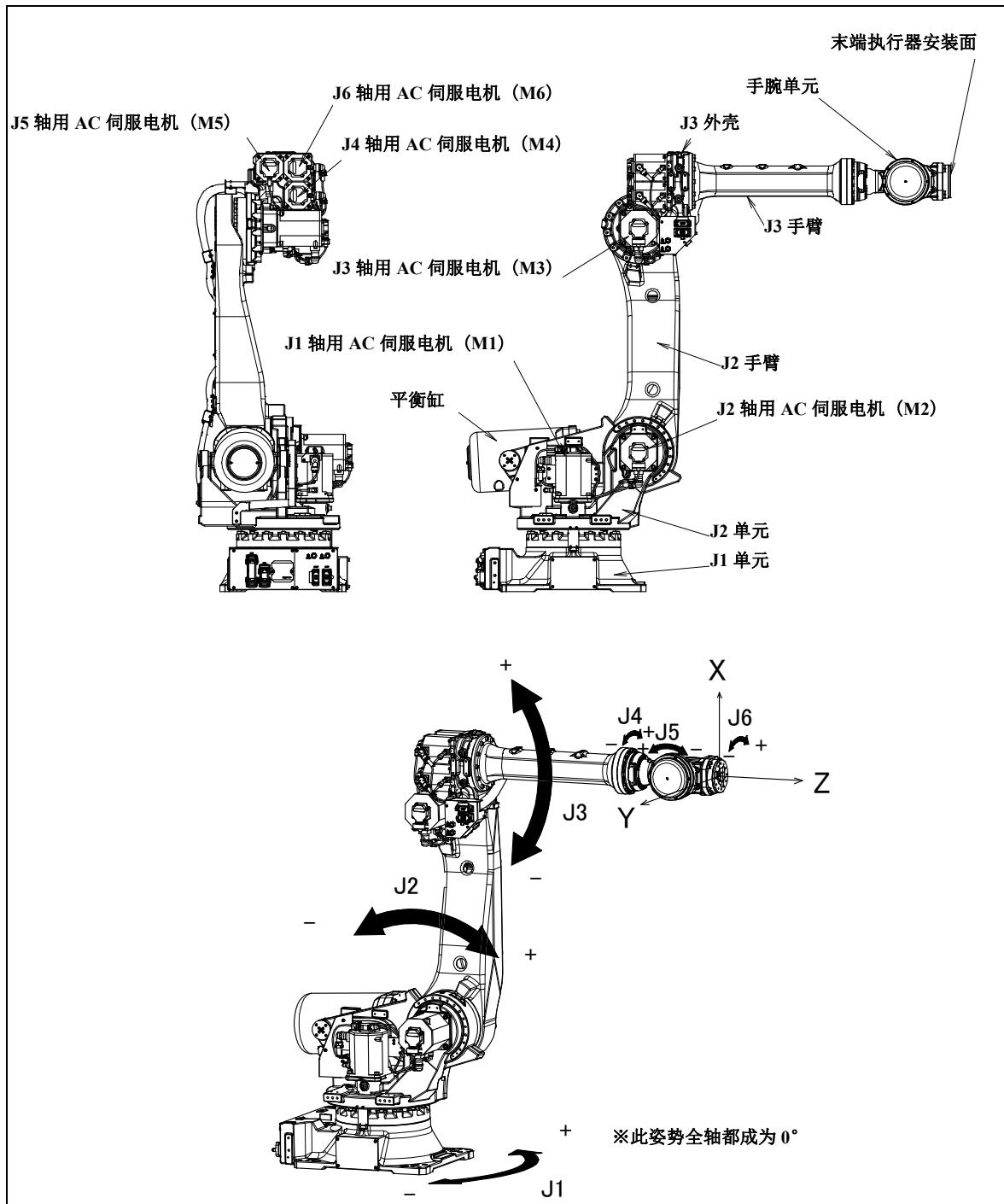
图 3.1 (a) 机构部的构成、各轴坐标和机械接口坐标 (R-2000iC/165F/210F/240F/125L/220U)
