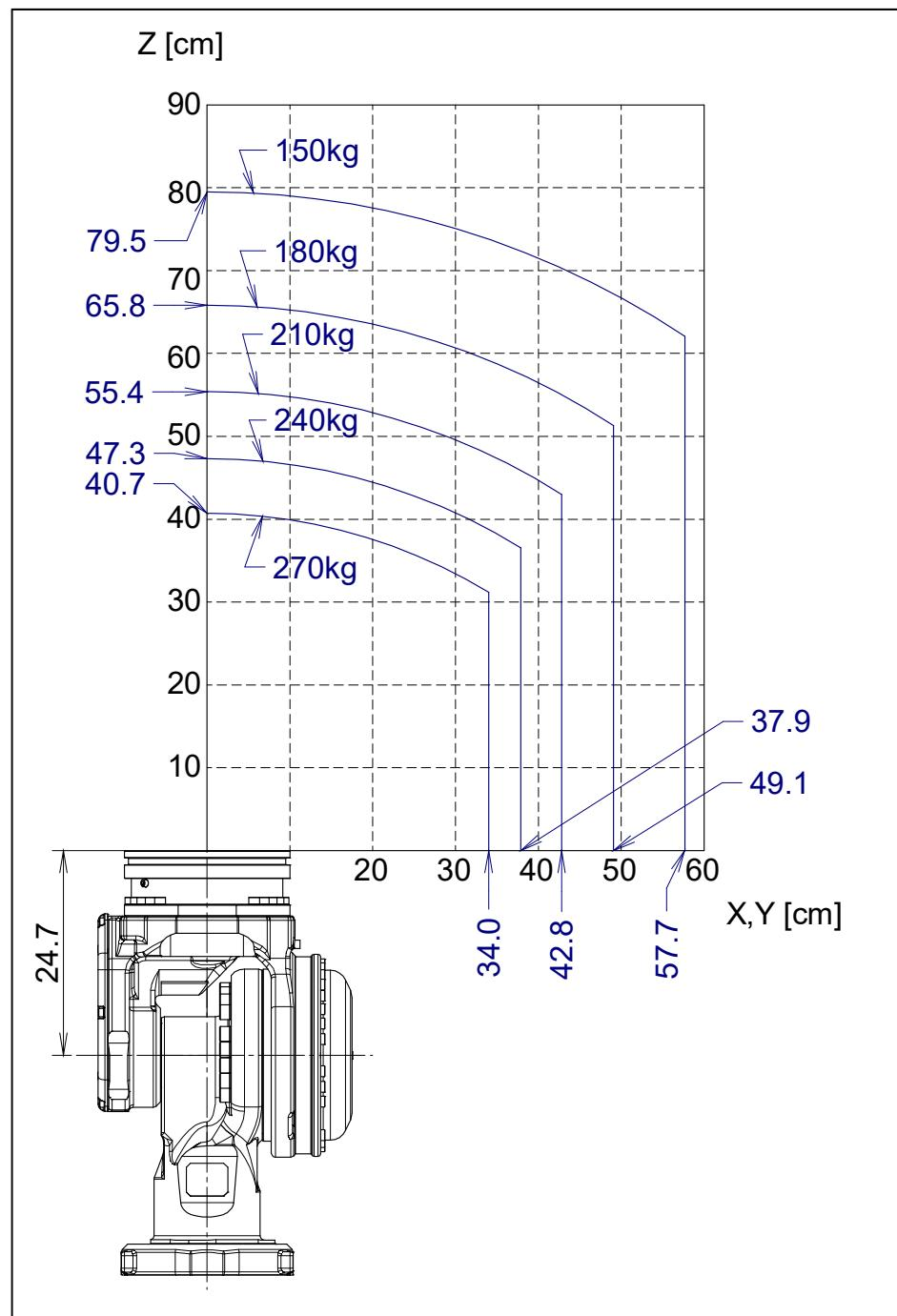
图 3.4 (I) 手腕部允许负载线图 (绝缘 ISO 法兰盘)
