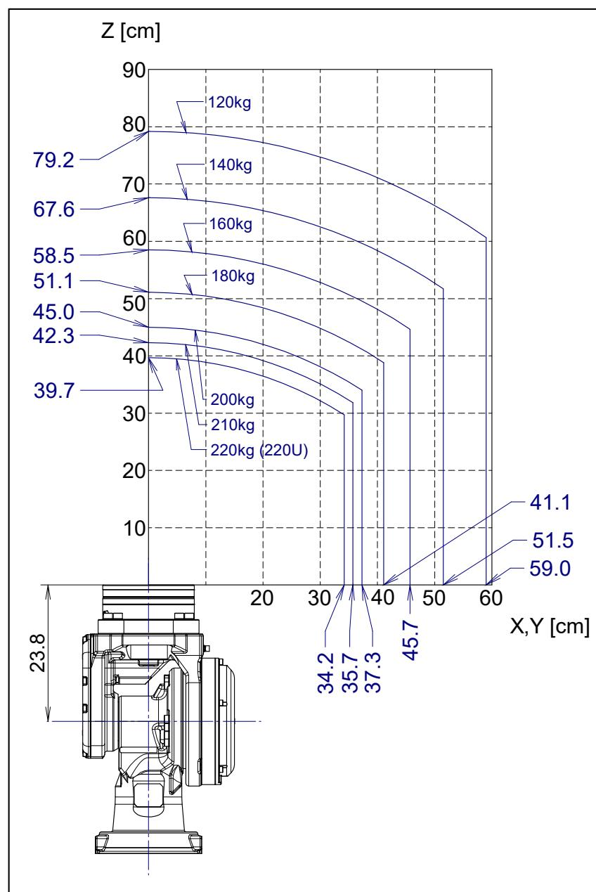
图 3.4 (d) 手腕部允许负载线图 (绝缘 ISO 法兰盘)
