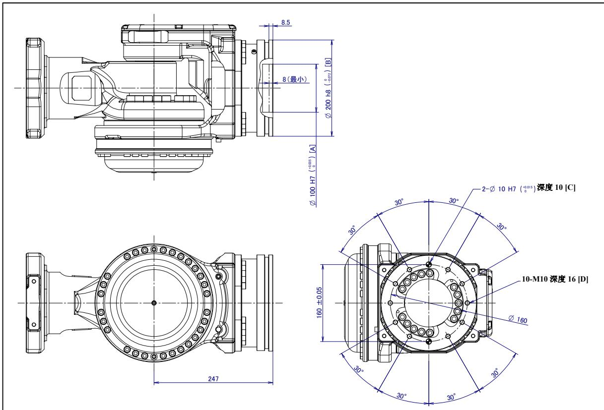
图 4.1 (h) 末端执行器安装面(绝缘 ISO 法兰盘) (R-2000iC/270F/270R/190S/210L/190U)
