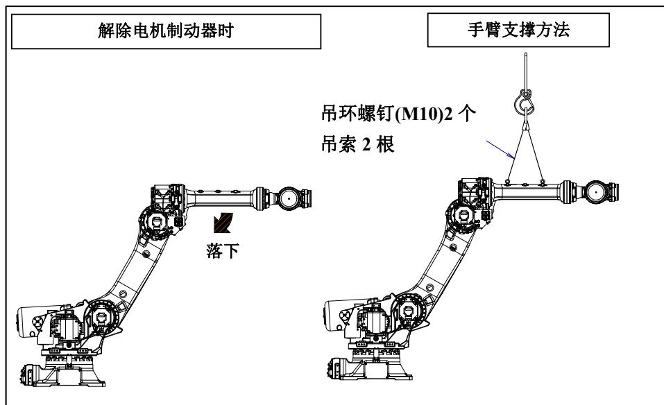
图 3 (b) 解除 J3 轴的电机制动器造成的手臂动作和事先采取的措施例
