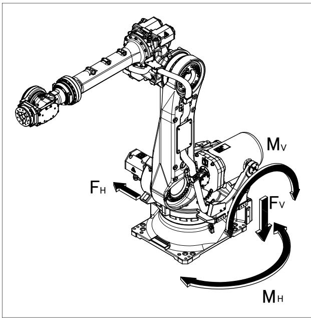
图 1.2.1 (g) 断电停止时作用的力以及力矩
