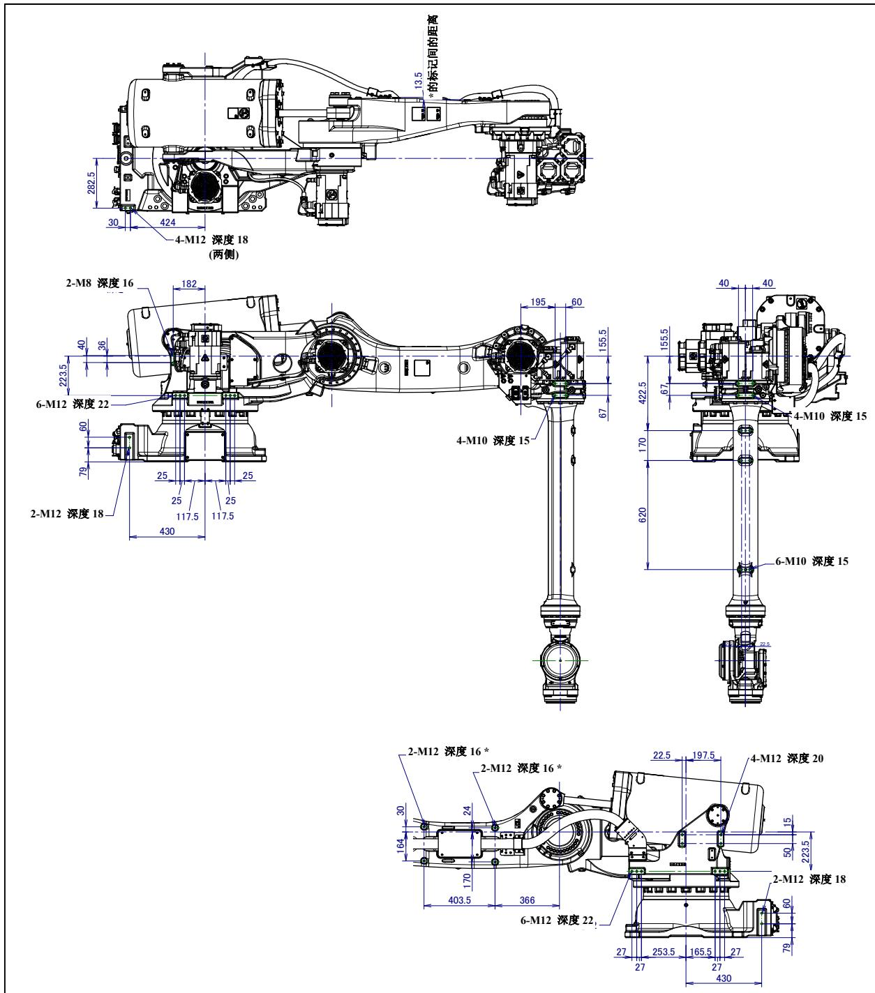
图 4.2 (d) 设备安装面尺寸 (R-2000iC/100P/100PH)
