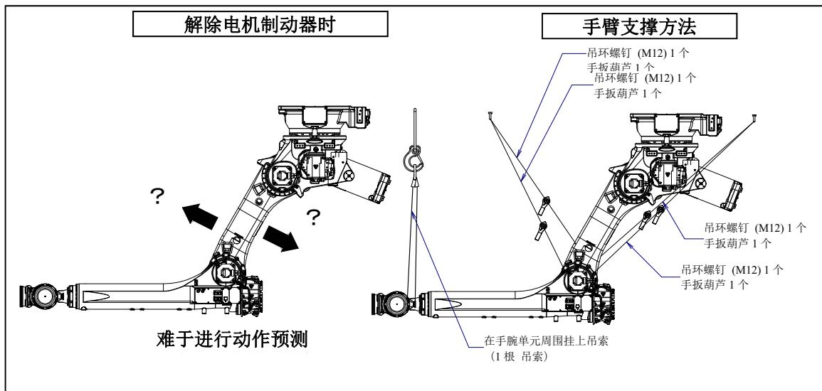
图 3 (d) 解除 J2 轴的电机制动器造成的手臂动作和事先采取的措施例
