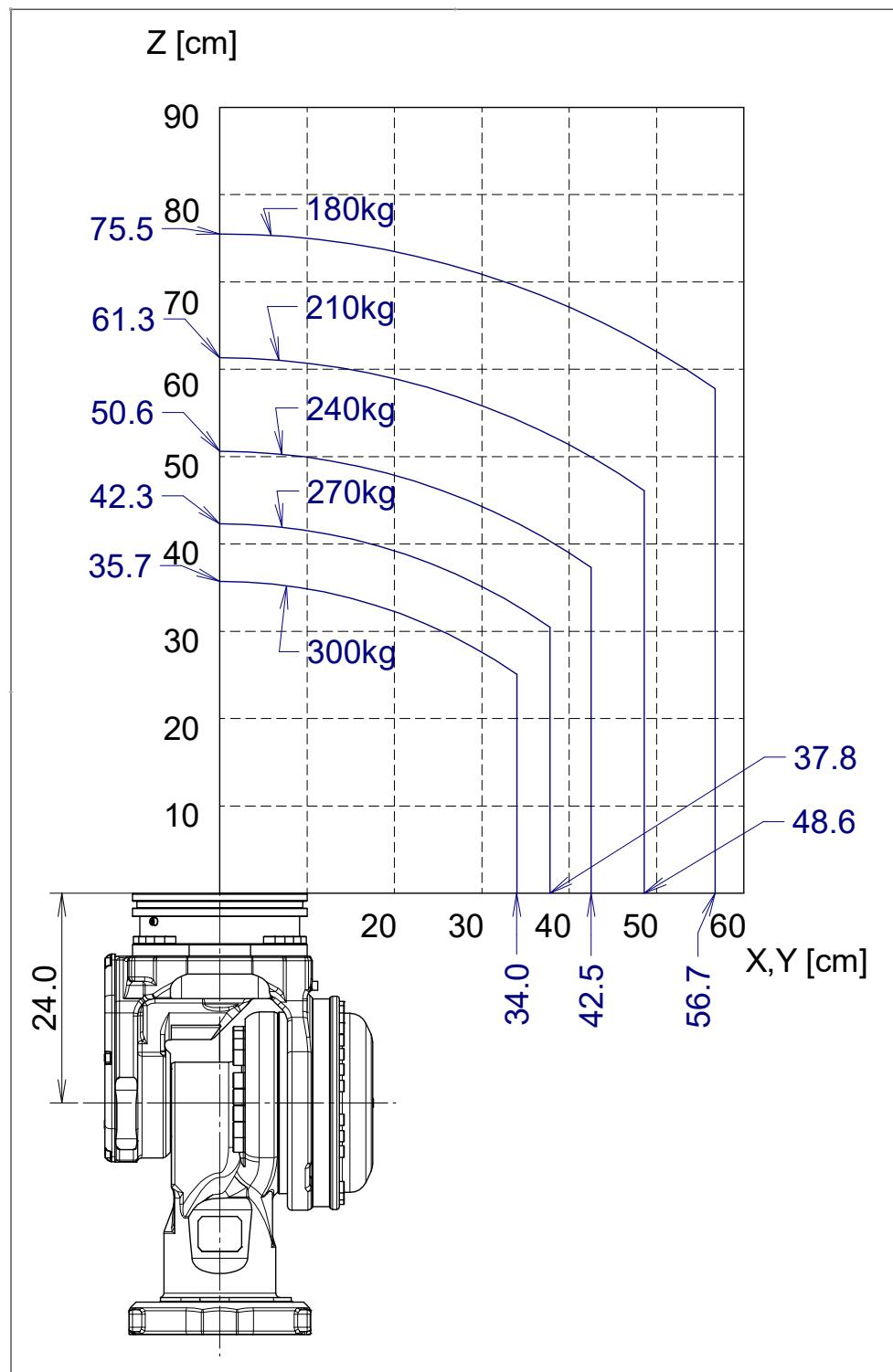
图 3.4 (m) 手腕部允许负载线图 (ISO 法兰盘)
