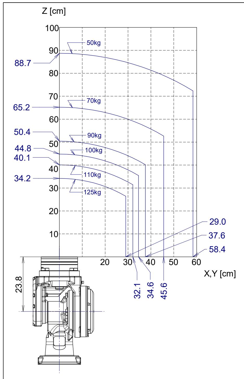
图 3.4 (h) 手腕部允许负载线图 (绝缘 ISO 法兰盘)
