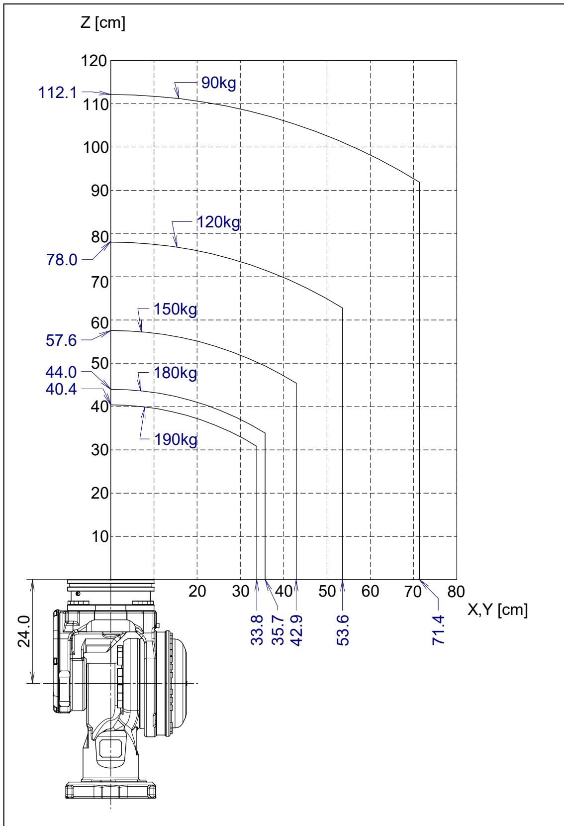
图 3.4 (o) 手腕部允许负载线图 (ISO 法兰盘) (精度 · 刚性强化对应法兰盘)
