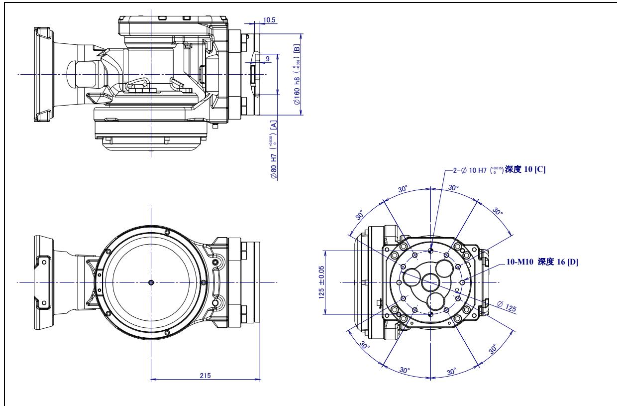
图 4.1 (a) 末端执行器安装面 (ISO 法兰盘) (R-2000iC/165F/210F/240F/125L/220U/165R/210R)
