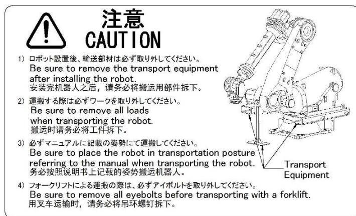
图 4(n) 搬运注意标签 (R-2000iC/165R/210R/100P/100PH/270R 用 J2 机座类型搬运部件可选购项时)
