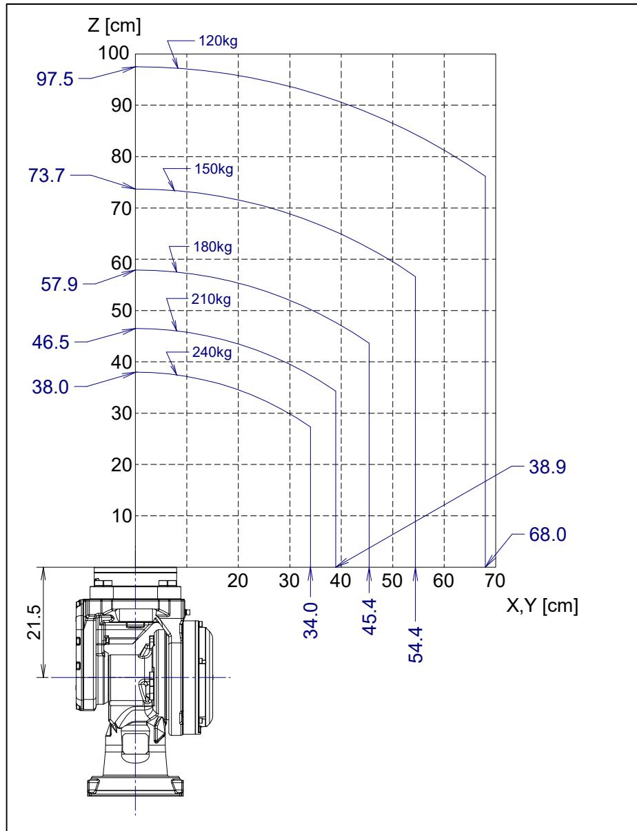
图 3.4 (e) 手腕部允许负载线图 (绝缘 ISO 法兰盘)
