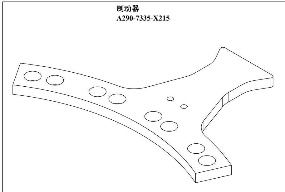
图 6.2.1 (d) J1 轴机械式可变制动器 (可选购项)
