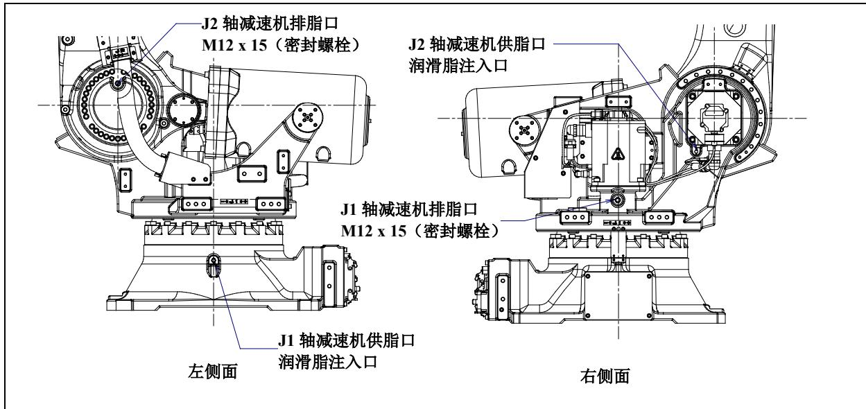
图 7.3.3 (a) J1/J2 轴减速机的润滑脂的更换 (R-2000iC/165F/210F/240F/125L/220U)
