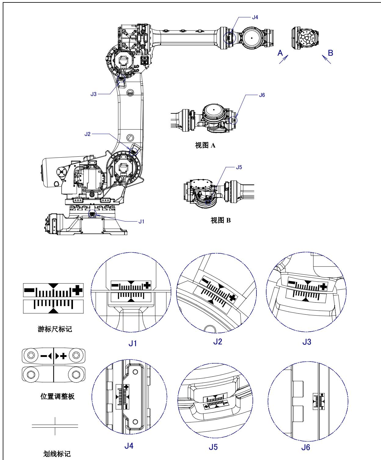
图 8.3 (a) 各轴的对合标记位置 (R-2000iC/165F/210F/240F/125L/220U)
