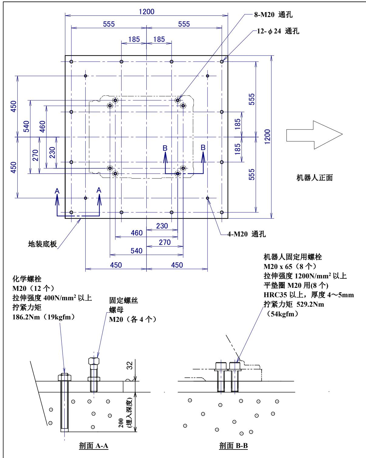
图 1.2.1 (c) 具体安装例III (R-2000iC/165F/210F/240F/125L/220U/165R/210R)
