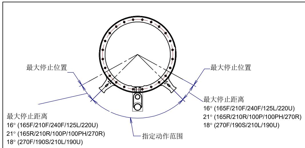
图 6.2.3 (a) J1 轴机械式可变制动器的最大停止距离（位置）
