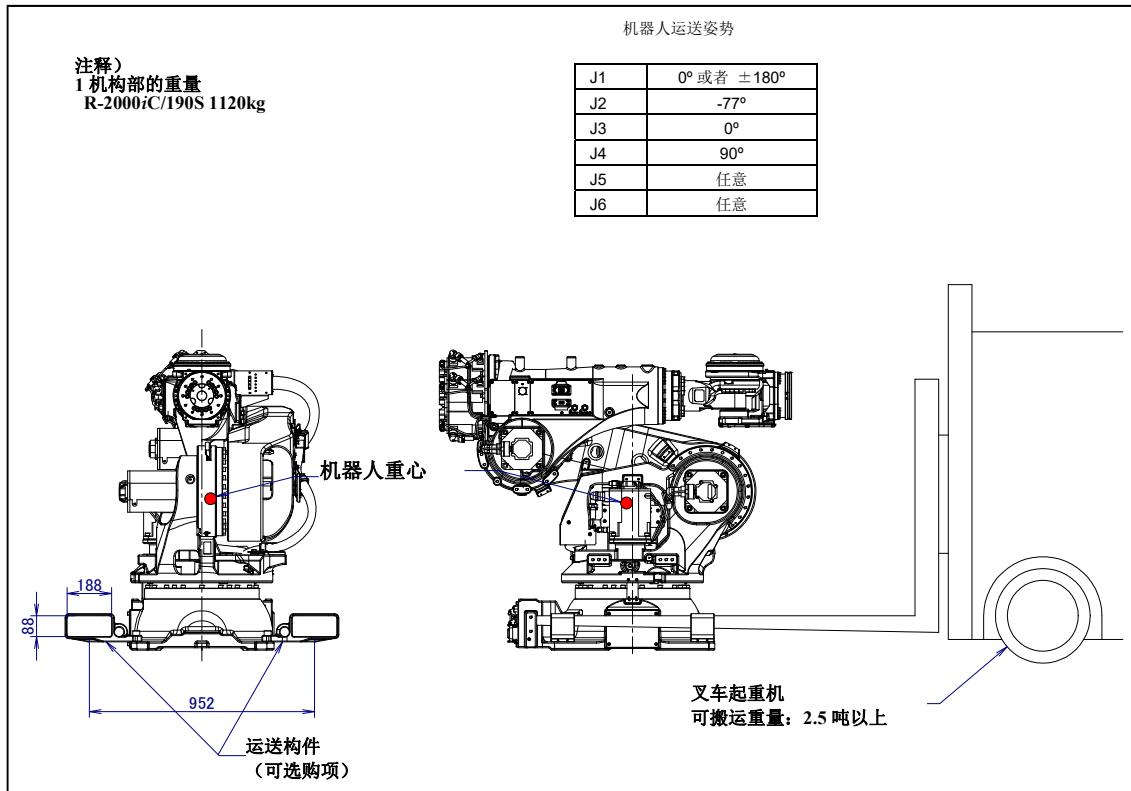
图 1.1 (t) 采用叉车搬运 (R-2000iC/190S J1 机座类型)
