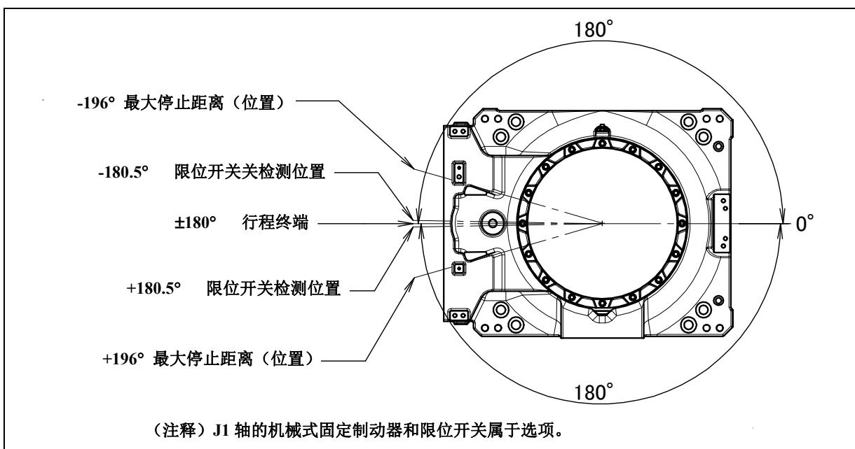
(注释) J1 轴的机械式固定制动器和限位开关属于选项。
