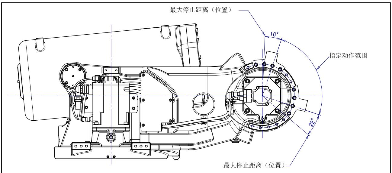
图 6.2.3 (c) J2 轴机械式可变制动器的最大停止距离 (位置)
