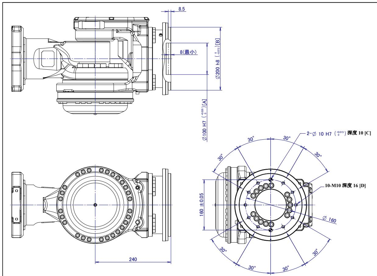
图 4.1 (i) 末端执行器安装面 (精度·刚性强化对应法兰盘) (R-2000iC/190S)
