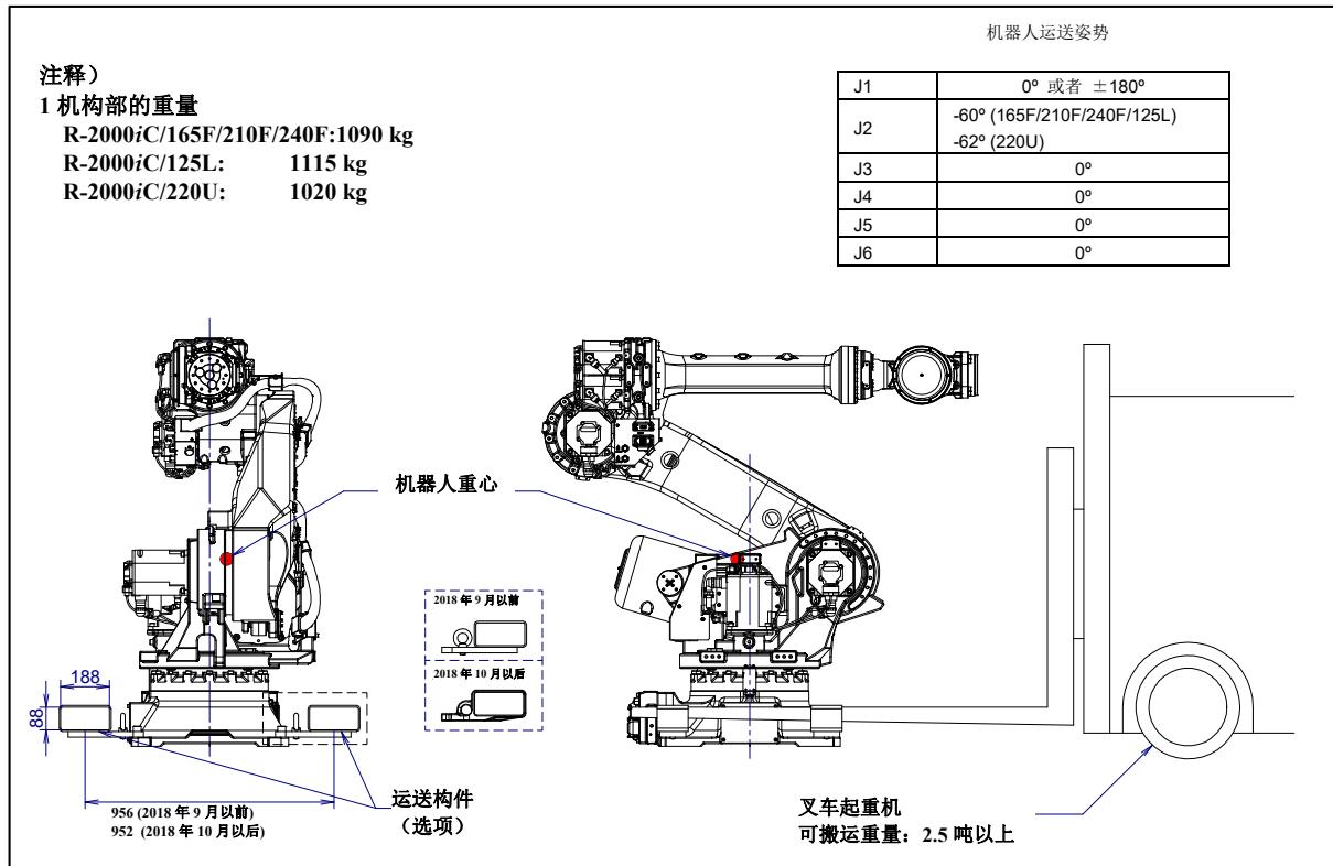
图 1.1 (l) 采用叉车搬运 (R-2000iC/165F/210F/240F/125L/220U J1 机座类型)
