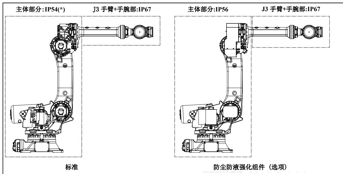
图 3.1 (e) R-2000iC 的防尘防液性能
