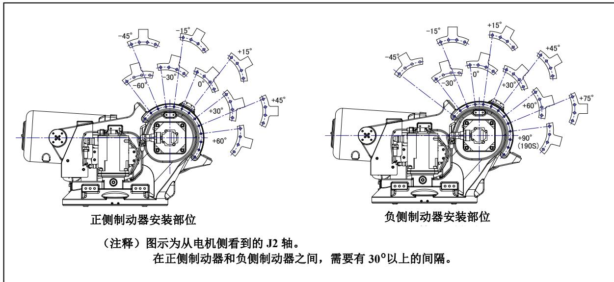
图 6.2.1 (o) J3 轴机械式可变制动器的安装 (2/3)
