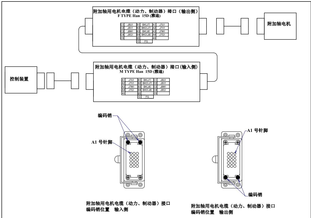
图 5.3 (x) 附加轴用电机电缆（动力、制动器）接口的插针排列和编码销配置位置（可选购项）
