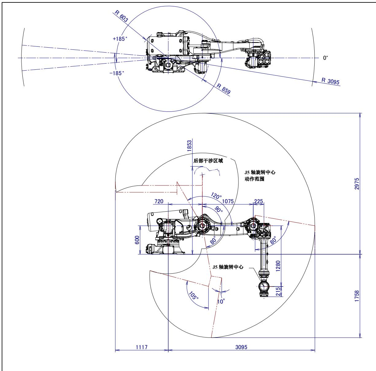
图 3.2 (d) 动作范围图 (R-2000iC/165R/210R)
