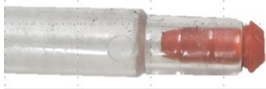
Fig. 5.2.3 (d) Normal gas saver nozzle installation status
