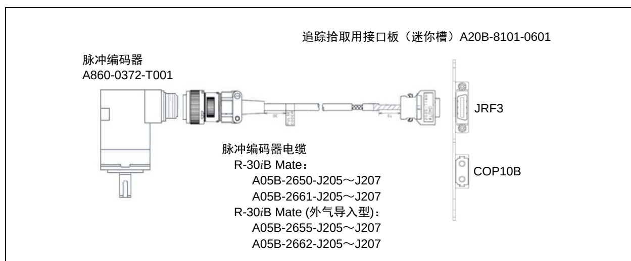
图 E.4 (c) 追踪拾取用接口板 A05B-2650-J035, A05B-2655-J035, A05B-2661-J035, A05B-2662-J035 使用时的电缆连接方法 (1 个 \alpha A1000S 脉冲编码器)
