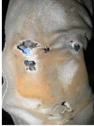
图 7.2.3 (b) 电缆保护套的损坏
