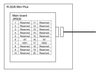
Fig. B.1 (g) R-30iB Mini Plus HDI interface
