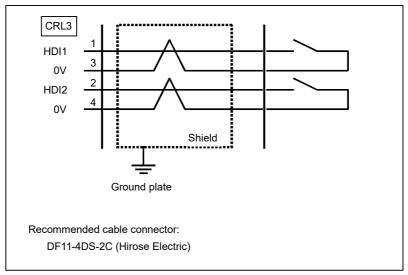
Fig. B.1 (d) R-30iB Mate / R-30iB Mate Plus HDI cable connections
