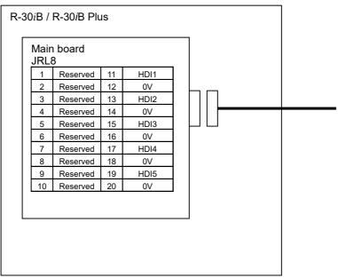
Fig. B.1 (a) R-30iB / R-30iB Plus HDI interface
