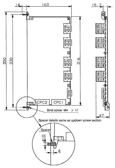
Fig. C.2 (d) Multiplexer dimensions (A16B-1212-0290)
