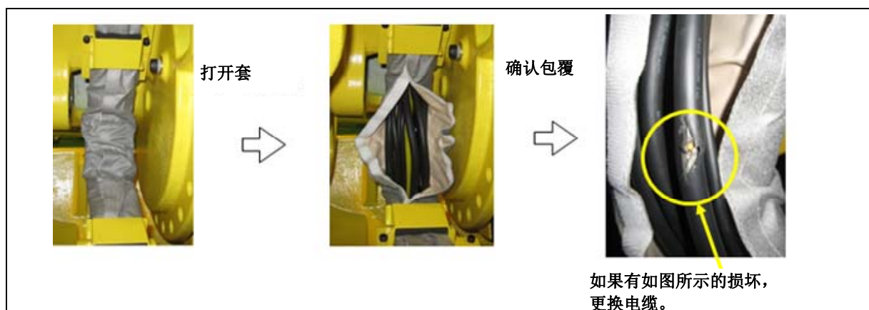
图 7.2.3 (c) 电缆的确认方法
