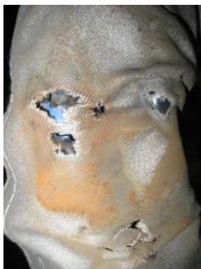
图 7.2.3 (b) 电缆保护套的损坏
