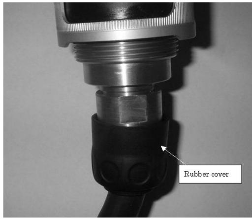
Fig.9.2.5 (d) Remove rubber cover
