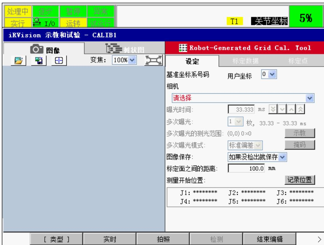
请进行基准坐标系的选择、相机数据的选择、曝光时间的设定、标定面之间的距离的设定、测量开始位置的设定。
