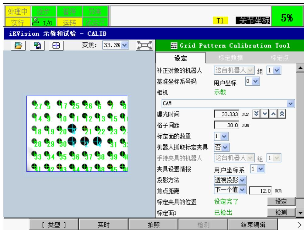
确认〔标定面1〕已被设定为〔设定完了〕。确认所创建标定数据的内容。
