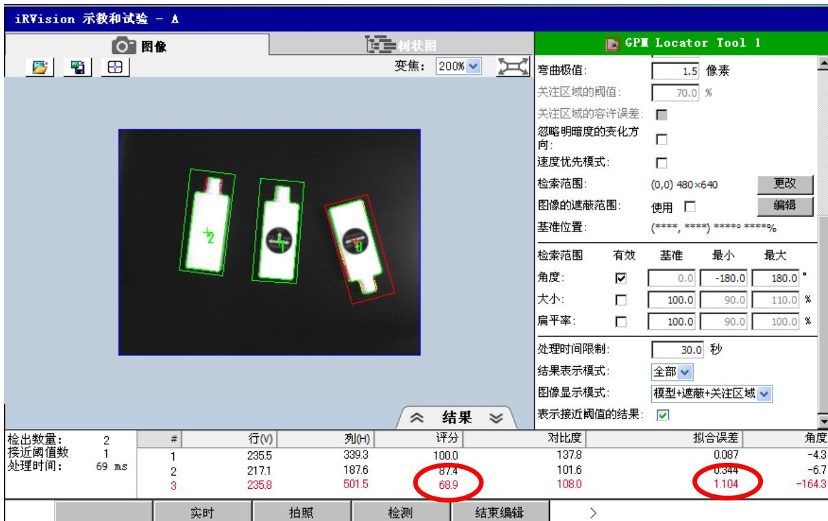
本例的工件轮廓部分有若干圆度，轮廓看上去歪斜。调大〔弯曲极值〕的值，采取消化圆度部分的视觉差异的对策。下图的示例中，〔弯曲极值〕已从 1.5 变更为 2.5。在该状态下，再次轻击 F4 检测。通过调大弯曲极值，消除了未检出工件。
