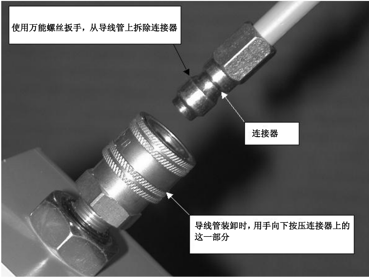
图 8.6 (f) 卷轴支架侧的连接器
