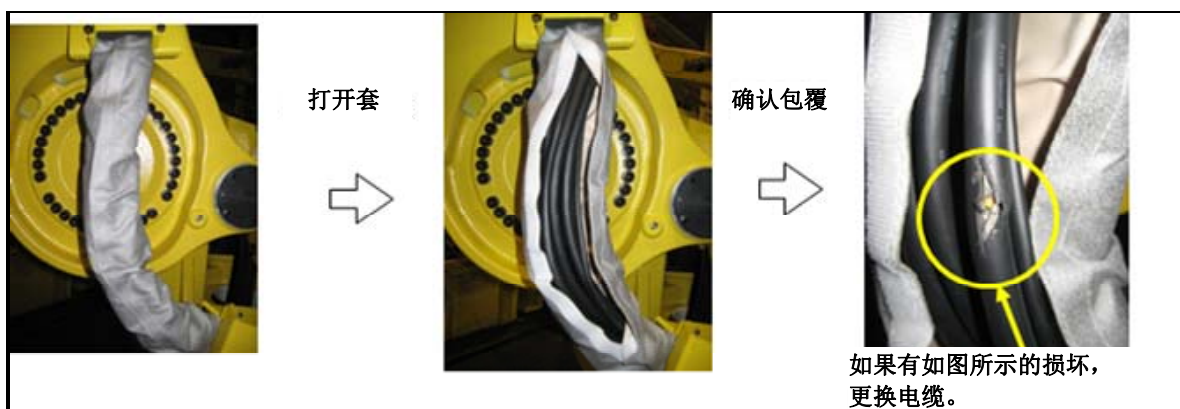
图 7.2.3 (c) 电缆的确认方法
