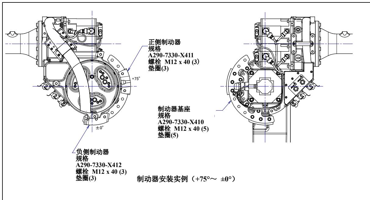
图 6.2.1 (j) J3 轴机械式可变制动器的安装事例
