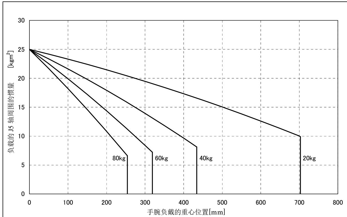
图 3.4 (i) 手腕部允许负载线图 (R-1000iA/80H)
