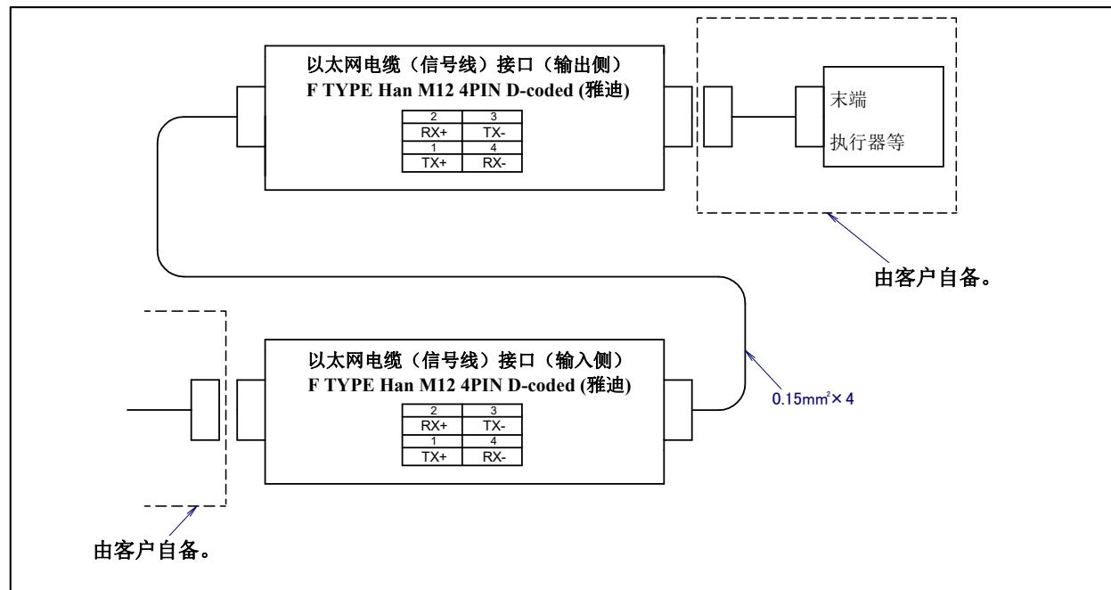
图 5.3 (o) 以太网电缆（信号线）(ES)接口的插针排列（可选购项）
