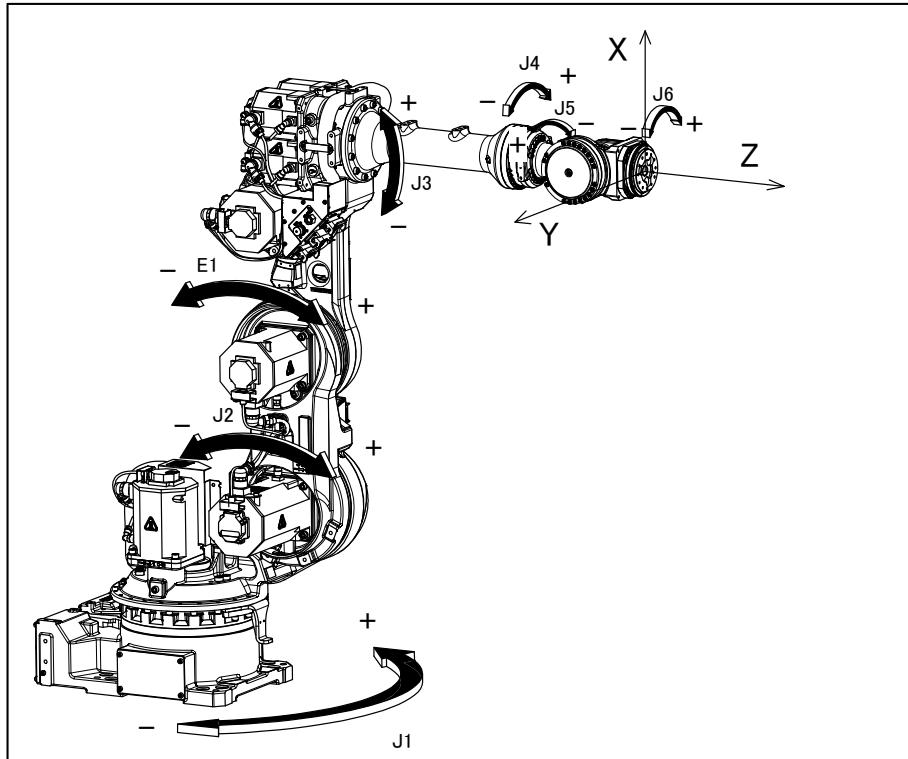
图 3.1 (e) 各轴坐标和机械接口坐标(R-1000iA/120F-7B)
