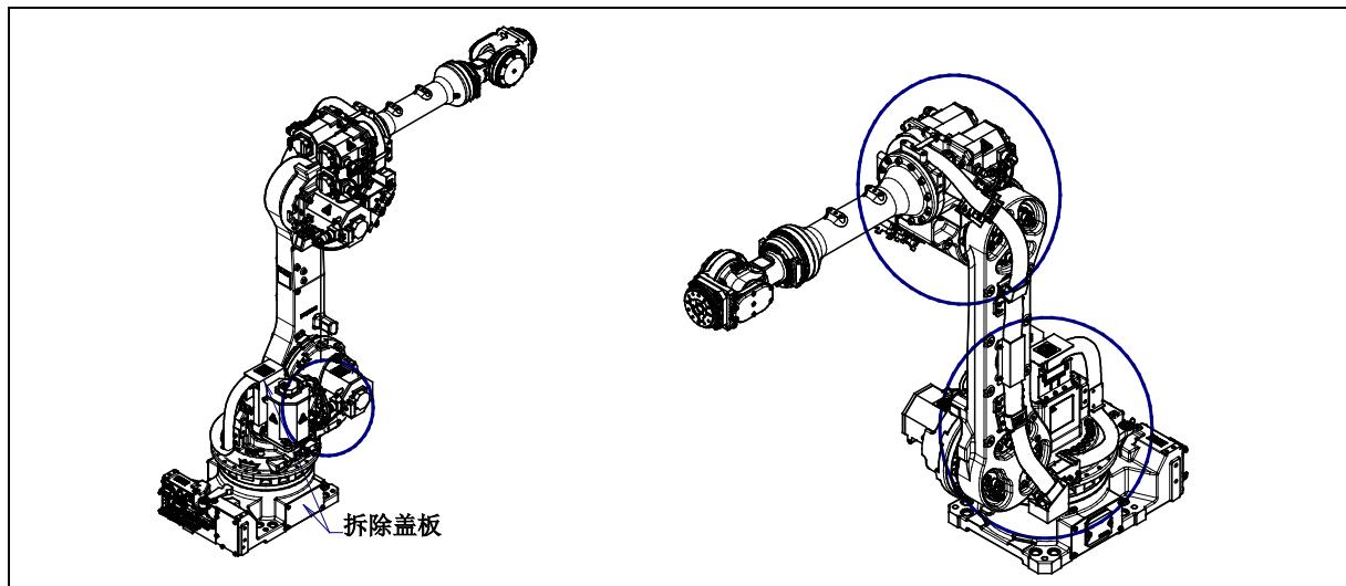
图 7.2.3 (a) 机构部内电缆的确认部位
