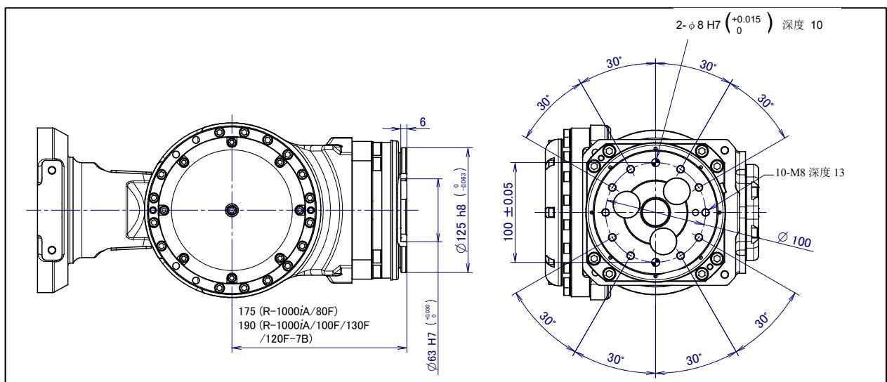
图 4.1 (a) 末端执行器接口尺寸 (ISO 法兰盘) (R-1000iA/80F/100F/130F/120F-7B)
