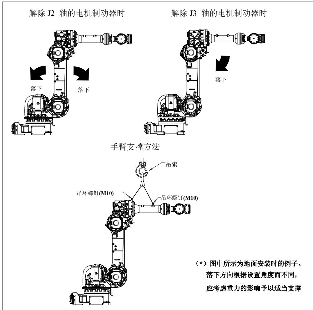
图 3 (a) 解除 J2 轴和 J3 轴的电机制动器造成的手臂动作和事先采取的措施例
