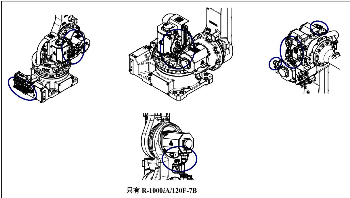
图 7.2.3 (d) 连接器的检修部位
