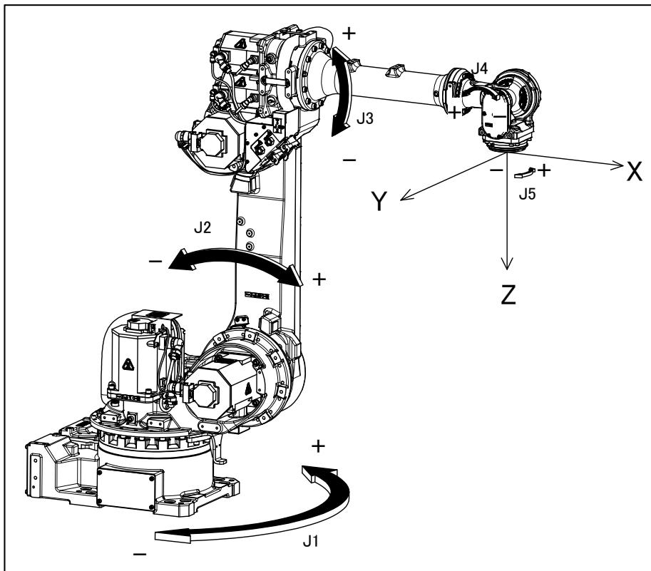
图 3.1 (f) 各轴坐标和机械接口坐标(R-1000iA/80H)
