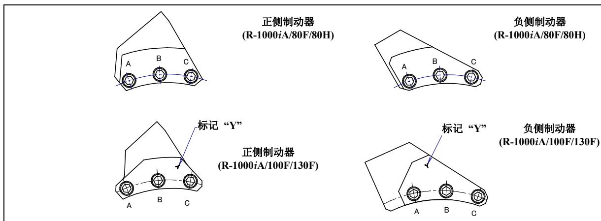
图 6.2.1 (b) J2 轴机械式制动器 (可选购项)
