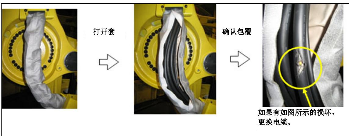
图 7.2.3 (c) 电缆的确认方法
