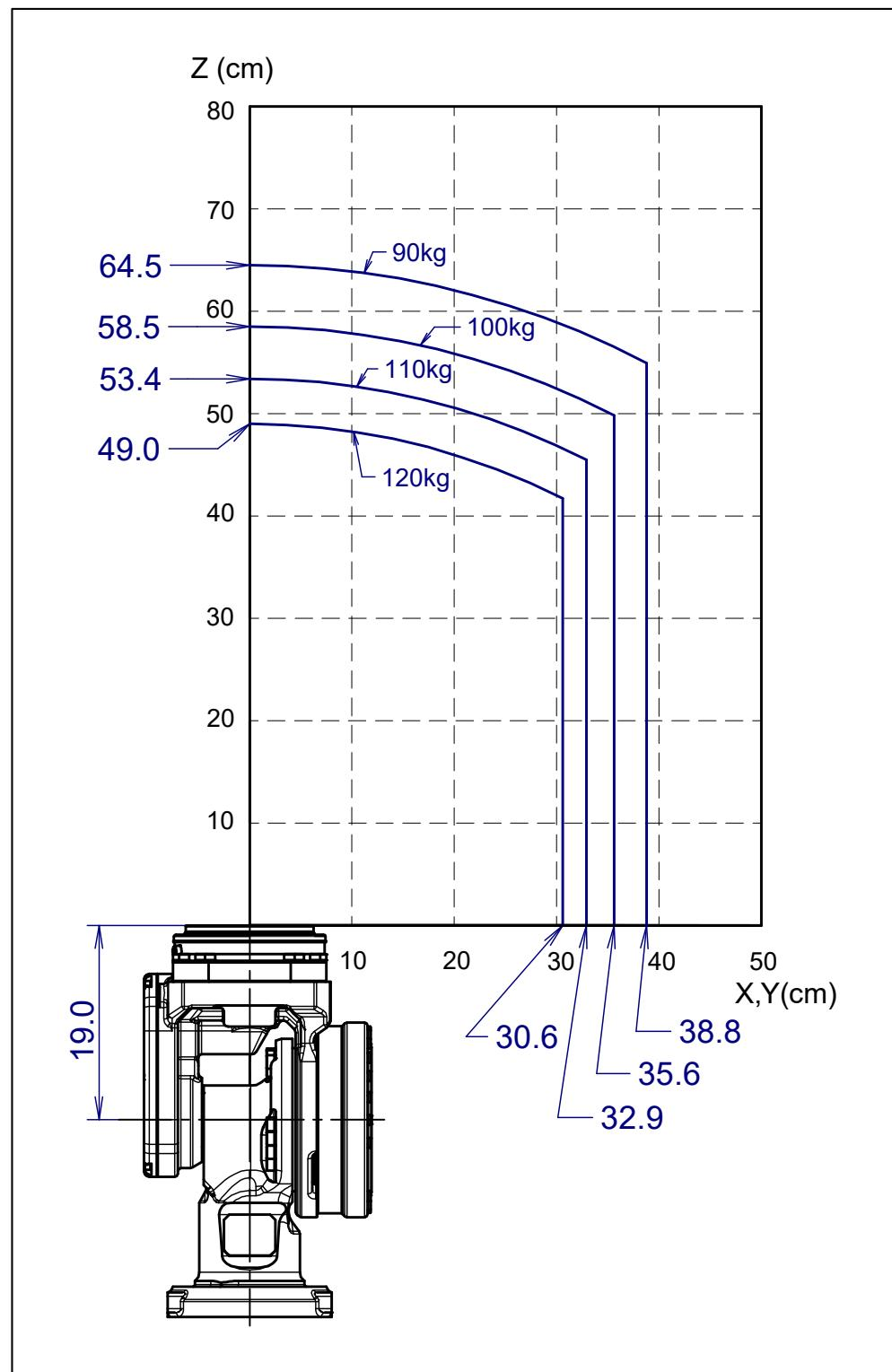
图 3.4 (g) 手腕部允许负载线图 (ISO 法兰盘)
