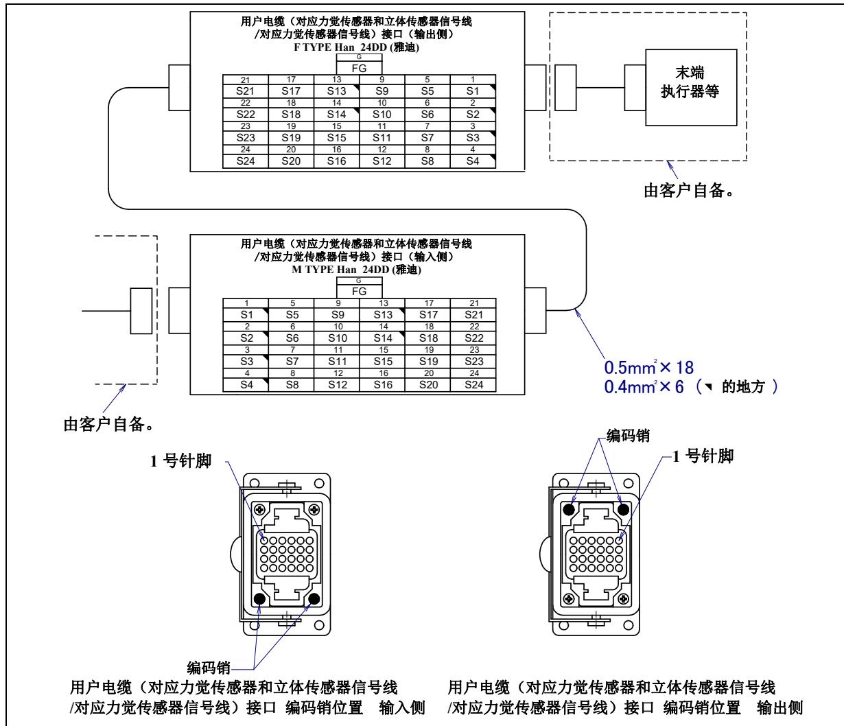
图 5.3 (i) 用户电缆（对应力觉传感器和立体传感器信号线）(ASi)（对应力觉传感器信号线）(ASH)
