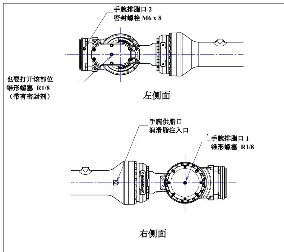
图 7.3.3 (a) 释放手腕残留压力时的开启部位 (R-1000iA/80F/100F/130F/120F-7B)
