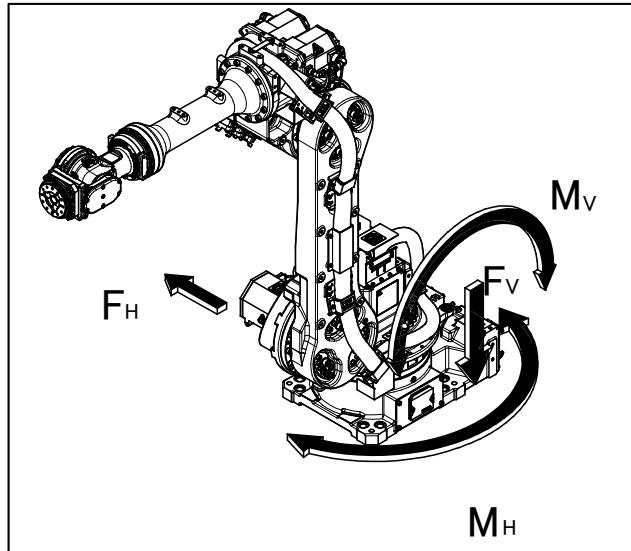
图 1.2 (b) 断电停止时作用的力以及力矩
