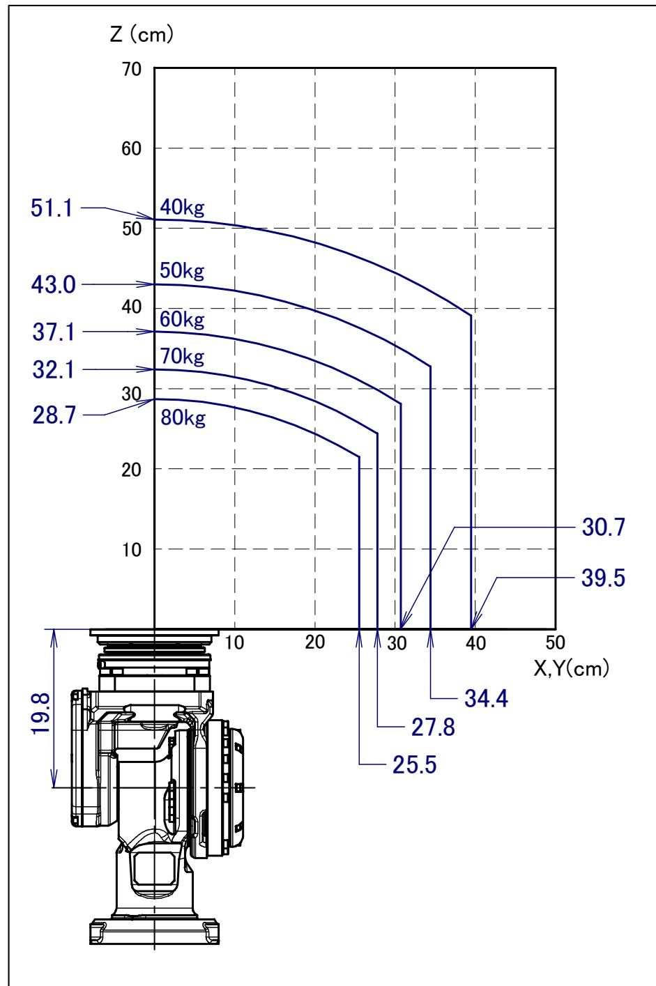
图 3.4 (b) 手腕部允许负载线图 (绝缘 ISO 法兰盘)
