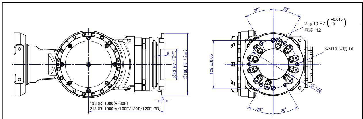
图 4.1 (b) 末端执行器接口尺寸 (绝缘 ISO 法兰盘) (R-1000iA/80F/100F/130F/120F-7B)
