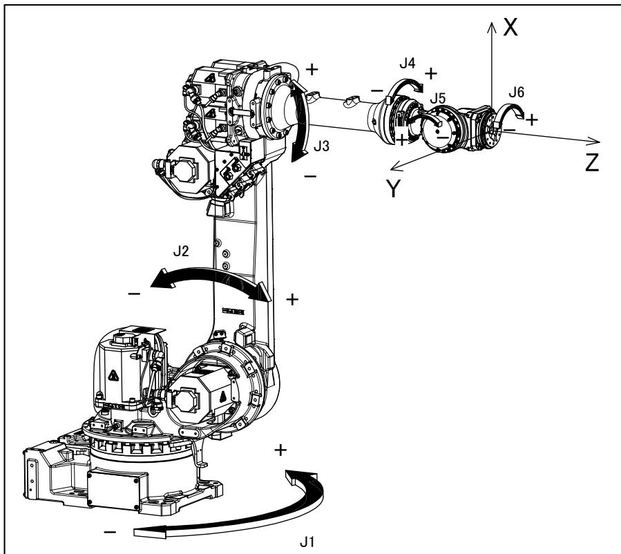
图 3.1 (d) 各轴坐标和机械接口坐标(R-1000iA/80F/100F/130F)
