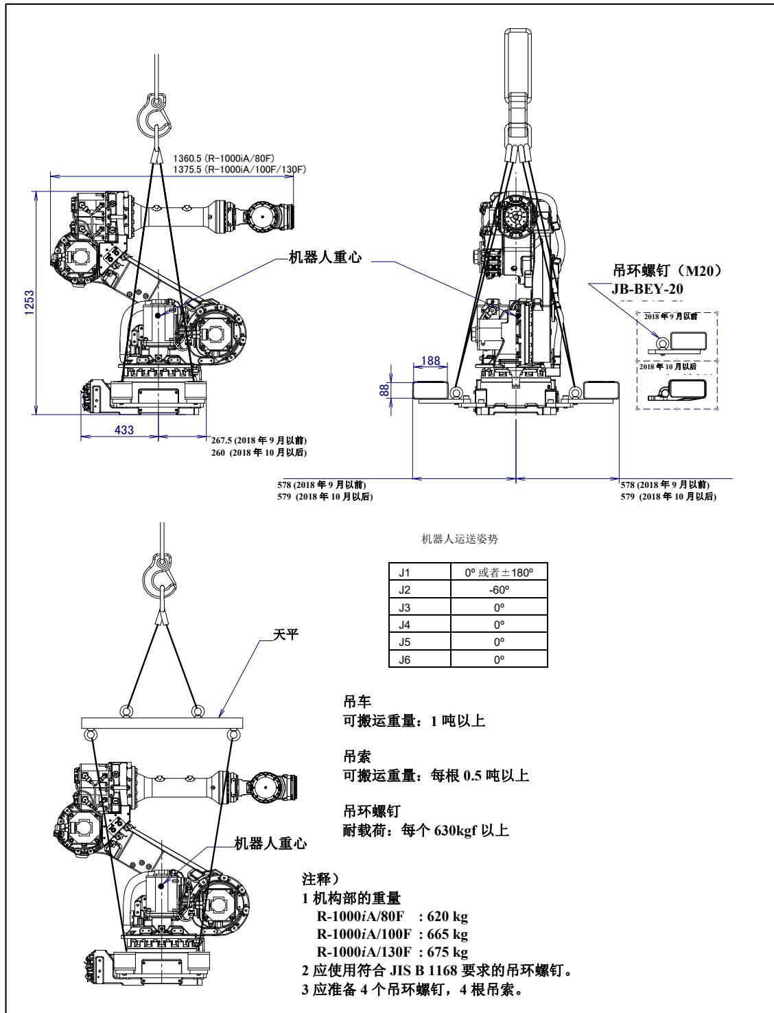
图 1.1 (b) 采用吊车搬运 (R-1000iA/80F/100F/130F)
