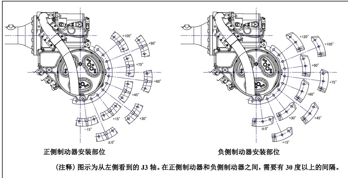
图 6.2.1 (g) J3 轴机械式制动器的安装 (可选购项)
