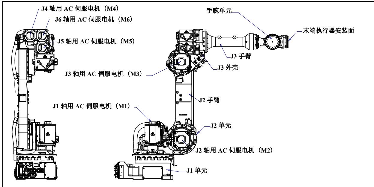
图 3.1 (a) 机构部的构成 (R-1000iA/80F/100F/130F)
