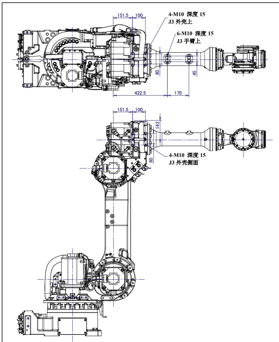
图 4.2 (a) 设备安装面尺寸 (R-1000iA/80F/100F/130F/80H)
