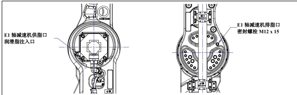
图 7.3.2 (d) E1 轴减速机的润滑脂的更换
