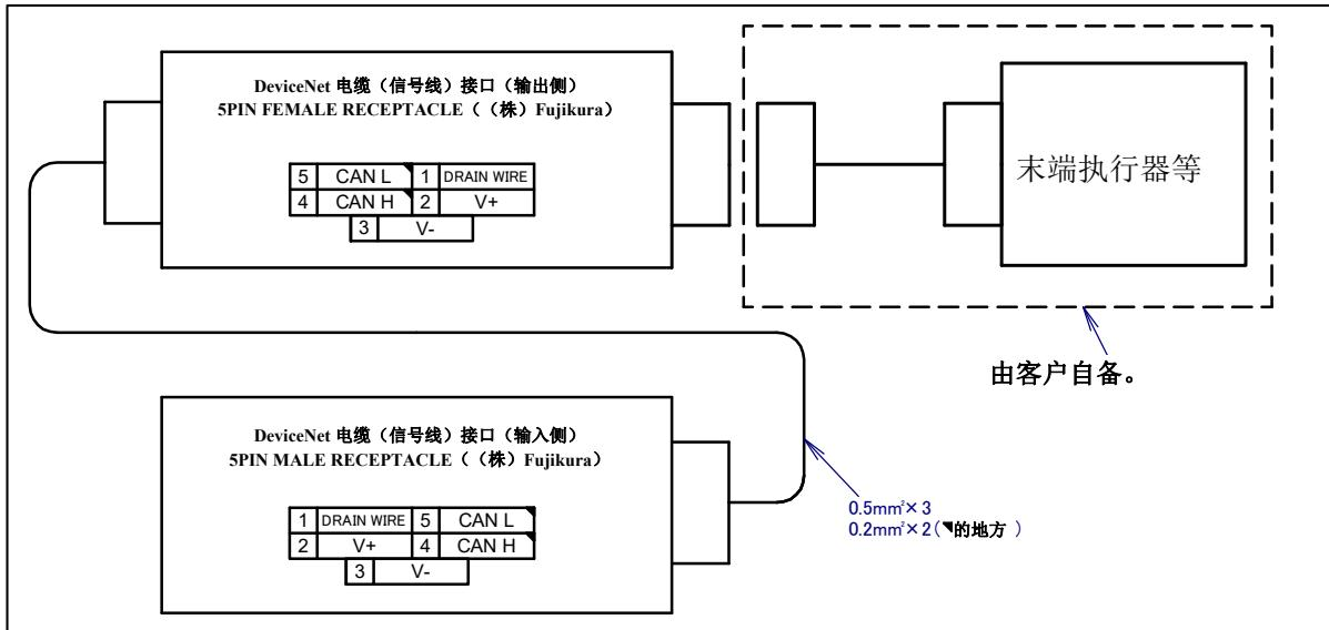
图 5.3 (k) DeviceNet 电缆（信号线）(DS) 接口的插针排列（可选购项）
