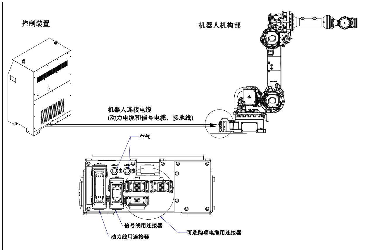
图 2 (a) 电缆连接图
