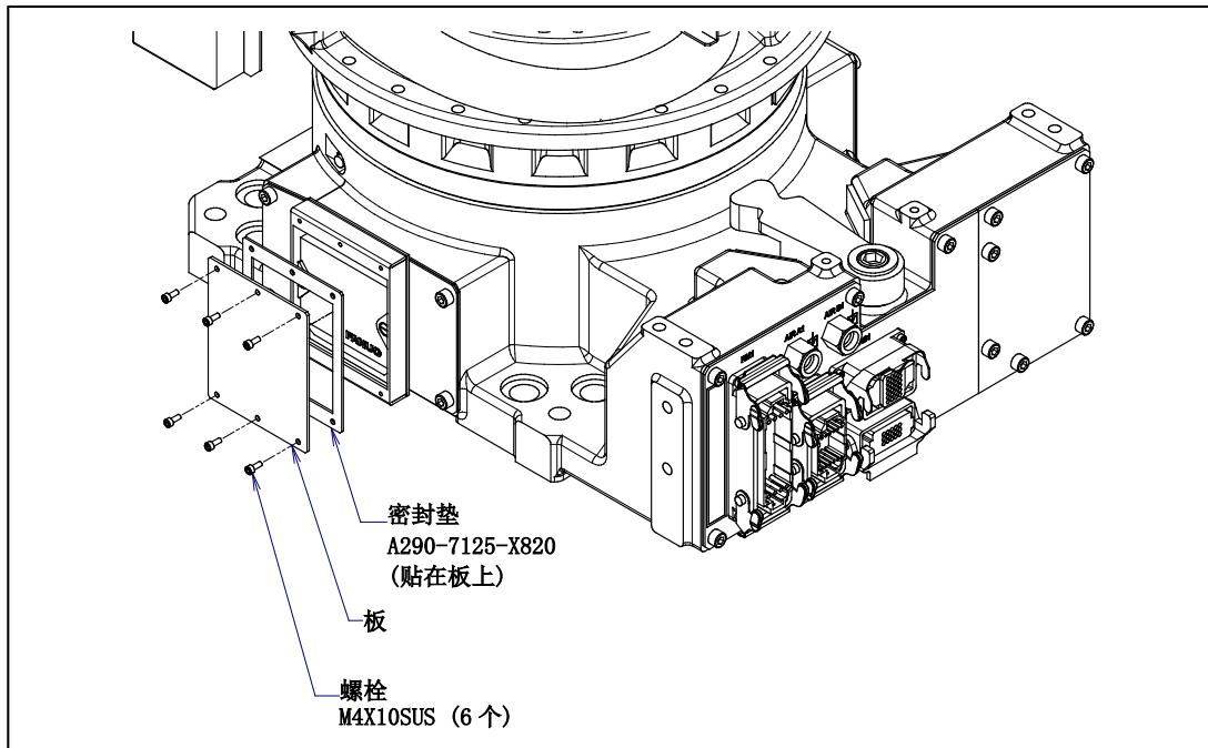
图 7.3.1 (b) 电池盖板的拆除 (指定防尘防液强化选项时)
