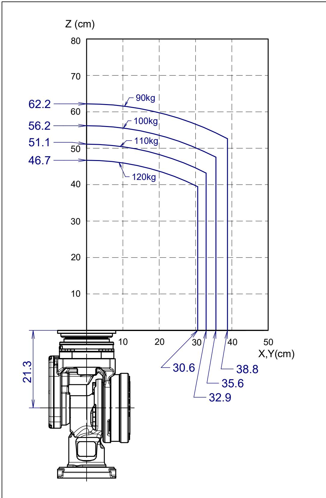
图 3.4 (h) 手腕部允许负载线图 (绝缘 ISO 法兰盘)
