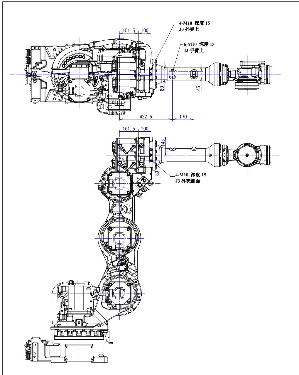
图 4.2 (b) 设备安装面尺寸 (R-1000iA/120F-7B)
