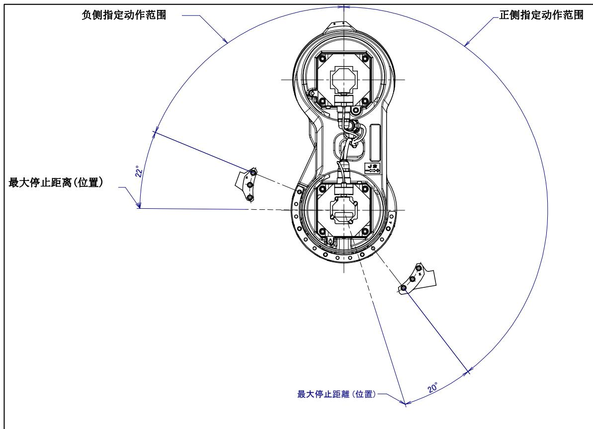
图 6.2.3 (c) J2 轴机械式可变制动器的最大停止距离 (位置)
