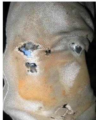
图 7.2.3 (b) 电缆保护套的损坏
