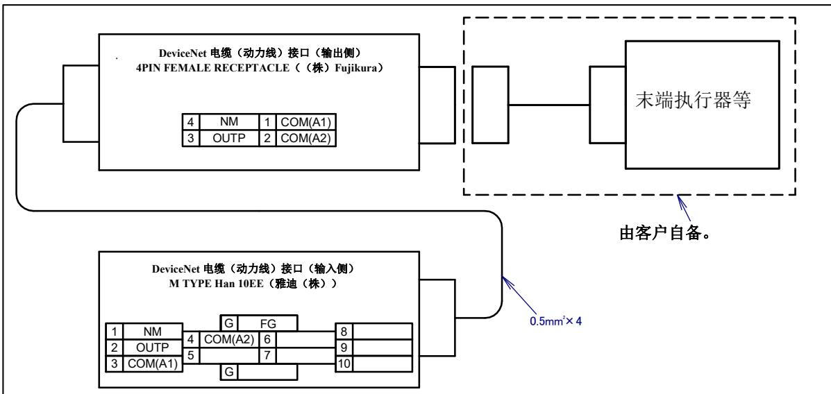
图 5.3 (l) DeviceNet 电缆（动力线）(DP) 接口的插针排列（可选购项）
