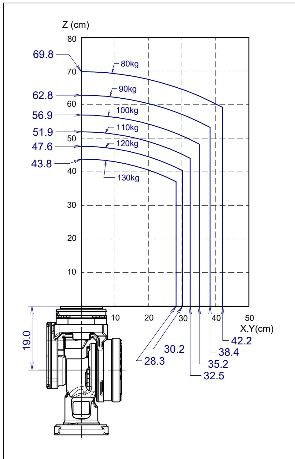
图 3.4 (e) 手腕部允许负载线图 (ISO 法兰盘)
