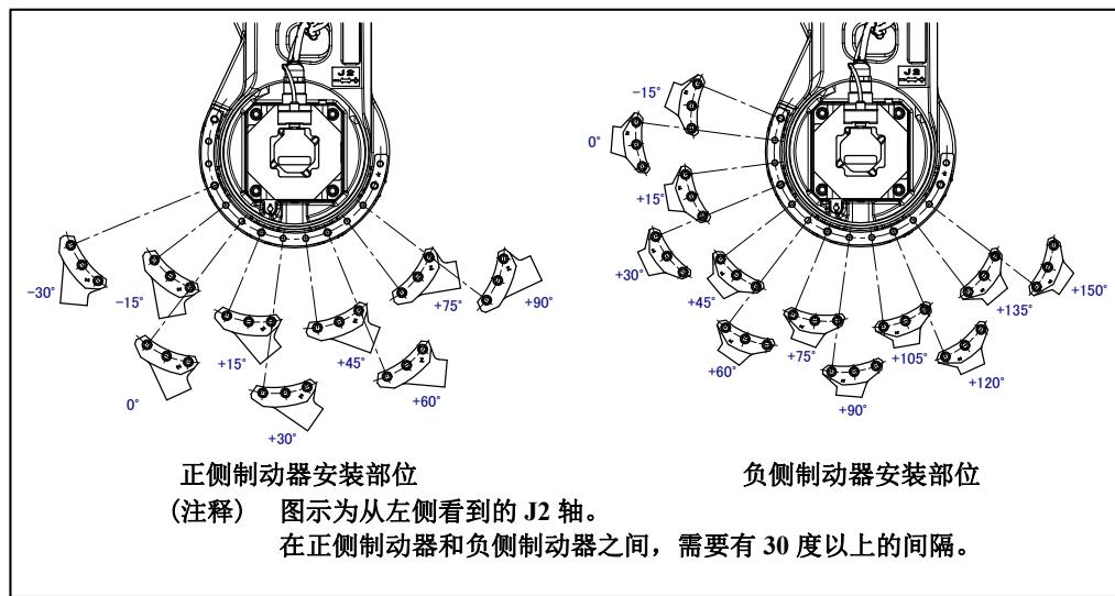
图 6.2.1 (e) J2 轴机械式制动器的安装 (可选购项)
