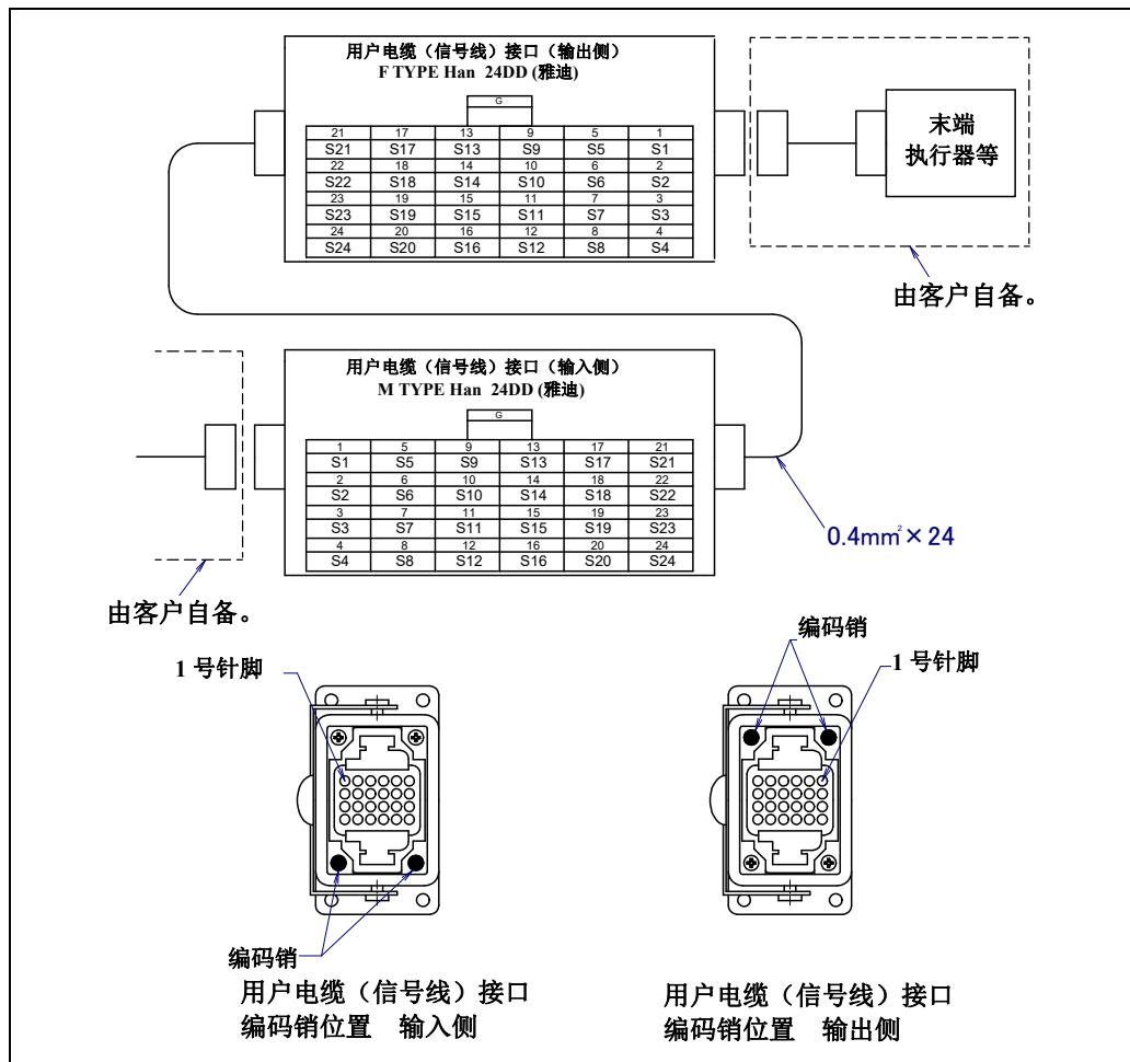
图 5.3 (h) 用户电缆（信号线）(AS)
