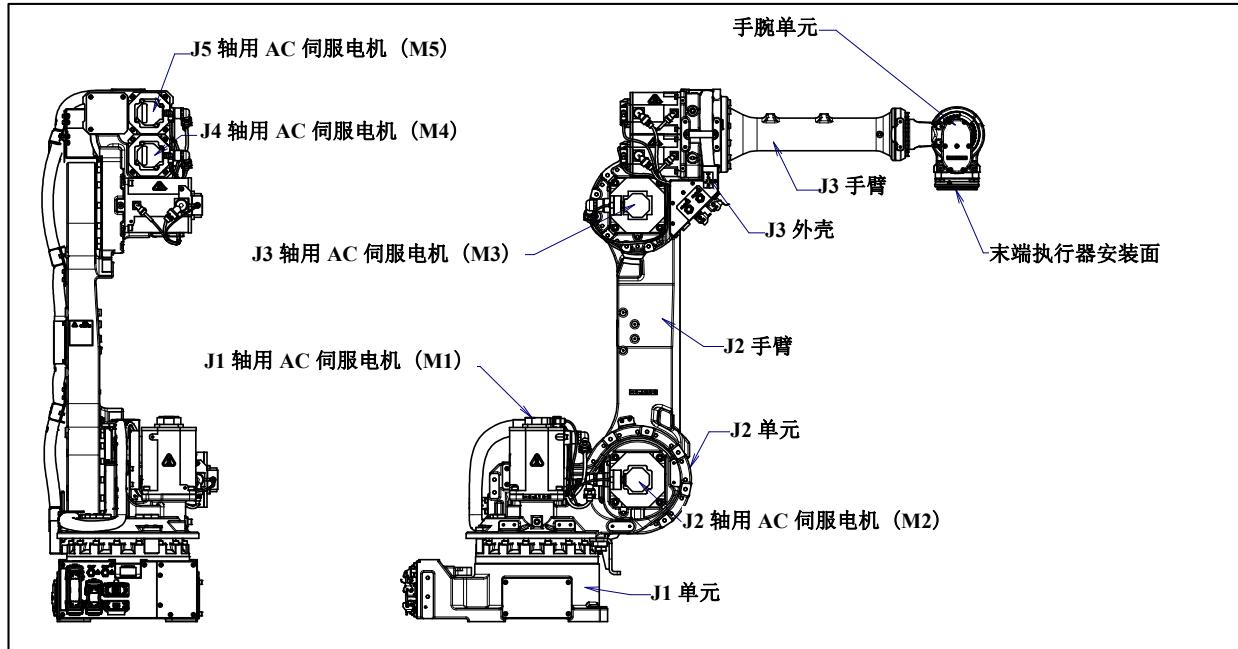
图 3.1 (c) 机构部的构成 (R-1000iA/80H)
