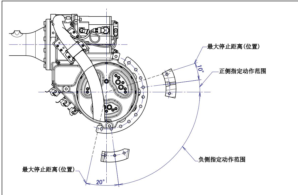
图 6.2.3 (d) J3 轴机械式可变制动器的最大停止距离 (位置)
