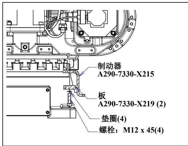
图 3.3 (b) J1 轴机械式制动器的更换
