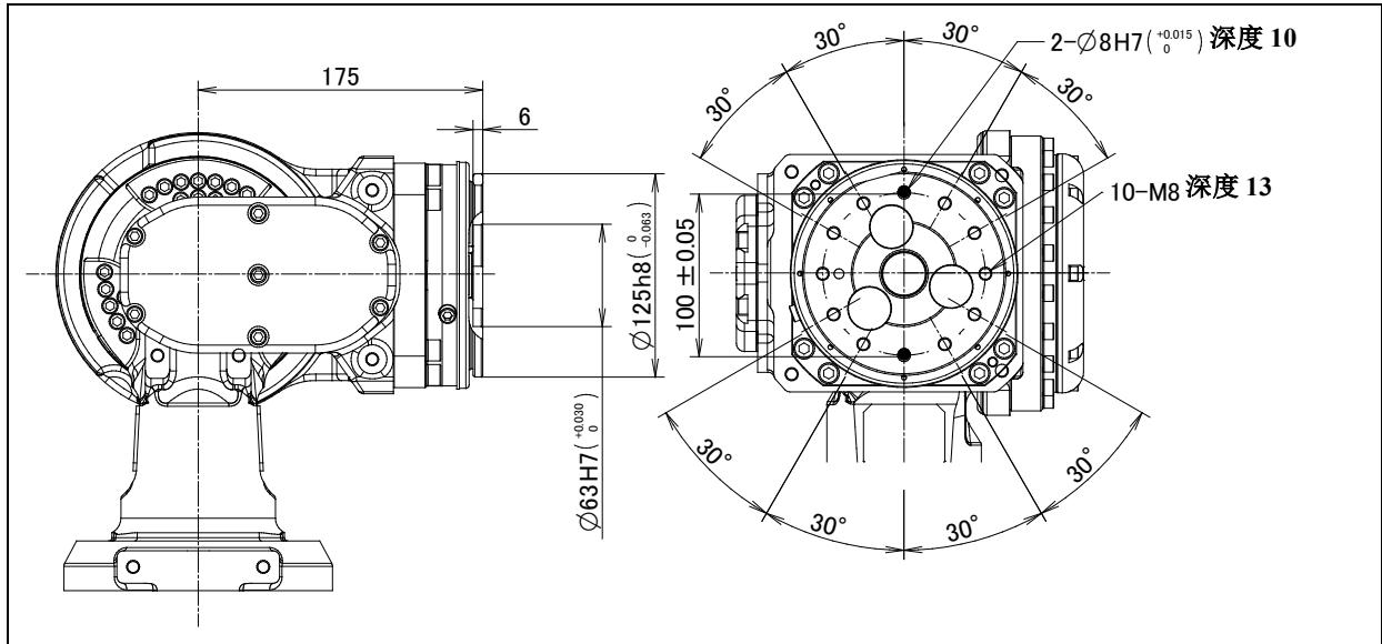
图 4.1 (c) 末端执行器接口尺寸 (R-1000iA/80H)
