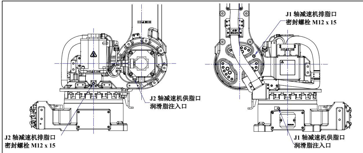
图 7.3.2 (a) J1/J2 轴减速机的润滑脂的更换
