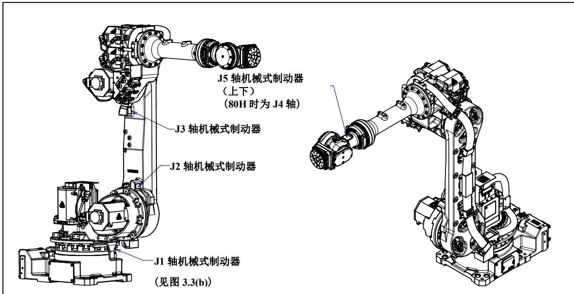
图 3.3 (a) 机械式制动器的位置
