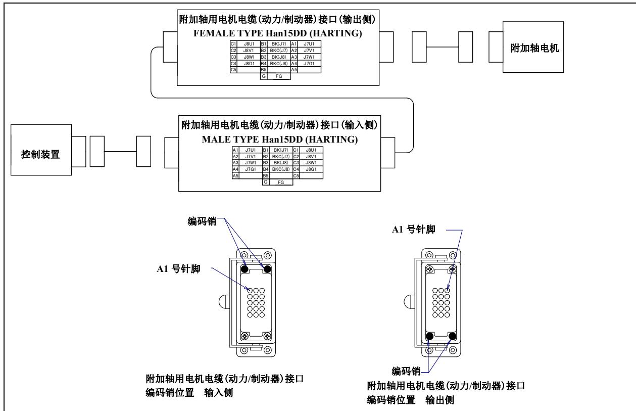
图 5.3 (n) 附加轴用电机电缆（动力线和制动器线）(ARM)接口的插针排列和编码销的位置（可选购项）
