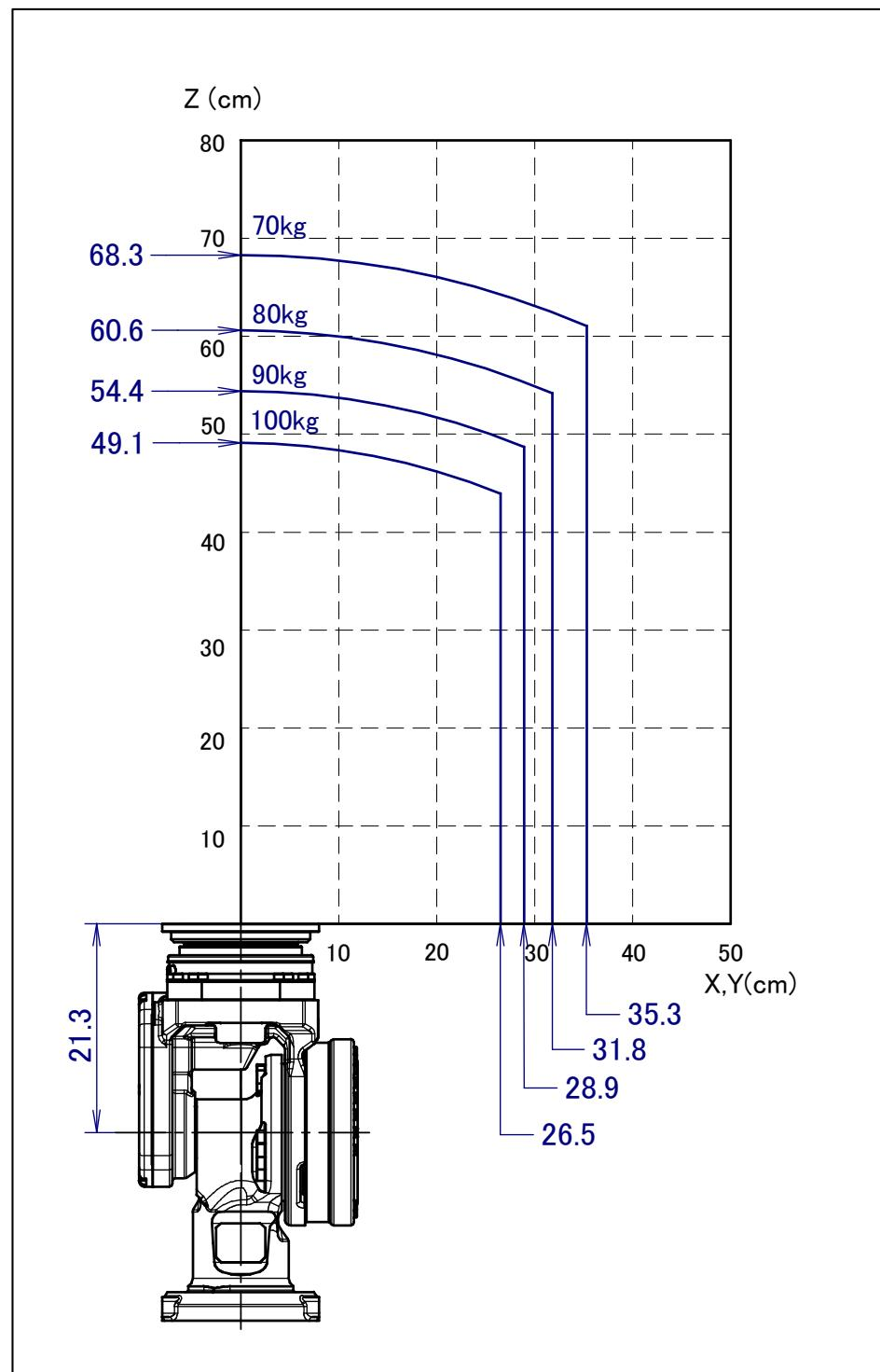
图 3.4 (d) 手腕部允许负载线图 (绝缘 ISO 法兰盘)
