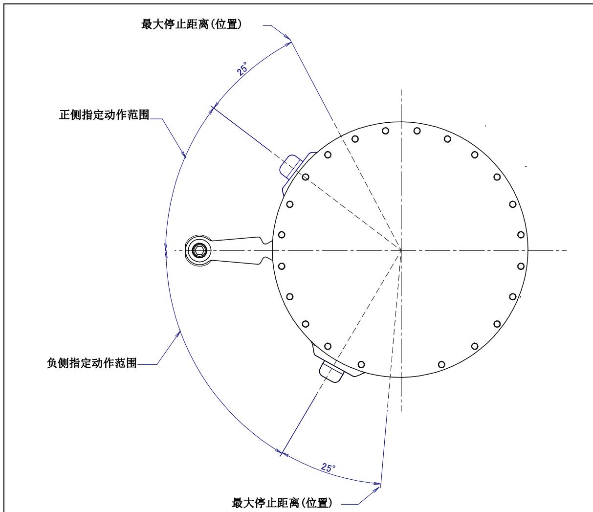
图 6.2.3 (a) J1 轴机械式可变制动器的最大停止距离 (位置)
