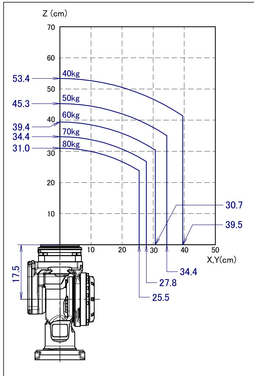
图 3.4 (a) 手腕部允许负载线图 (ISO 法兰盘)
