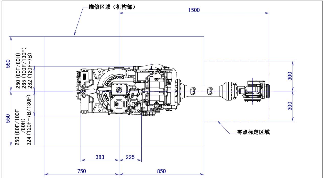
图 1.3 (a) 维修空间的布局图
