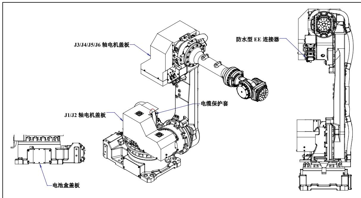
图 10.2 (a) 防尘防液强化组件的构成
