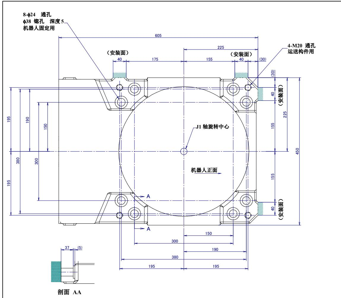
图 1.2 (a) 机器人机座尺寸
