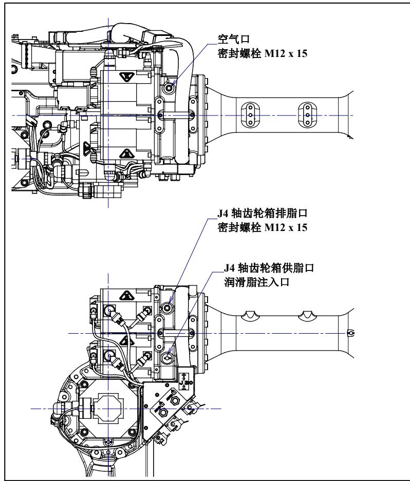
图 7.3.2 (c) J4 轴齿轮箱的润滑脂的更换
