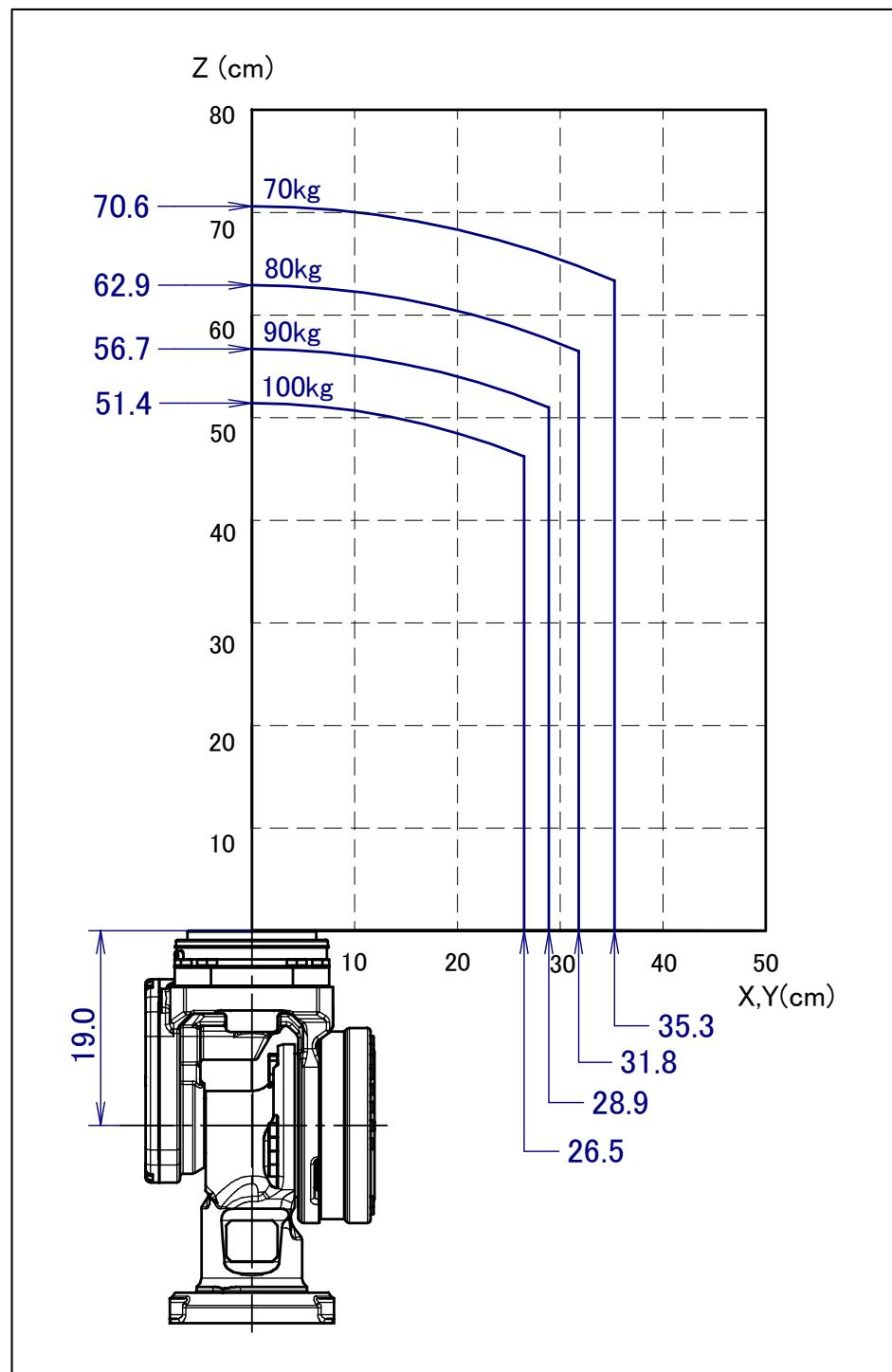
图 3.4 (c) 手腕部允许负载线图 (ISO 法兰盘)
