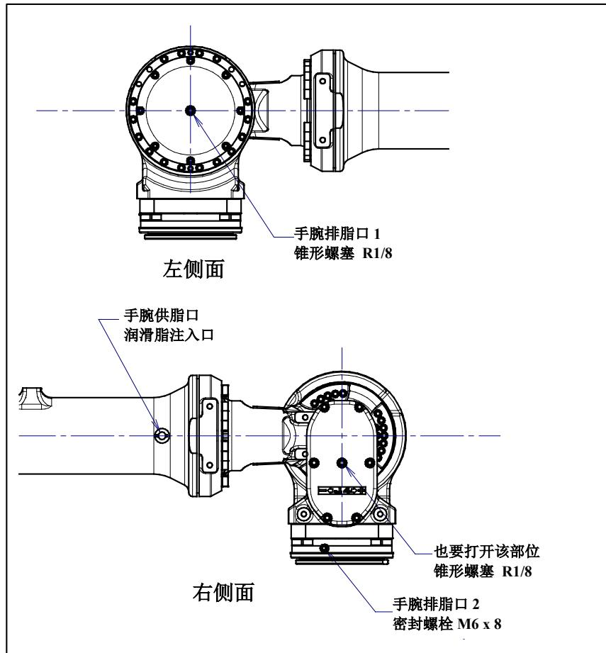
图 7.3.3 (b) 释放手腕残留压力时的开启部位 (R-1000iA/80H)
