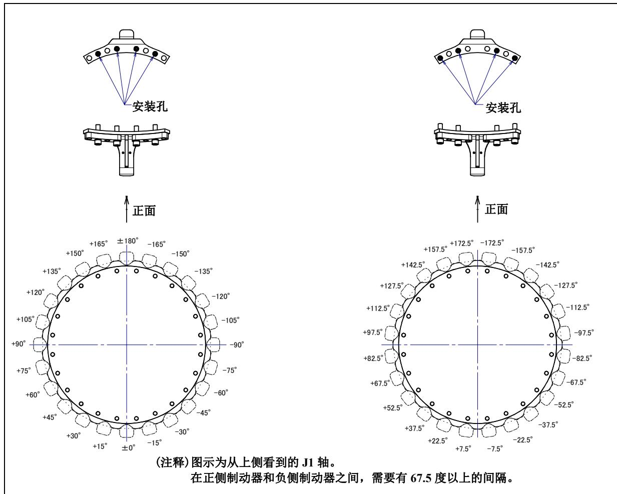
图 6.2.1 (a) J1 轴机械式制动器的安装 (可选购项)
