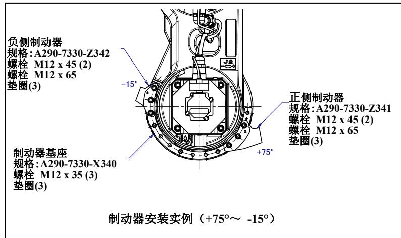
图 6.2.1 (i) J2 轴机械式可变制动器的安装事例
