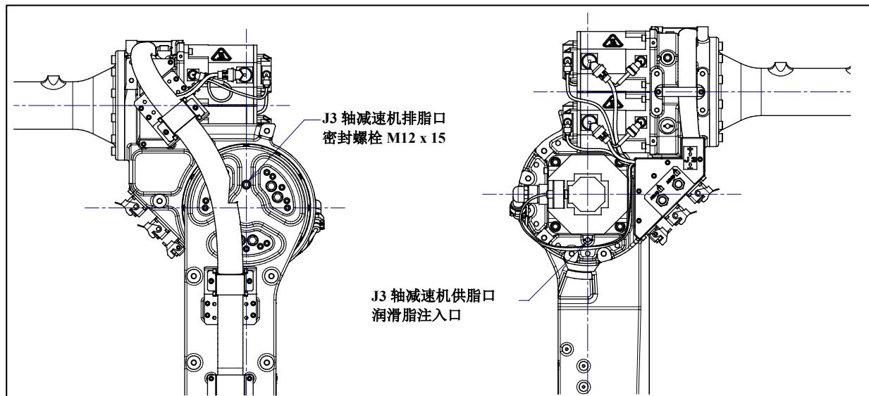
图 7.3.2 (b) J3 轴减速机的润滑脂的更换
