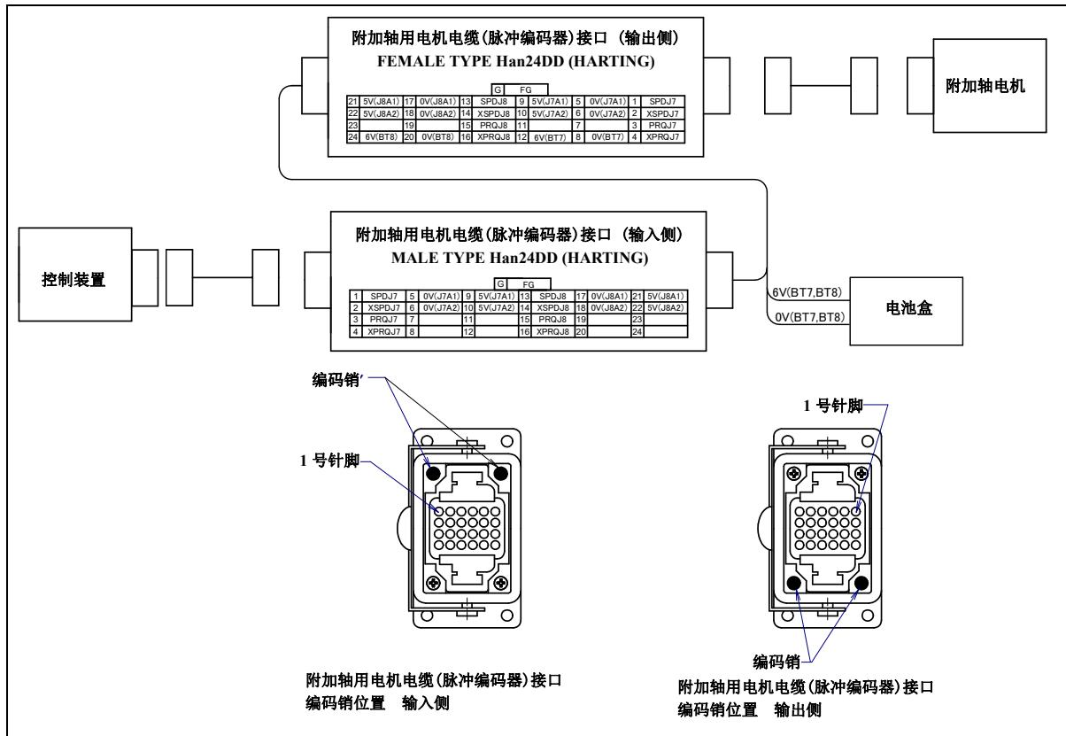
图 5.3 (m) 附加轴用电机电缆（脉冲编码器线）(ARP)接口的插针排列和编码销的位置（可选购项）
