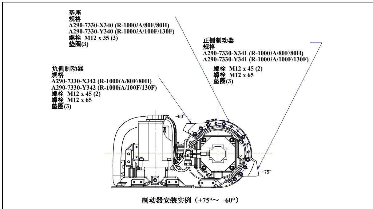
图 6.2.1 (h) J2 轴机械式可变制动器的安装事例
