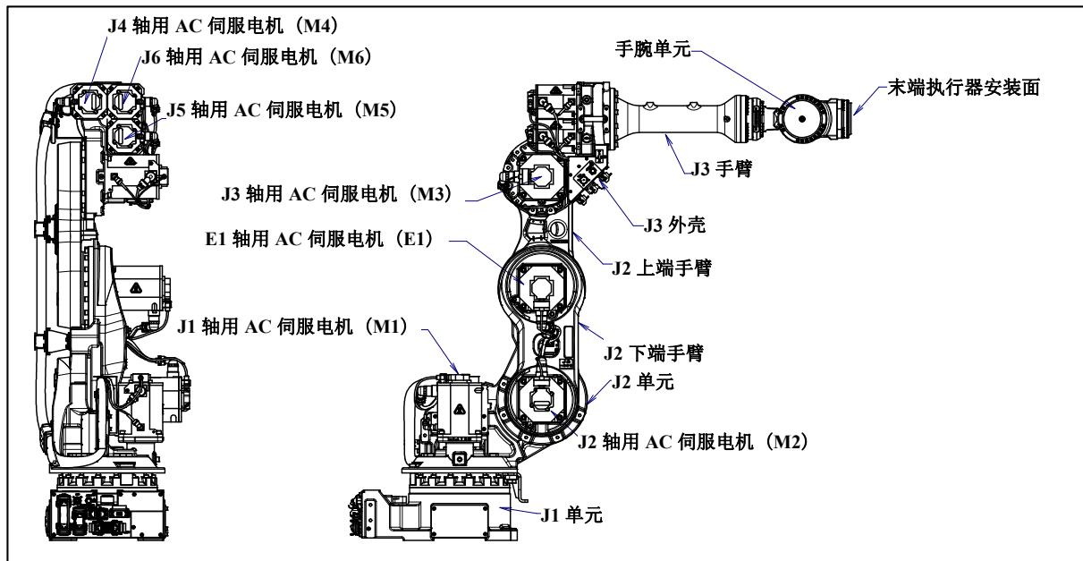
图 3.1 (b) 机构部的构成 (R-1000iA/120F-7B)
