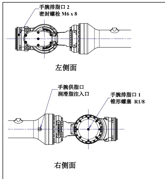
图 7.3.2 (e) 手腕的润滑脂的更换 (R-1000iA/80F/100F/130F/120F-7B)
