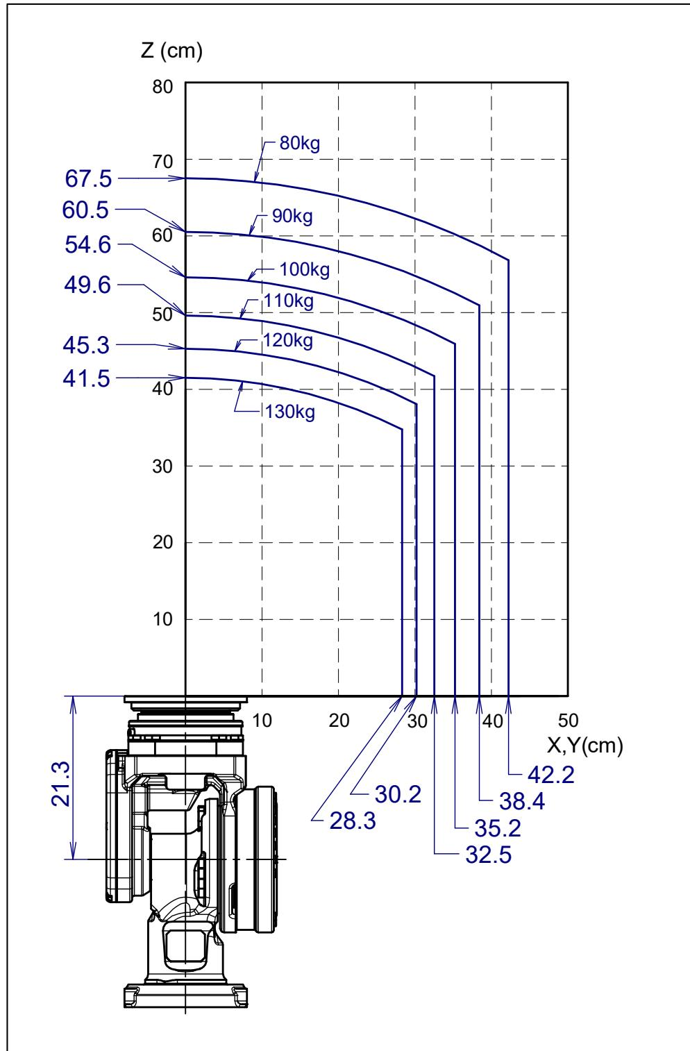
图 3.4 (f) 手腕部允许负载线图 (绝缘 ISO 法兰盘)
