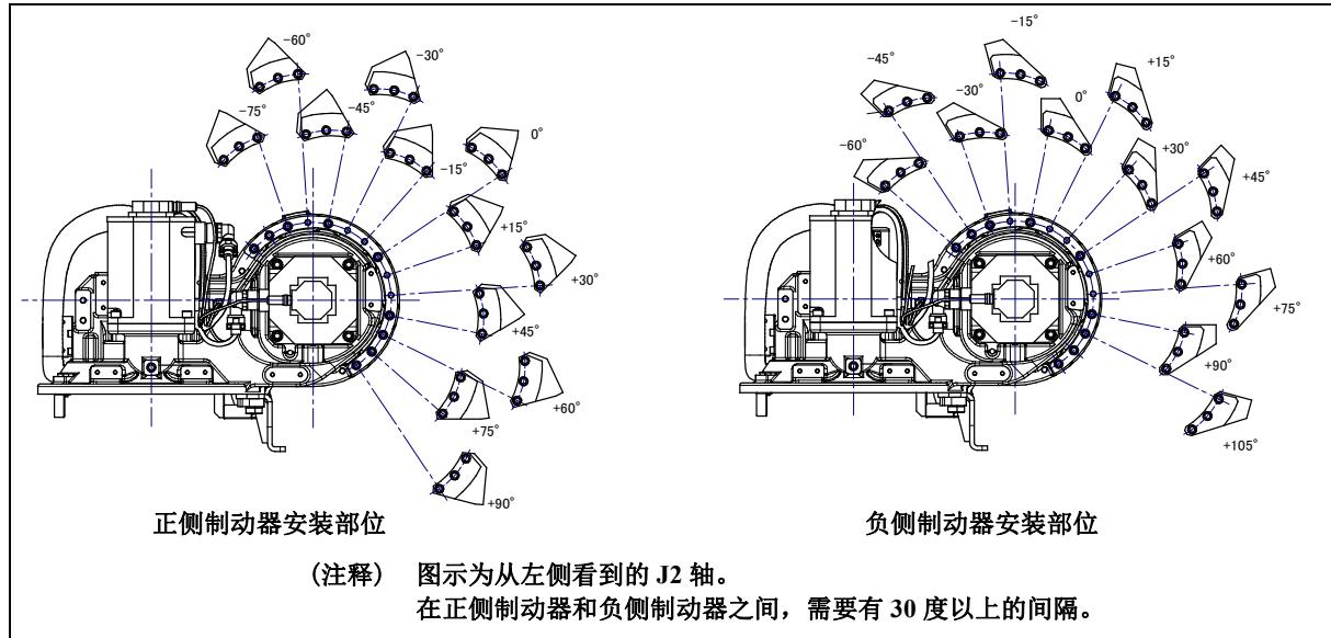
图 6.2.1 (d) J2 轴机械式制动器的安装 (可选购项)
