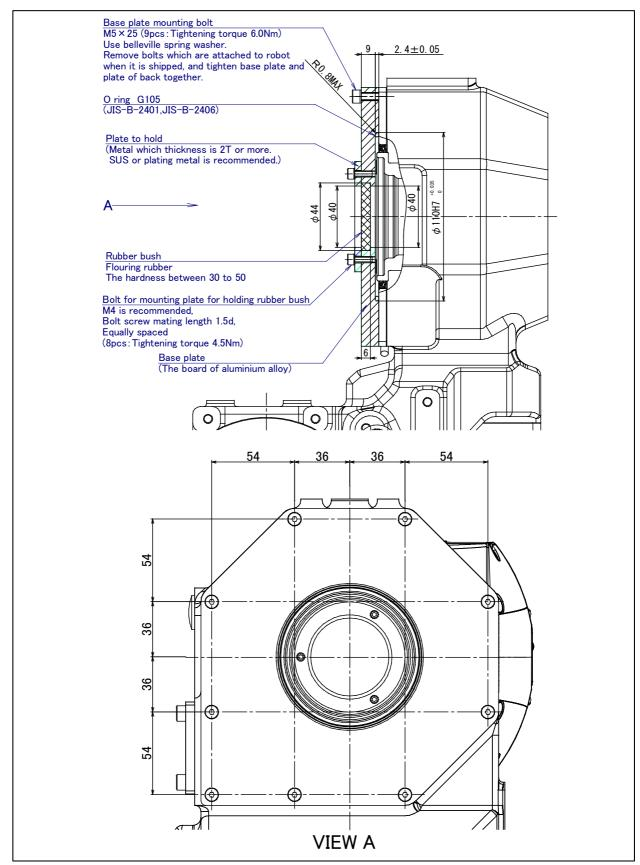
Fig.12 (d) Structure of seal of back of J3 casing
