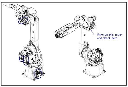
Fig. 8.2.3 (d) Connector Inspection points
