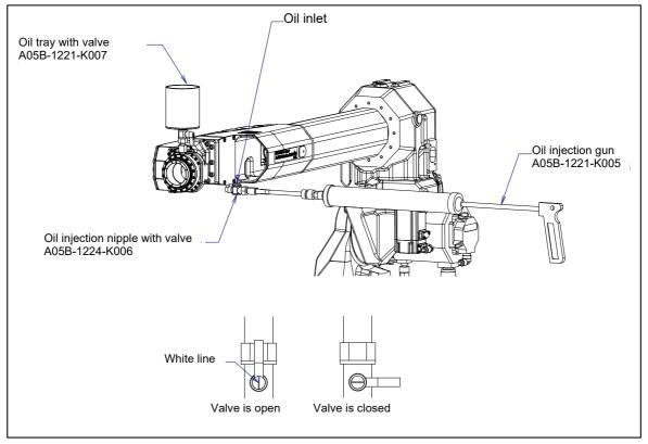
Fig. 7.3.2.5 (d) Oil injection with an oil gun (ARC Mate 120iC/12L, M-20iA/12L)
