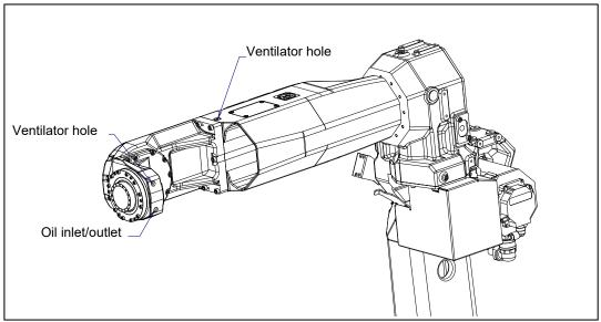
Fig. 7.3.2.4 (d) Oil inlet/outlet and ventilator hole ARC Mate 120*i*C, M-20*i*A) (A05B-1225-B251, B252)
