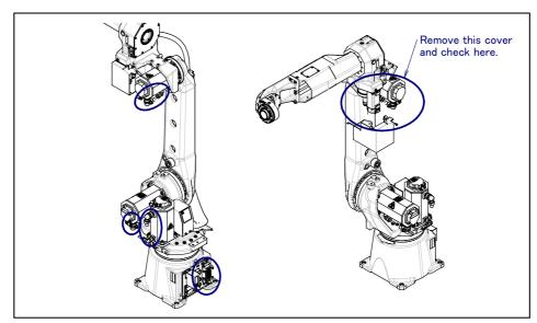
Fig. 7.2.5 (d) Connector Inspection points
