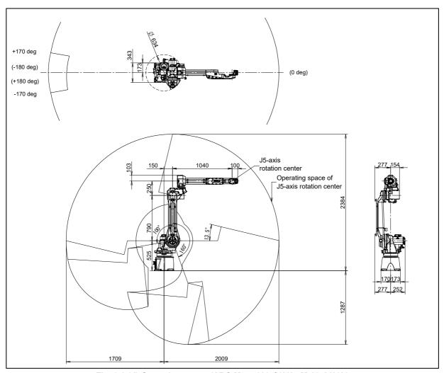
Fig. 3.2 (d) Operating space (ARC Mate 120iC/12L, M-20iA/12L)
