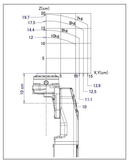
Fig. 3.5 (d) Wrist load diagram (ARC Mate 120*i*C/10L, M-20*i*A/10L 10kg wrist payload specification)
