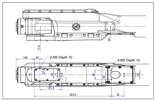
Fig. 4.2 (d) Equipment mounting faces (for the cable clamp) (M-20iA/20M/35M)
