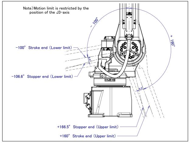
Fig. 3.3 (d) J2-axis motion limit
