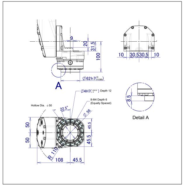
Fig. 4.1 (d) End effector interface (ARC Mate 120*i*C/10L/12L, M-20*i*A/10L/12L)
