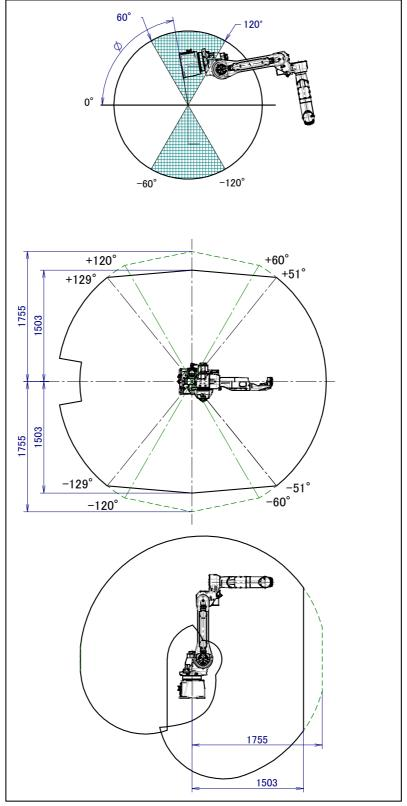
Fig. 3.6 (d) Installation area (3) operating space (ARC Mate 120iC, M-20iA) (- $120^{\circ}$ < $60^{\circ}$ < $60^{\circ}$ < $60^{\circ}$ < $60^{\circ}$
