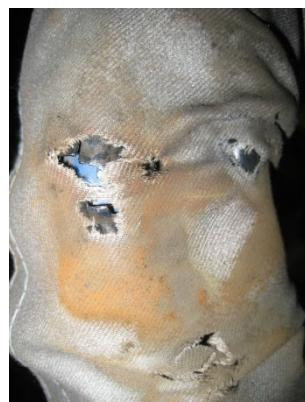
图 7.2.5 (b) 电缆保护套的损坏
