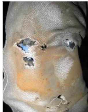
图 8.2.3 (b) 电缆保护套的损坏
