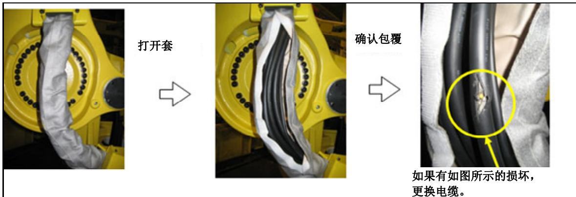
图 7.2.5 (c) 电缆的确认方法
